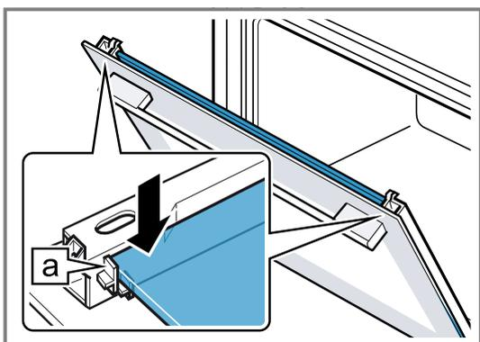
5. Die Gerätetür öffnen und Türdichtung einhängen.
