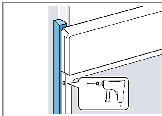
4. Das Gerät mit adäquater Schraube befestigen.
