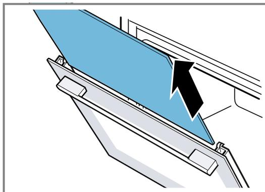
9. Bei Bedarf können Sie die Kondensatleiste zum Reinigen herausnehmen.
