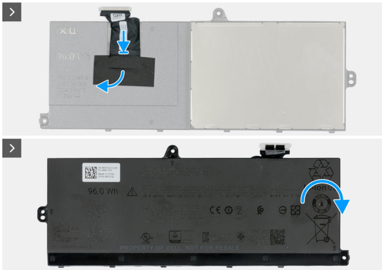
Abbildung 46. Austauschen des Akkukabels
