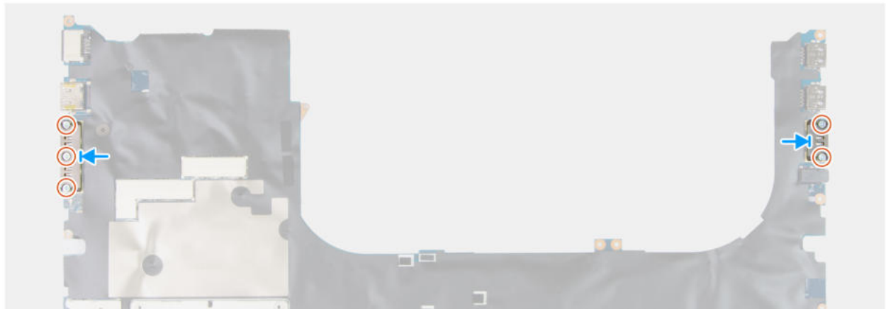
Abbildung 116. Installieren des USB-Typ-C-Anschlussmoduls
