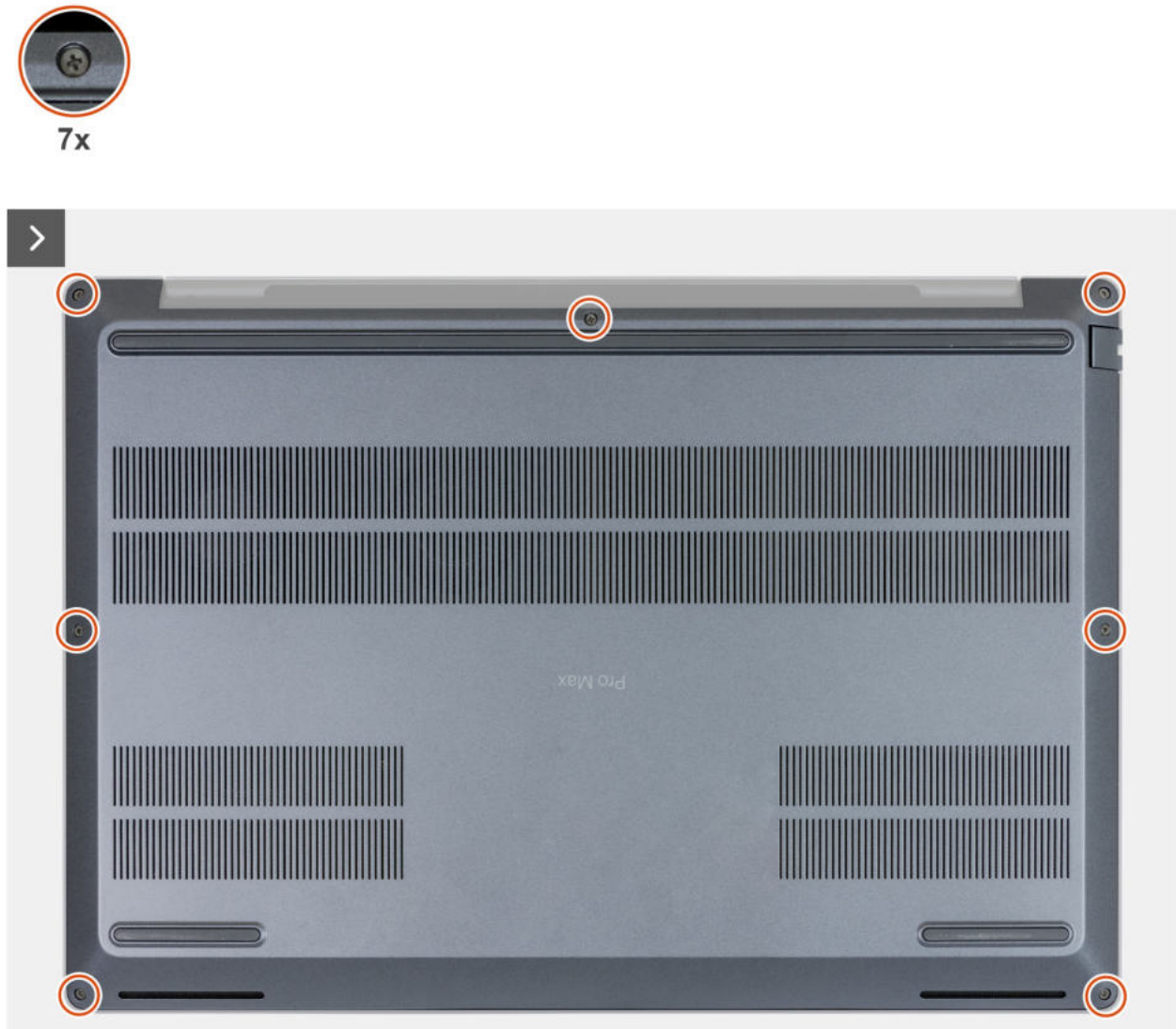
Abbildung 24. Lösen der unverlierbaren Schrauben
