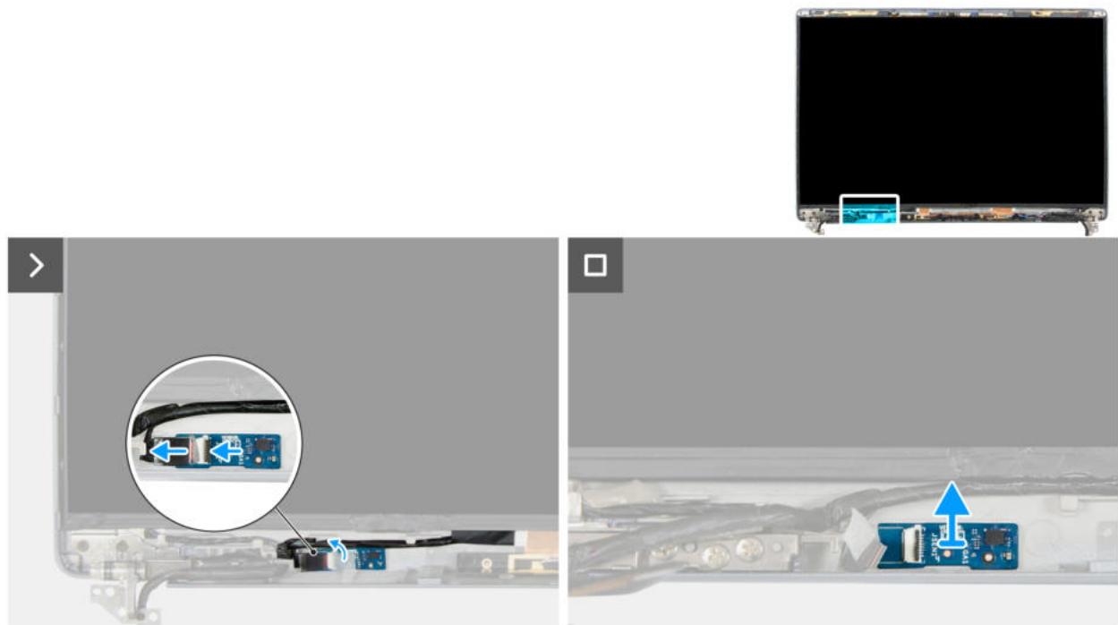
Abbildung 101. Entfernen der Sensorplatine
