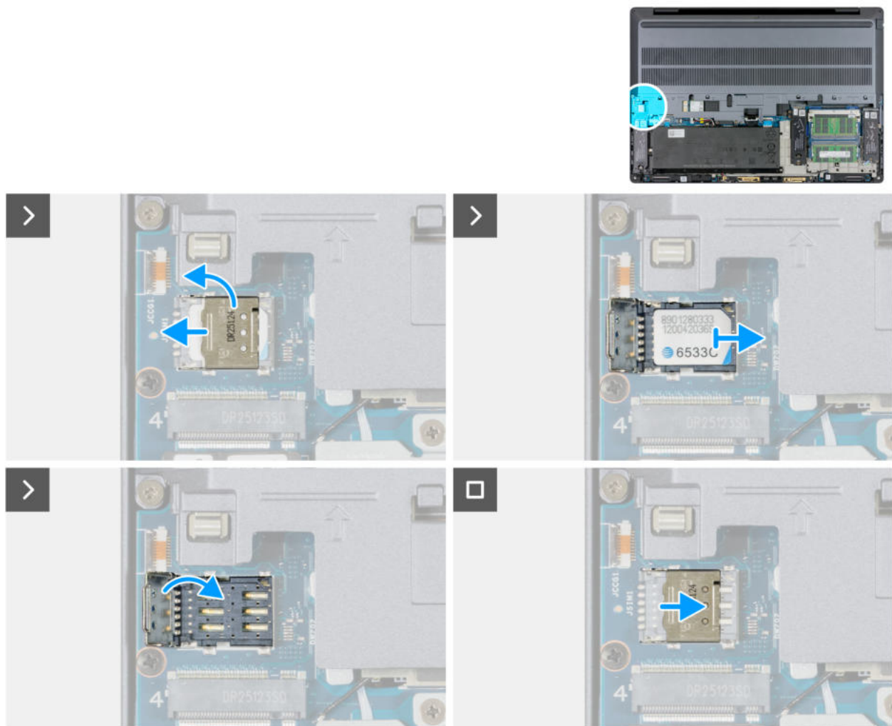
Abbildung 50. Entfernen der SIM-Karte
