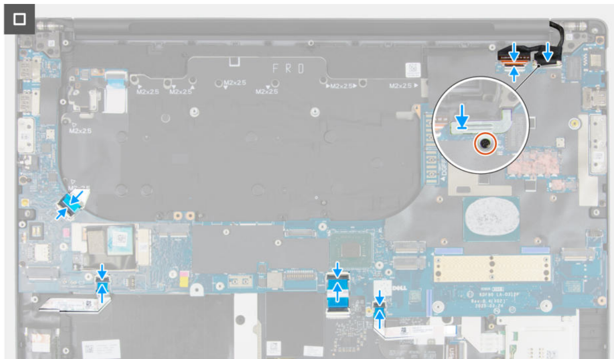
Abbildung 114. Einbauen der Systemplatine
