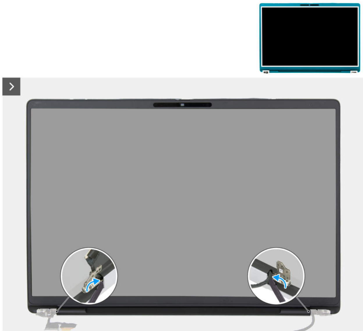
Abbildung 83. Entfernen der Bildschirmblende
