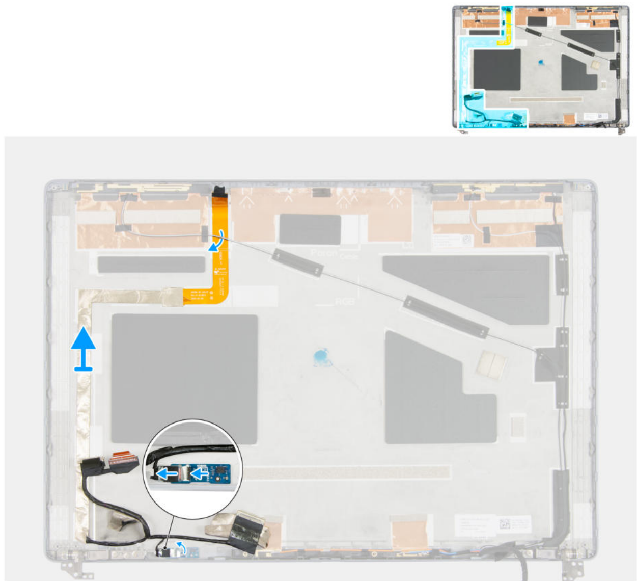
Abbildung 104. Entfernen des Bildschirmkabels
