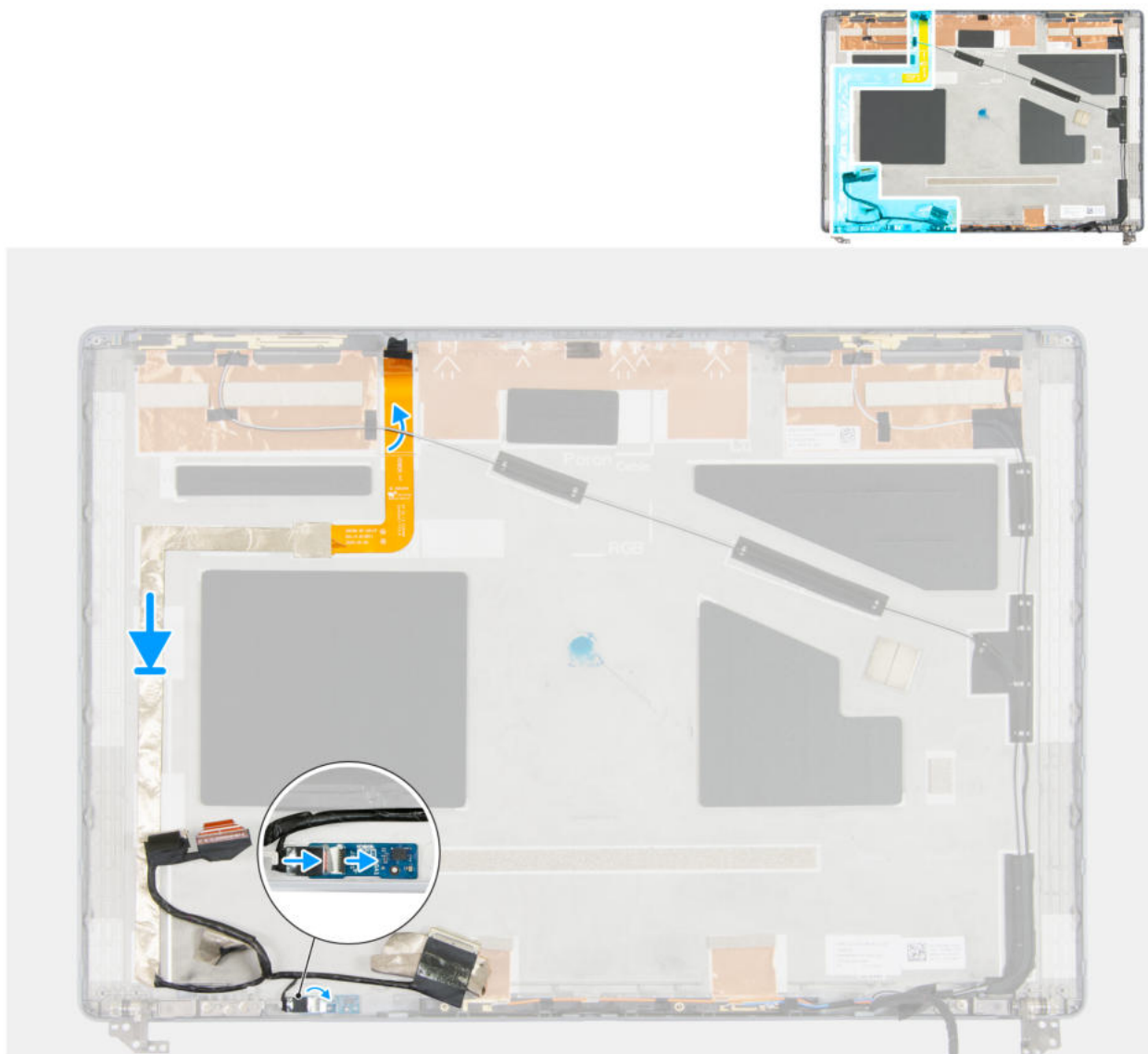
Abbildung 105. Einbauen des Bildschirmkabels
