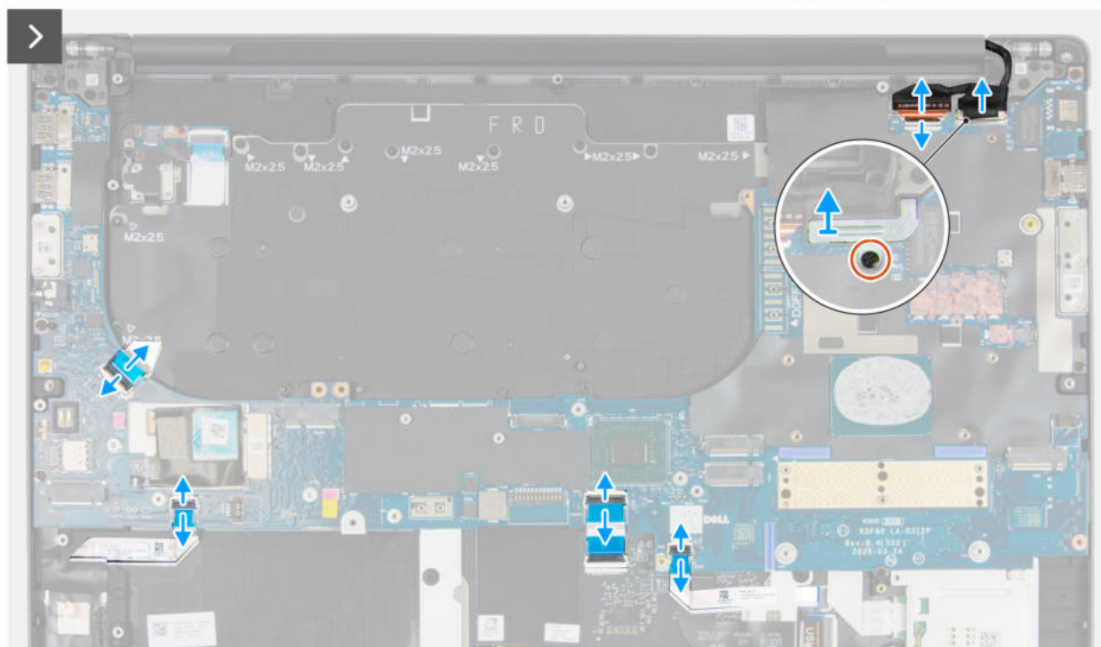
Abbildung 109. Entfernen der Systemplatine
