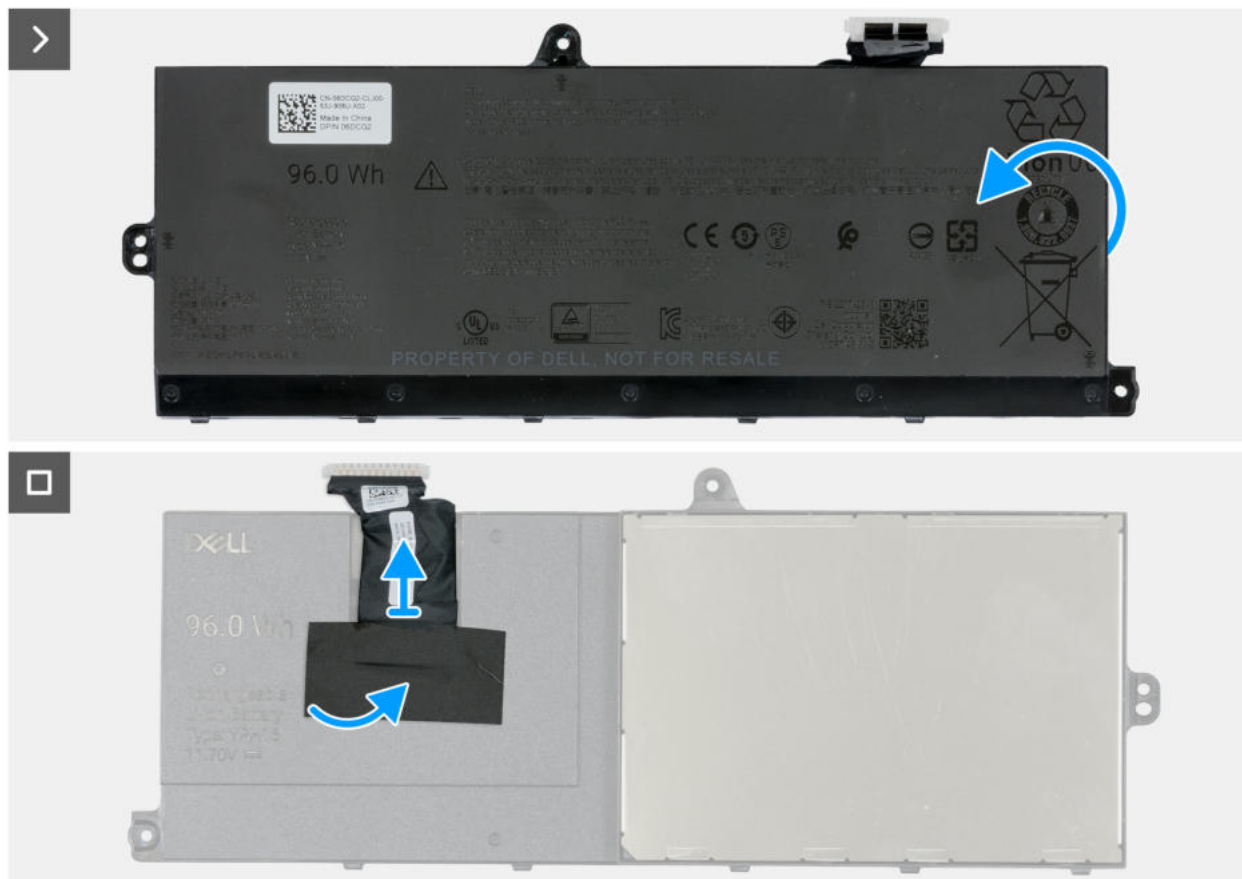
Abbildung 45. Entfernen des Akkukabels vom Akku
