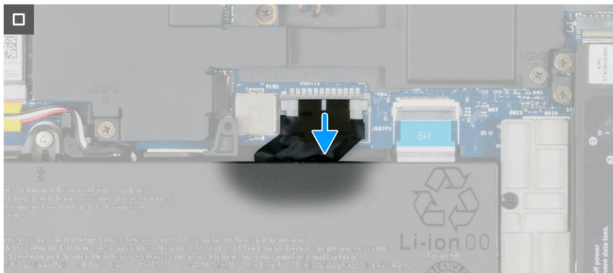
Abbildung 26. Trennen des Akkukabels
