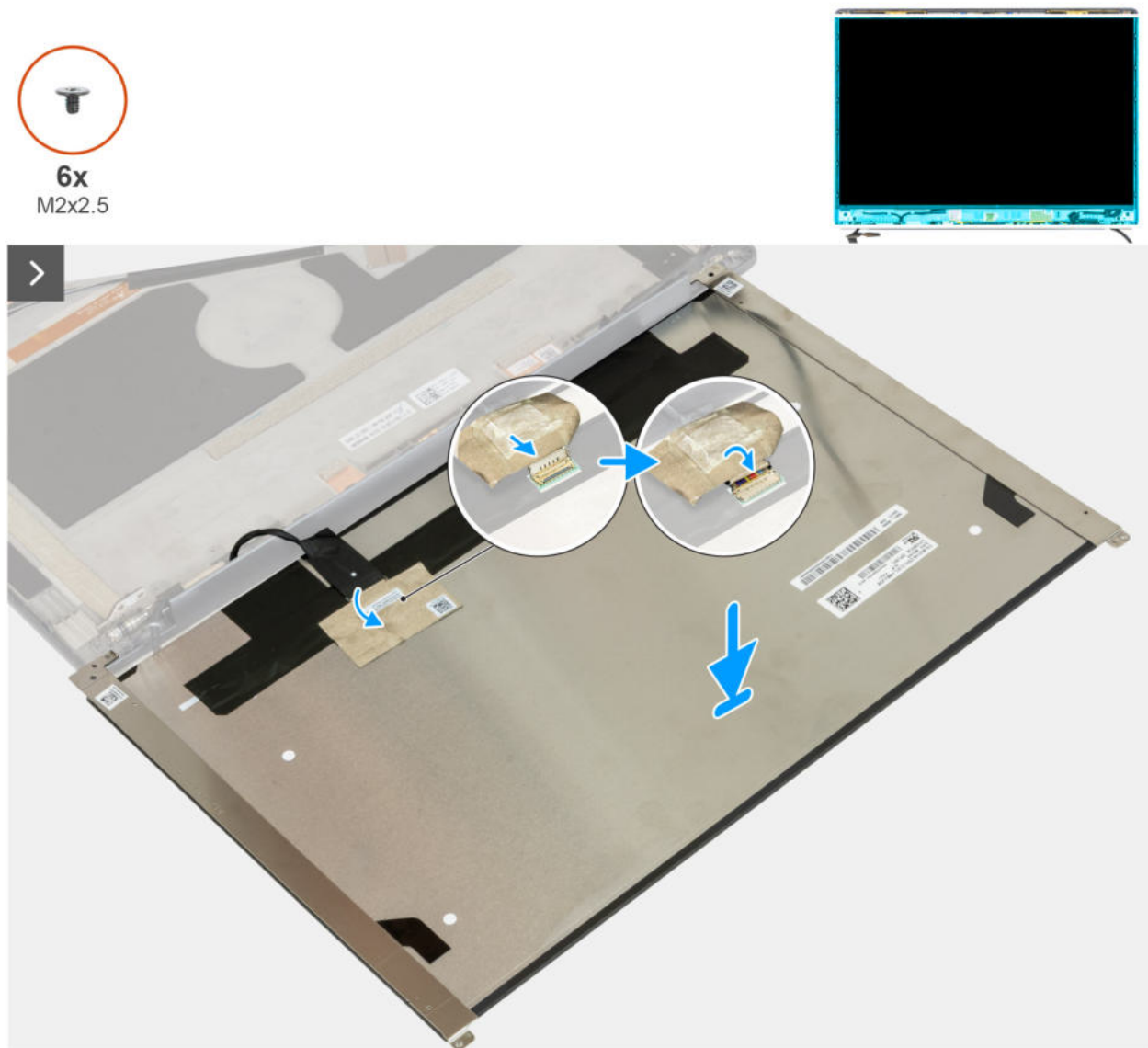
Abbildung 93. Einbauen des Bildschirms für Touchscreen-Displays
