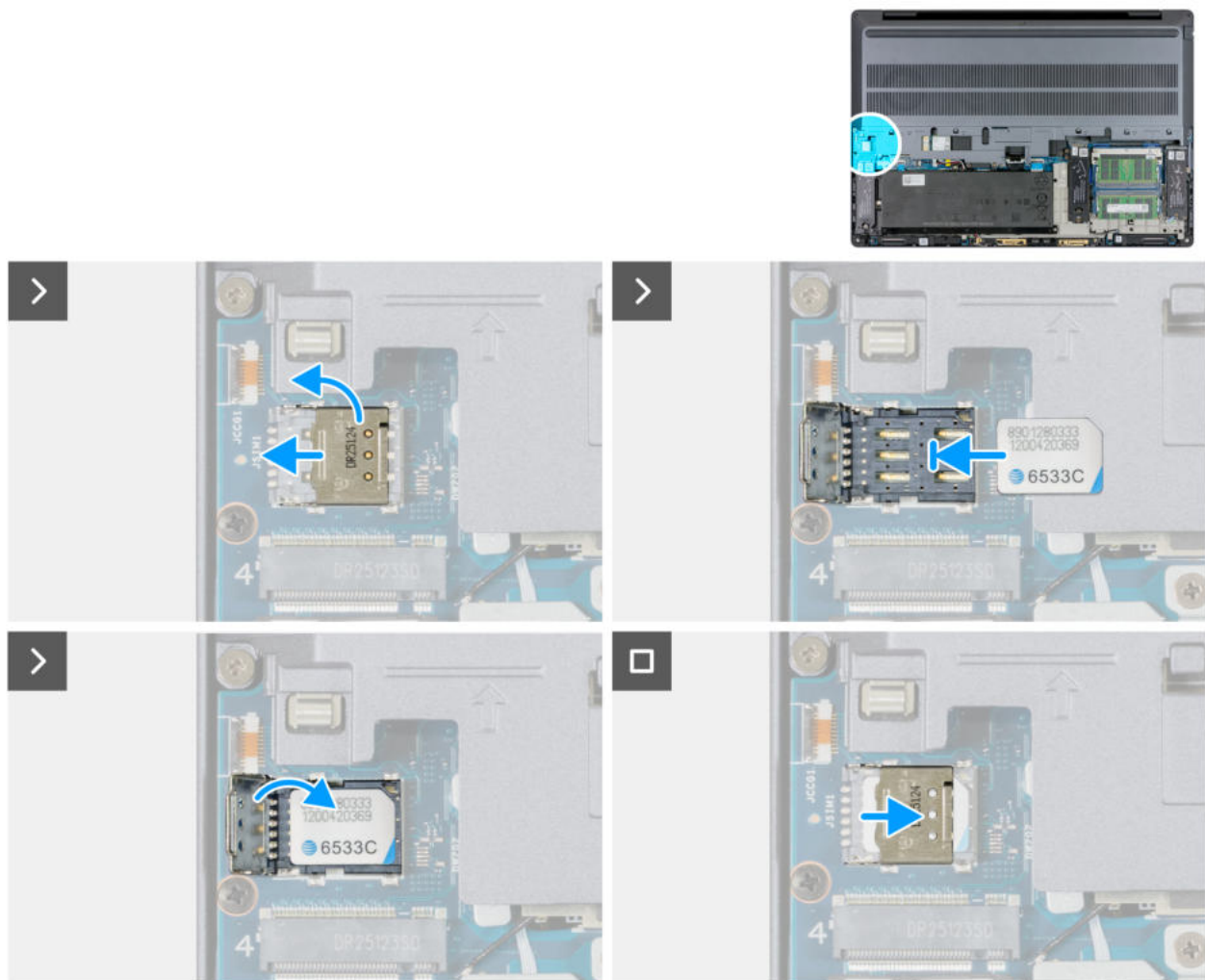
Abbildung 51. Einbauen der SIM-Karte
