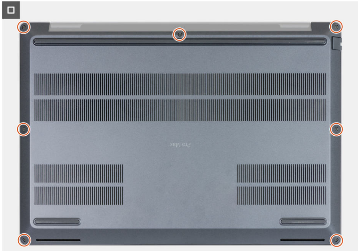
Abbildung 29. Festziehen der unverlierbaren Schrauben
