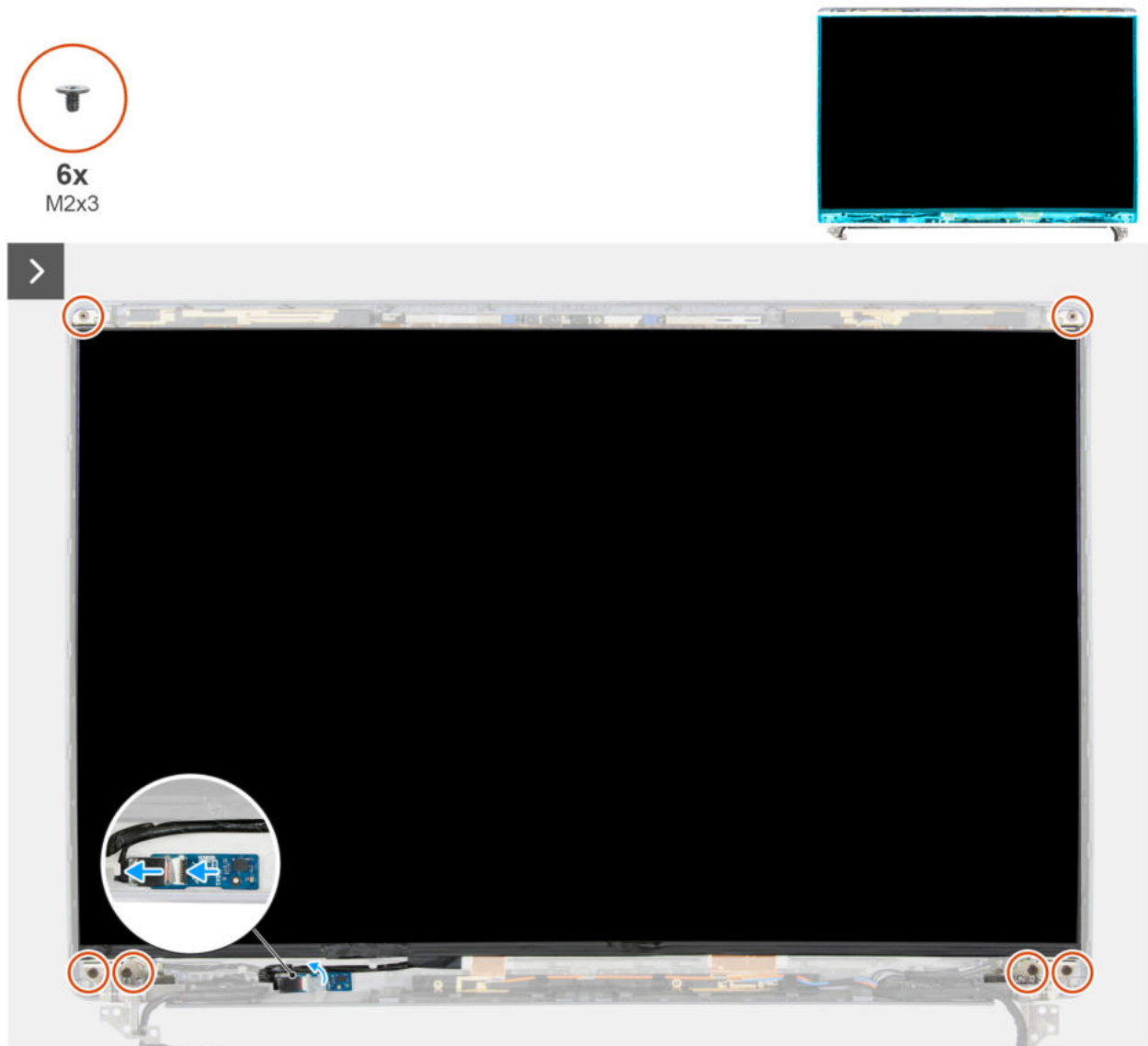
Abbildung 95. Entfernen des Bildschirms
