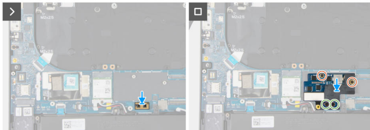
Abbildung 72. Einbauen der Netzteilplatine
