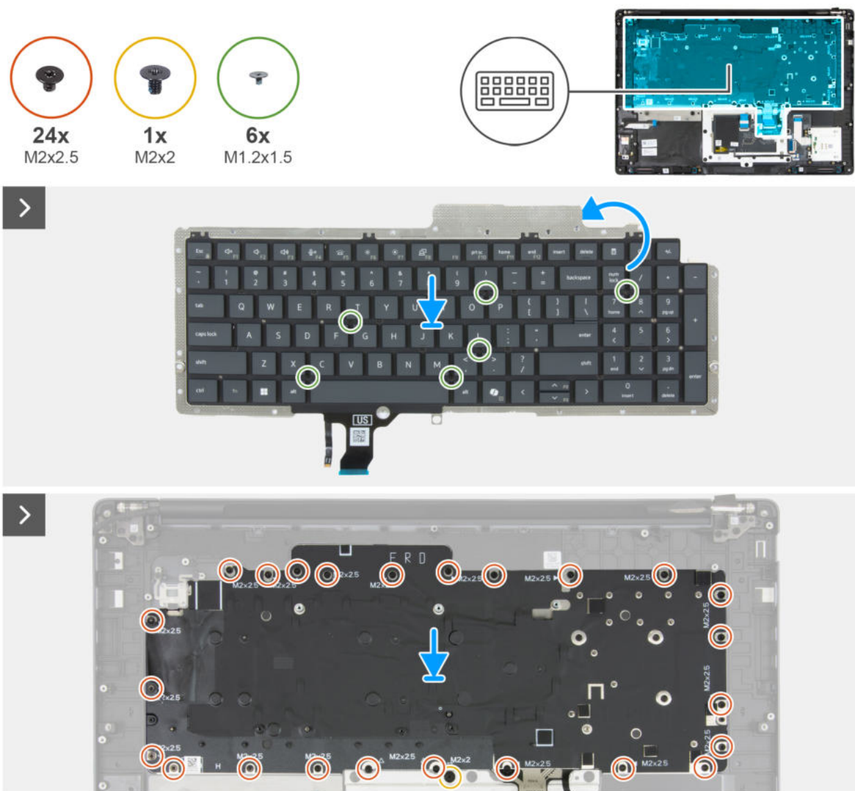
Abbildung 121. Einbauen der Tastatur
