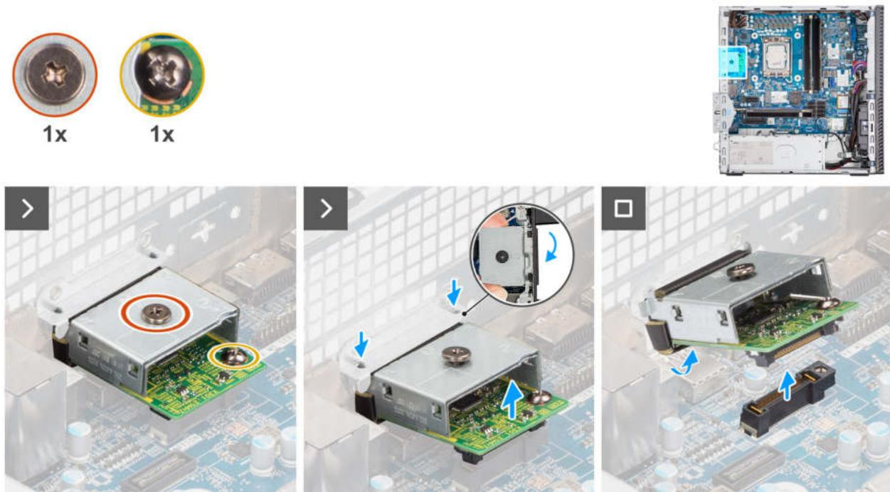
**Abbildung 76. Entfernen des optionalen DisplayPort-Moduls**
