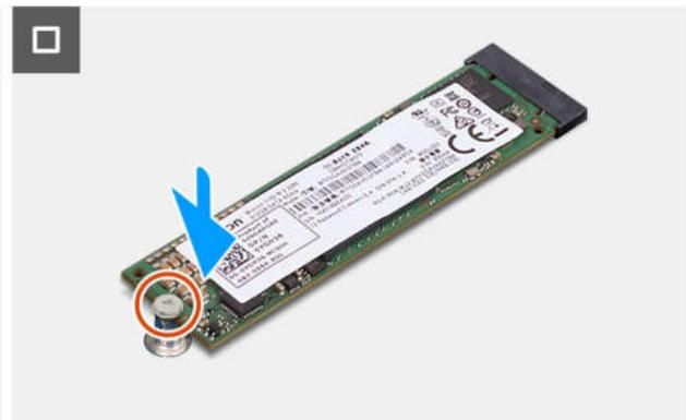
Abbildung 36. Einbauen des M.2-2280-Solid-State-Laufwerks
