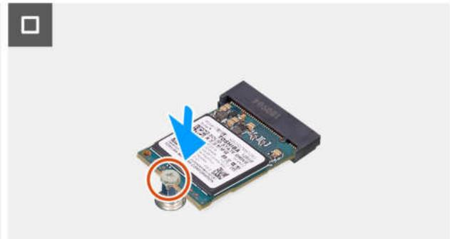
Abbildung 34. Installieren des M.2 2230-Solid-State-Laufwerks in Steckplatz 1
