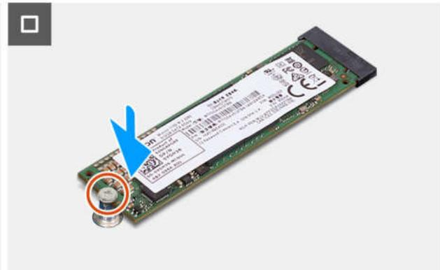
Abbildung 38. Einbauen des M.2-2280-Solid-State-Laufwerks
