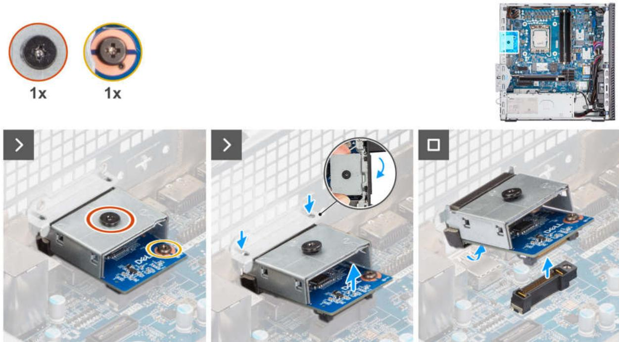
Abbildung 73. Entfernen des optionalen HDMI-Moduls
