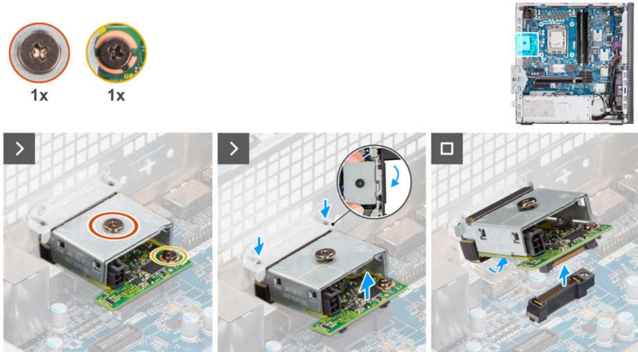
Abbildung 67. Entfernen des optionalen Thunderbolt-Moduls
