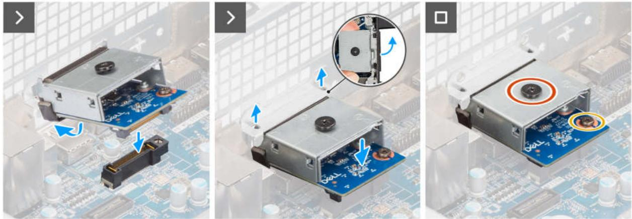
Abbildung 63. Installieren des optionalen VGA-Moduls
