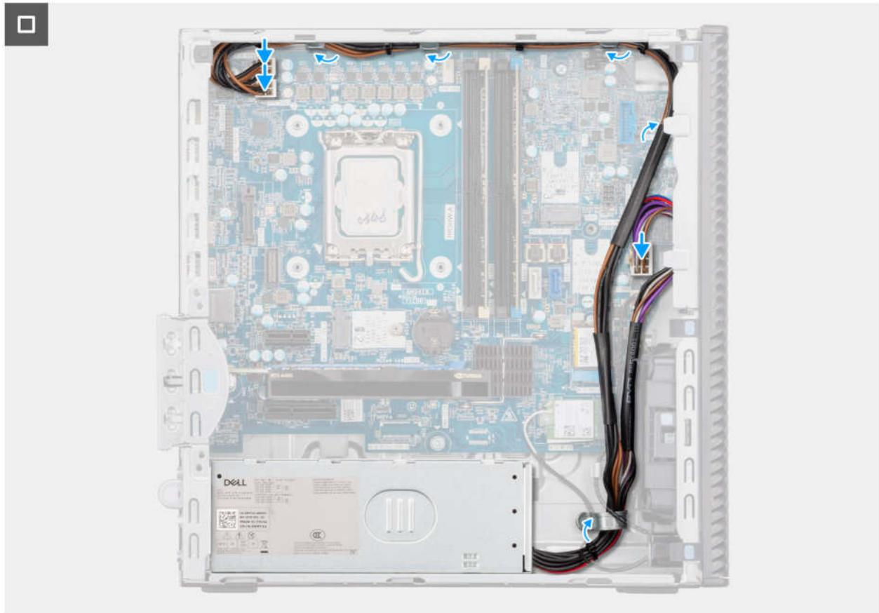
**Abbildung 60. Installieren der Stromversorgungseinheit**
