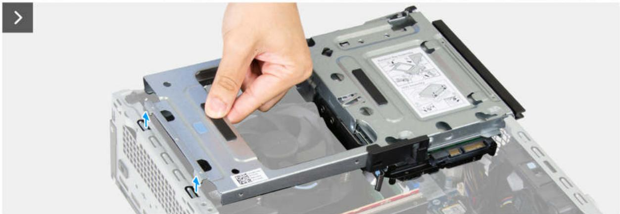
Abbildung 21. Entfernen des Laufwerksschachts
