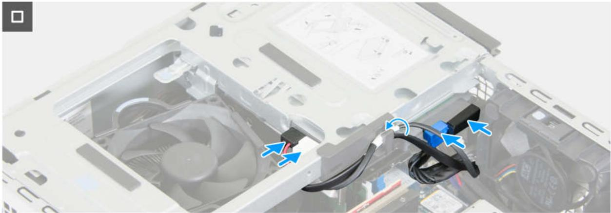
**Abbildung 24. Installieren des Laufwerksschachts**
