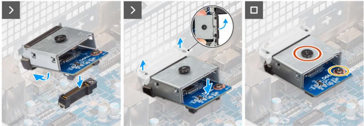
Abbildung 75. Installieren des optionalen HDMI-Moduls
