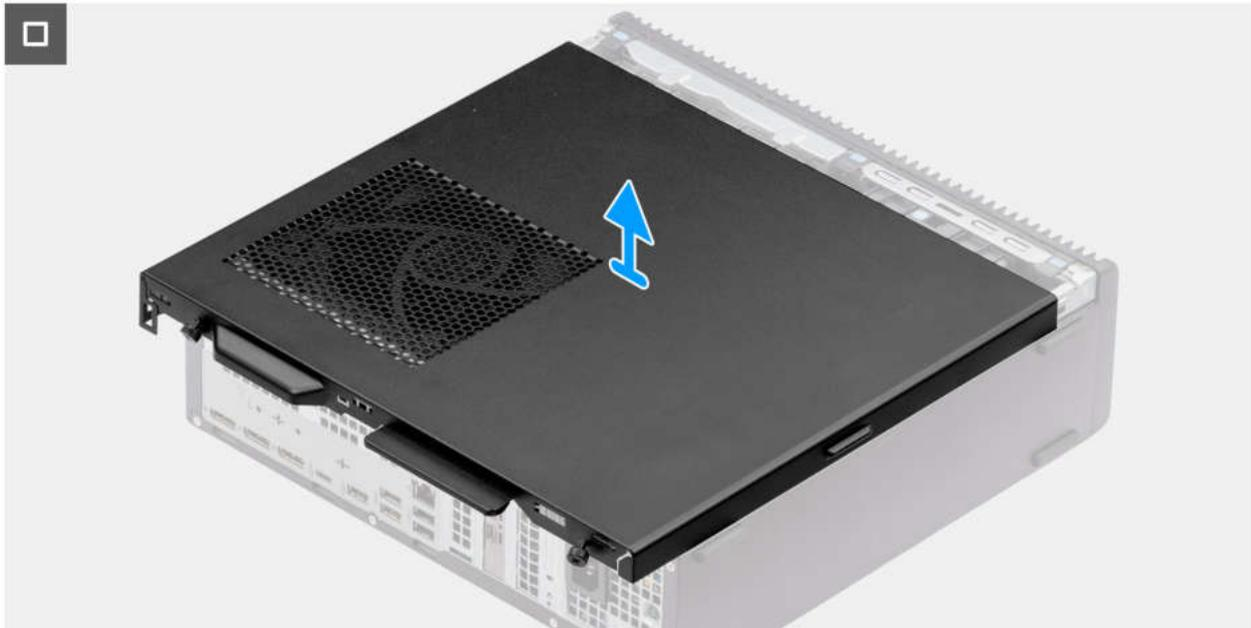
**Abbildung 10. Entfernen der Seitenabdeckung**
