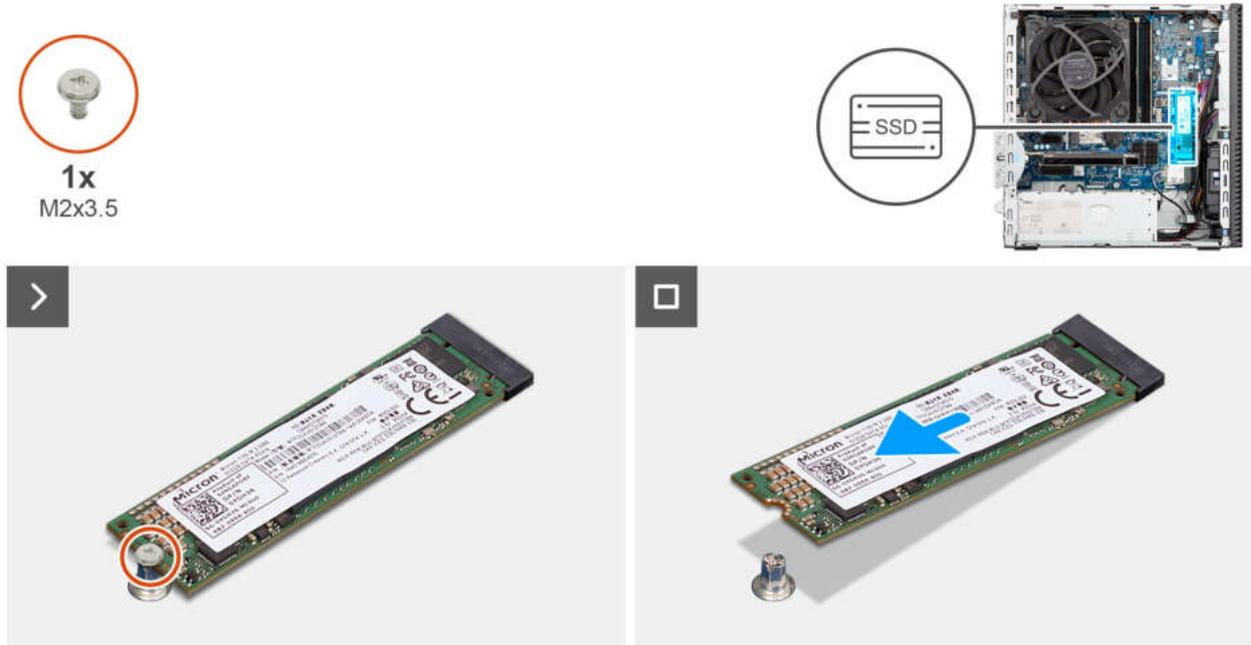
Abbildung 37. Entfernen des M.2-2280-Solid-State-Laufwerks
