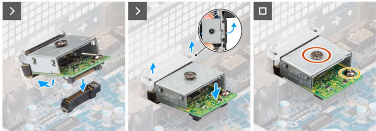
Abbildung 78. Installieren des optionalen DisplayPort-Moduls
