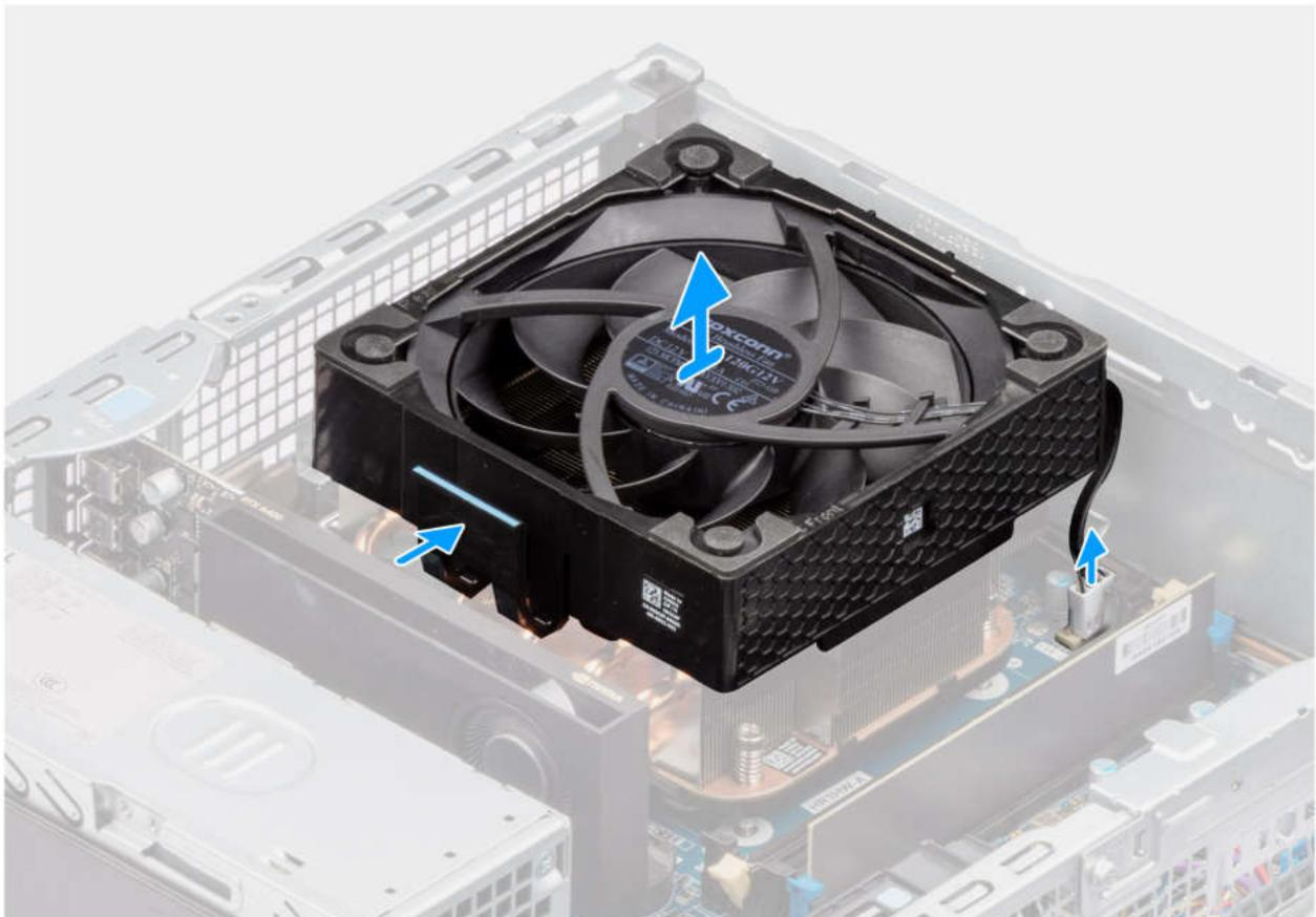
Abbildung 51. Entfernen des Prozessorlüfters
