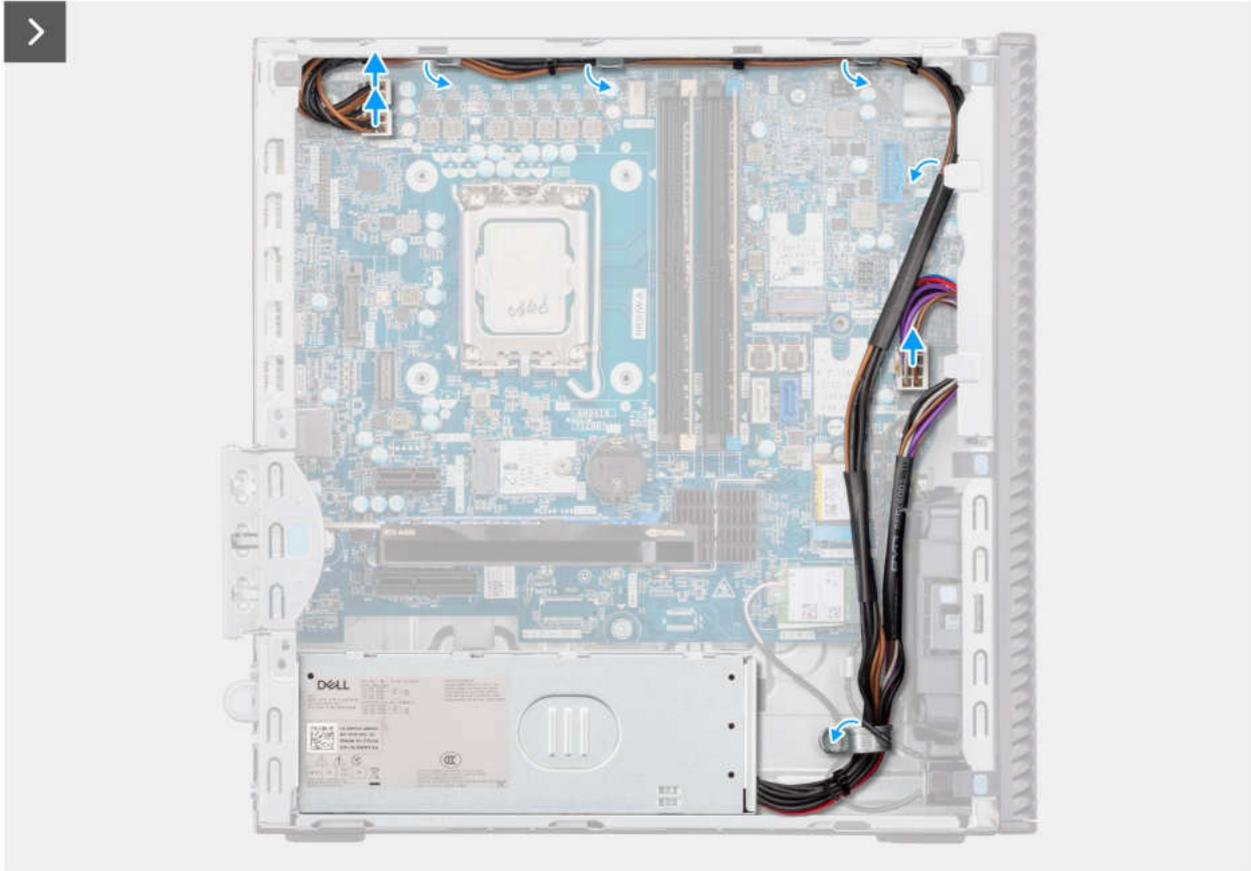
Abbildung 57. Installieren der Stromversorgungseinheit
