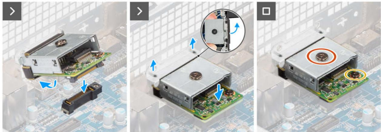
Abbildung 72. Installieren des optionalen LAN-Moduls
