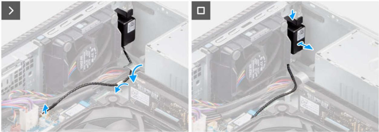
**Abbildung 25. Entfernen des internen Lautsprechers**
