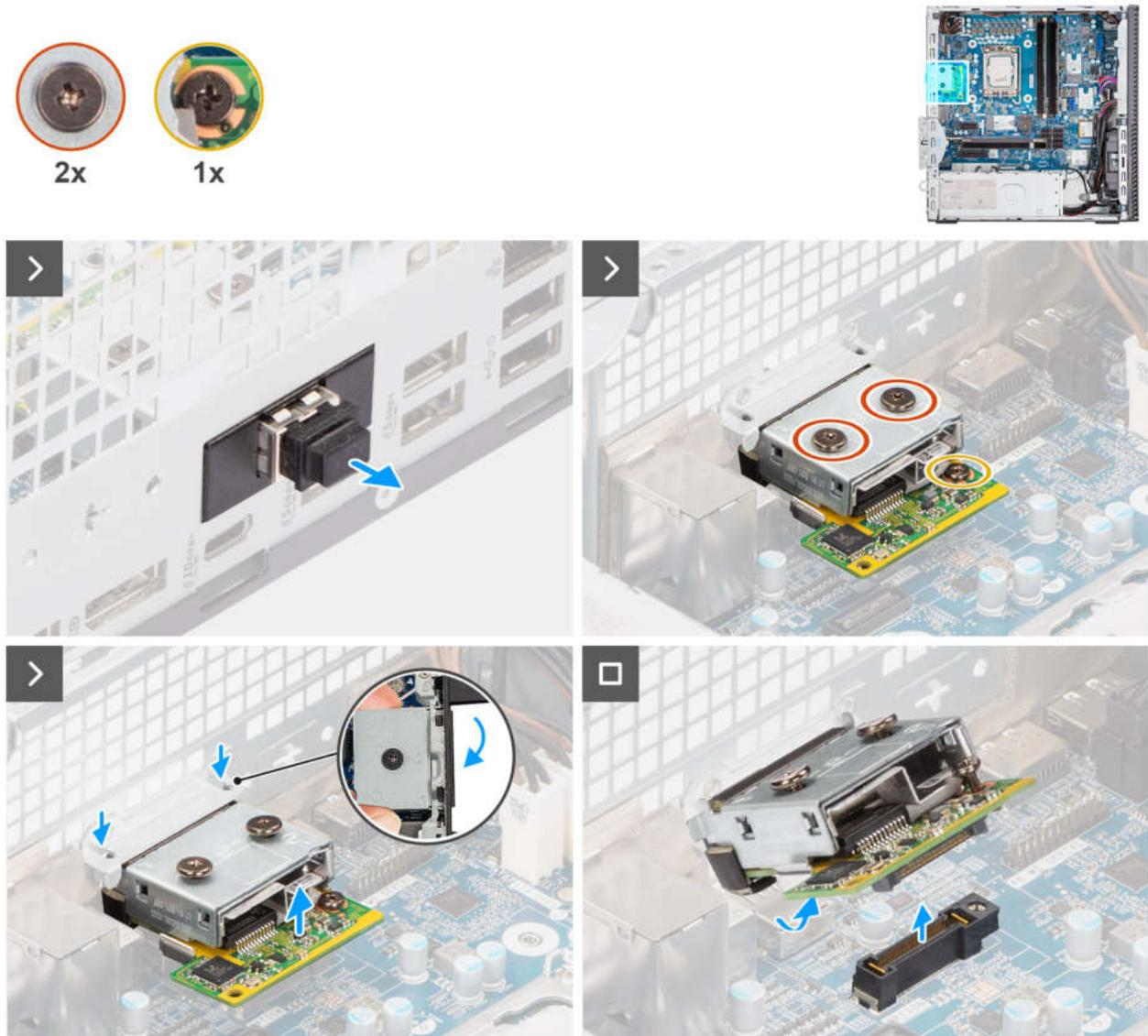
**Abbildung 79. Entfernen des optionalen optischen 5-GbE-Moduls**
