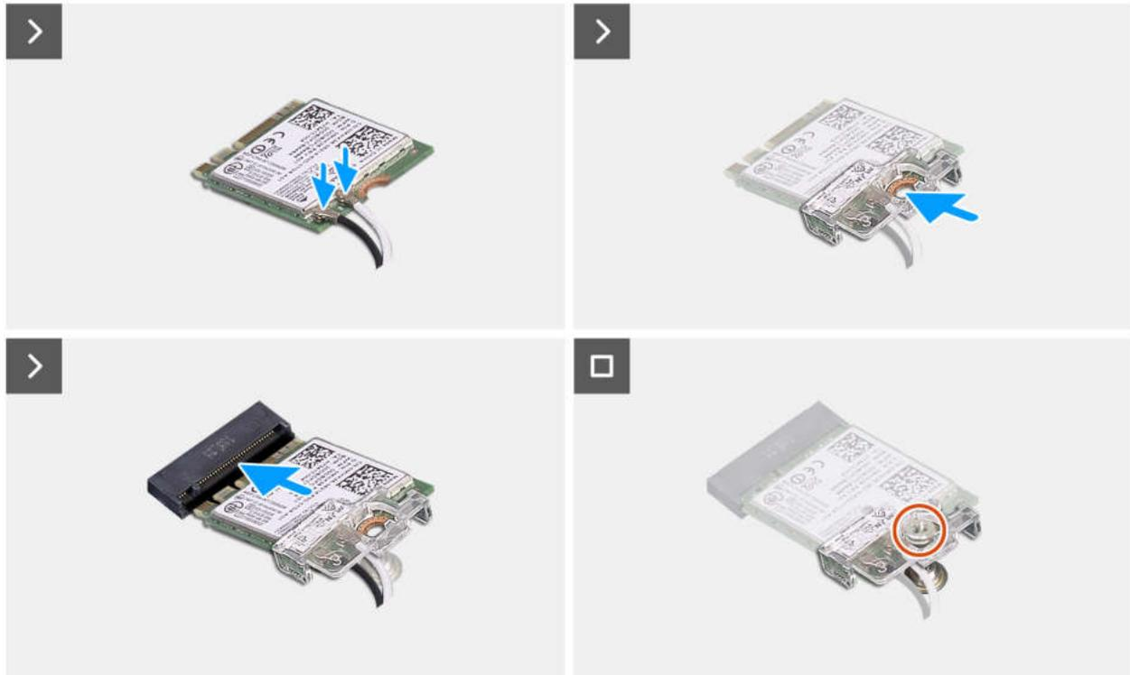
Abbildung 42. Installieren der Wireless-Karte
