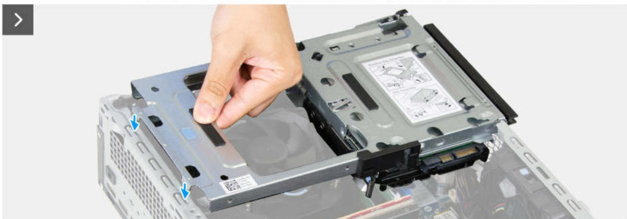
Abbildung 23. Installieren des Laufwerksschachts
