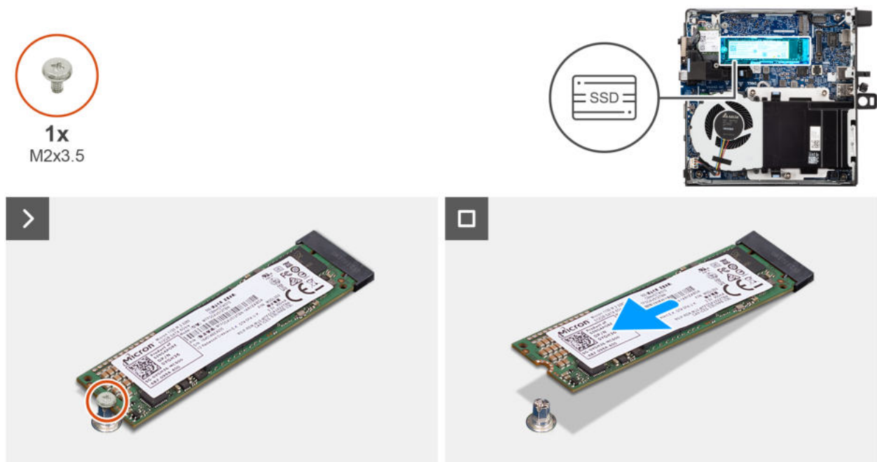
Abbildung 19. Entfernen des M.2-2280-Solid-State-Laufwerks
