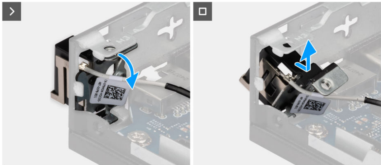
Abbildung 67. Entfernen des Antennenmoduls (weißes Kabel)
