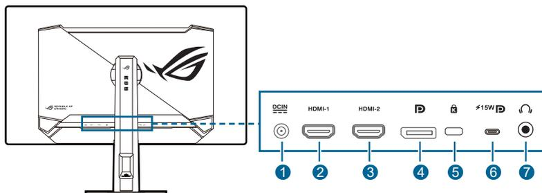
1. **DC-IN-Port.** Hier schließen Sie das Netzteil an.
