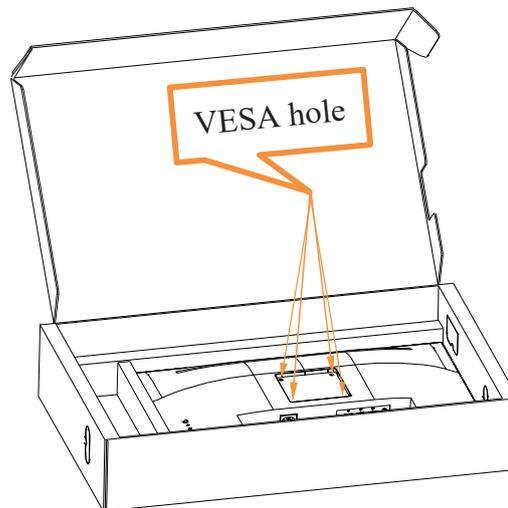
Schritt 5: Fixieren Sie den Monitor an der Wand, halten Sie sich dabei an die mit dem Wandmontageset gelieferten Anweisungen. Nur zur Anwendung mit einer UL-gelisteten Wandmontagehalterung; minimale Belastbarkeit: 8kg
