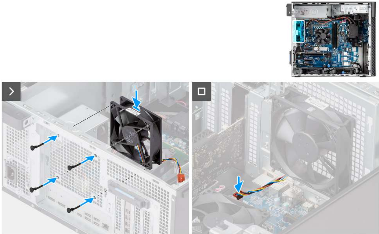
Afbeelding 50. De achterste ventilator voor 360 W PSU-systemen installeren
