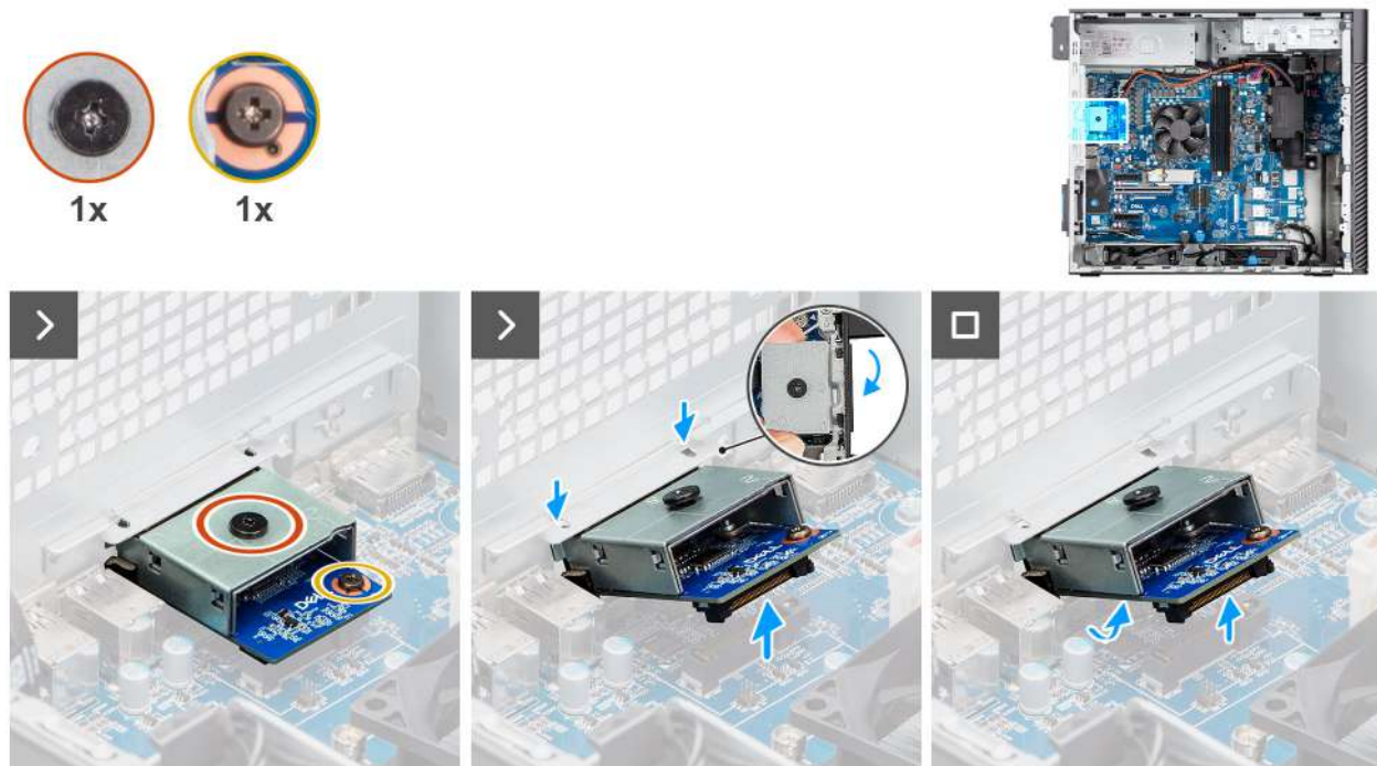
Afbeelding 70. De optionele HDMI-module verwijderen
