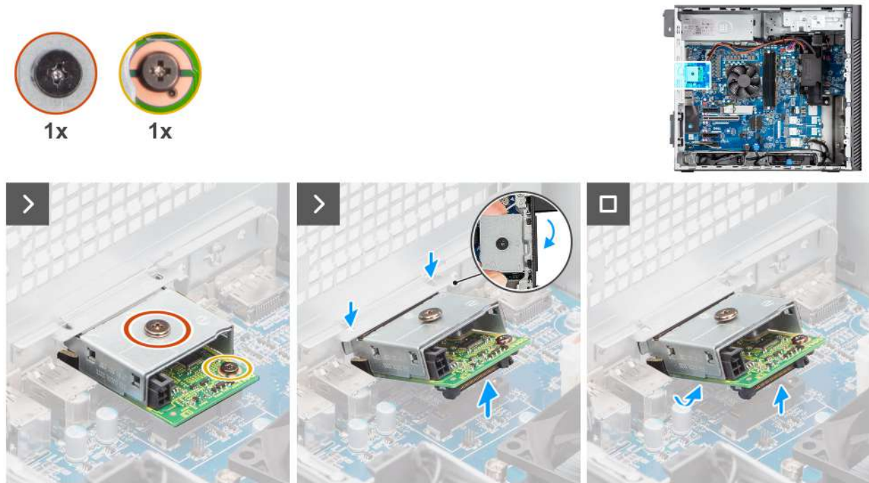
Afbeelding 82. De optionele USB-module verwijderen
