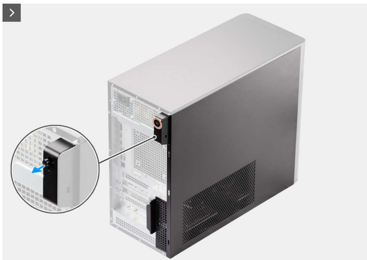
Afbeelding 9. De zijplaat verwijderen
