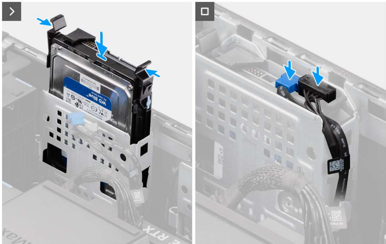
Afbeelding 30. De 3,5-inch harde-schijf eenheid vanuit bay 1 installeren
