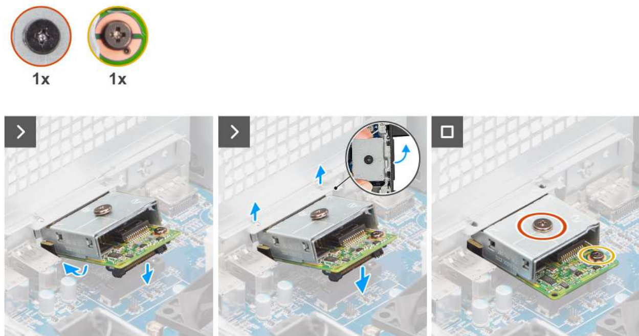
Afbeelding 78. De optionele LAN-module installeren.
