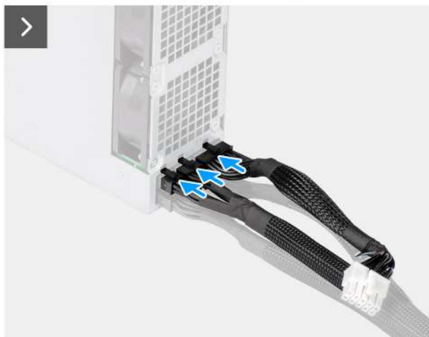
Afbeelding 55. De voedingseenheid van 1500 W plaatsen
