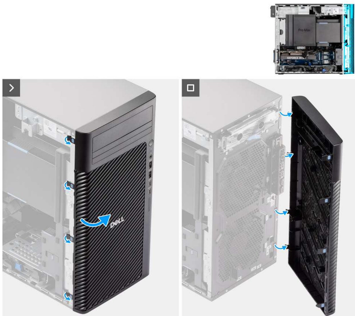
Afbeelding 17. Het montagekader aan de voorkant verwijderen
