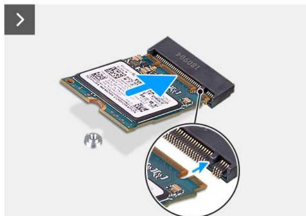
Afbeelding 32. De M.2 2230 PCIe SSD plaatsen
