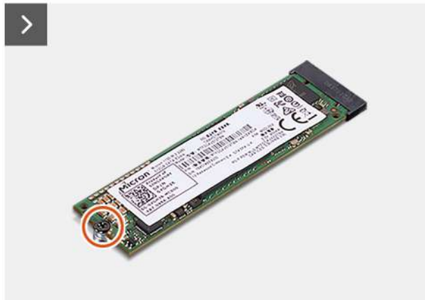
Afbeelding 33. De M.2 2280 PCIe SSD verwijderen
