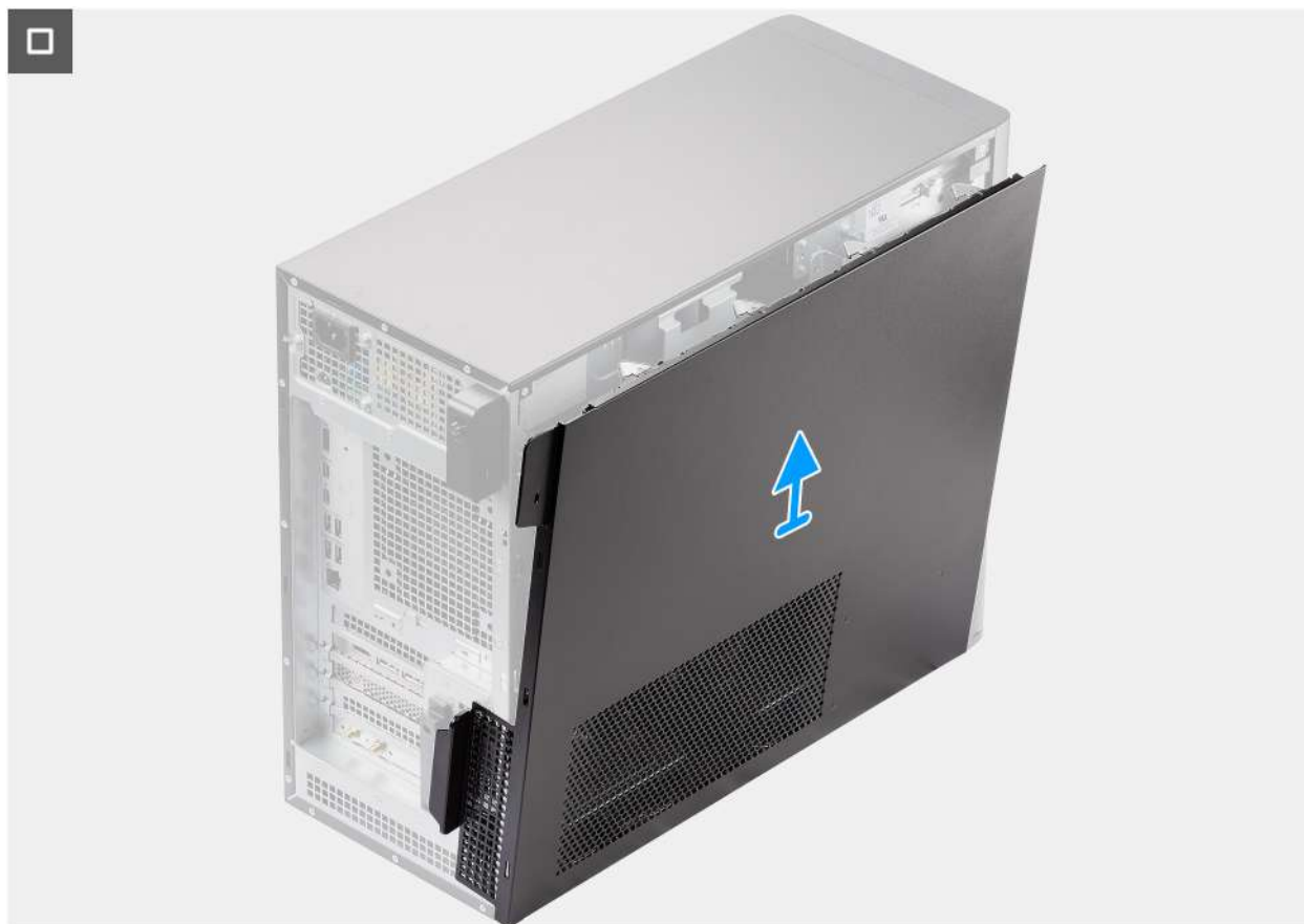
Afbeelding 10. De zijplaat verwijderen
