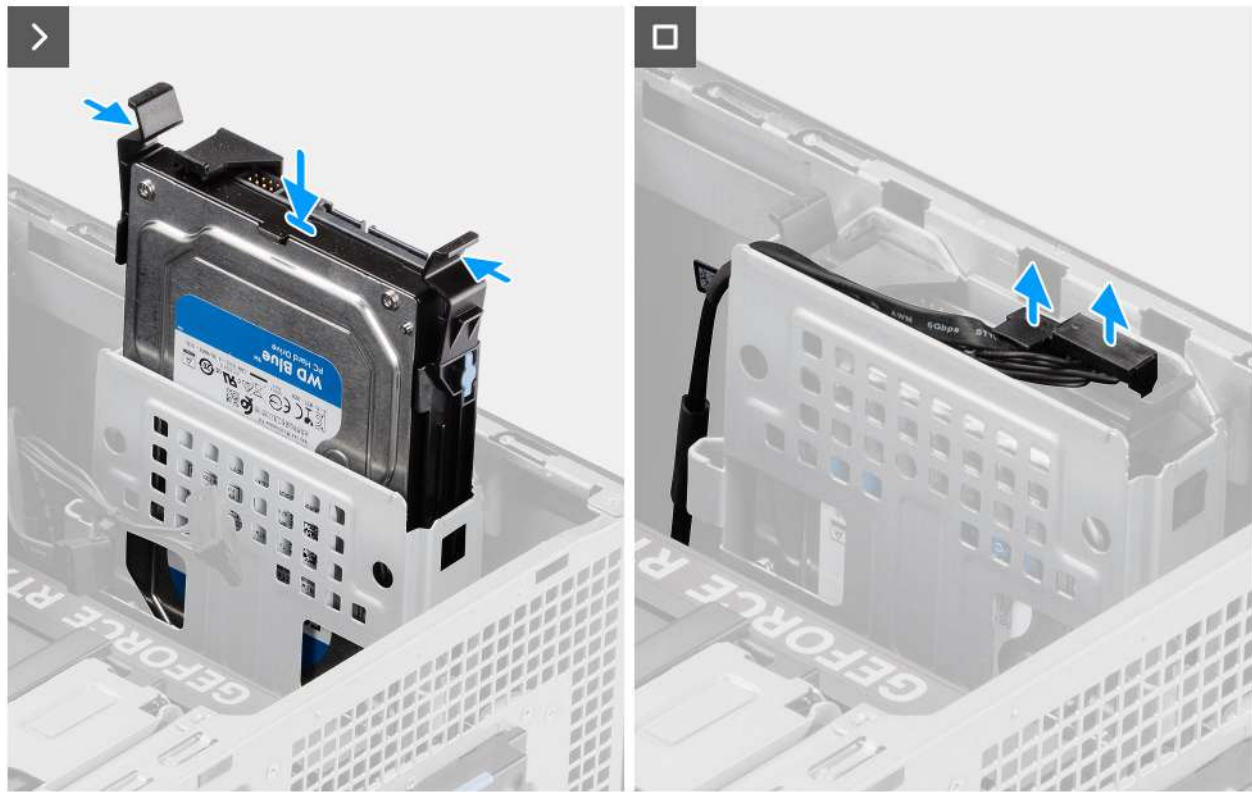
Afbeelding 29. De 3,5 inch harde-schijf (bay-2) installeren
