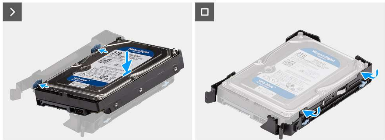
Afbeelding 28. De beugel van de 3,5-inch harde schijf installeren
