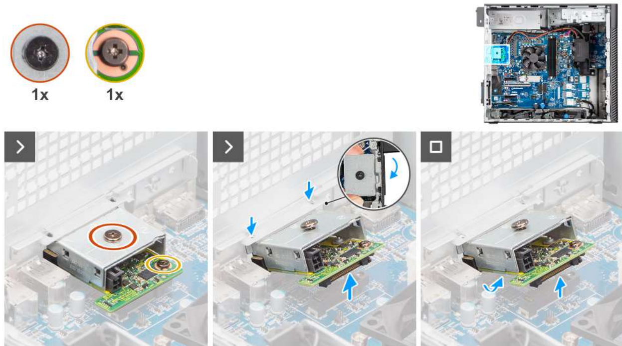
Afbeelding 79. De optionele Thunderbolt-module verwijderen
