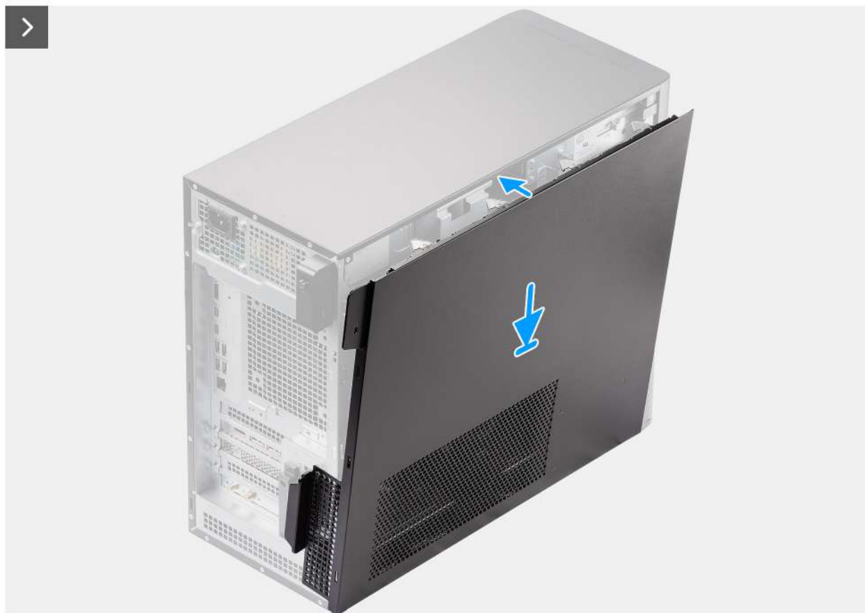
Afbeelding 11. De zijplaat plaatsen
