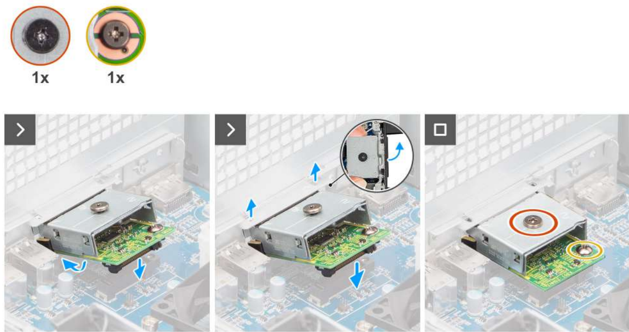
Afbeelding 69. De optionele DisplayPort-module installeren
