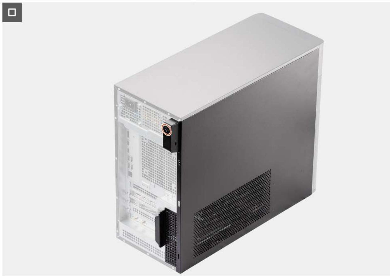
Afbeelding 12. De zijplaat plaatsen
