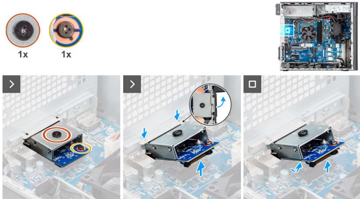
Afbeelding 85. De optionele VGA-module verwijderen
