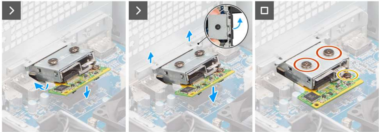
Afbeelding 75. De optionele optische 5 GbE-module installeren
