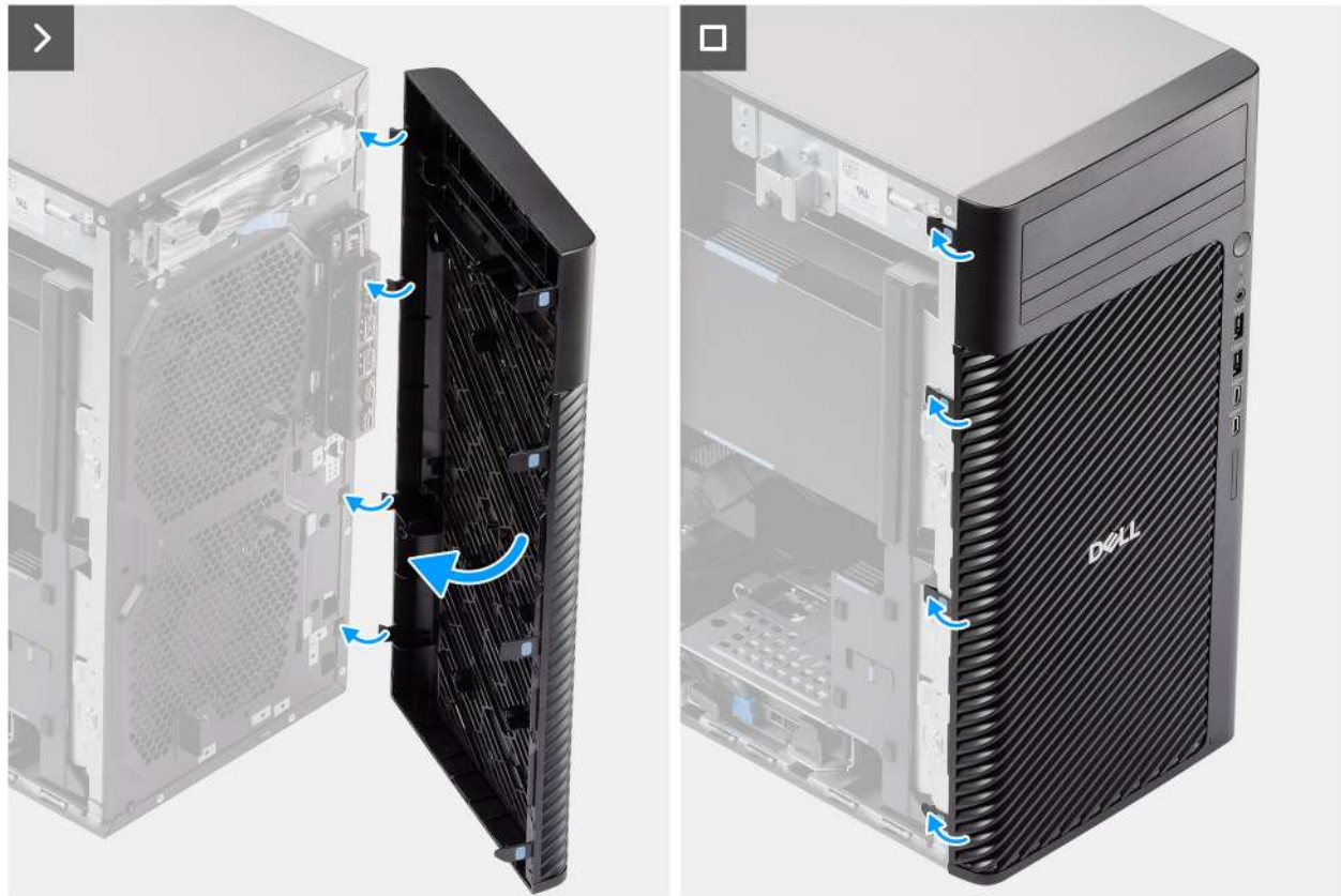
Afbeelding 18. Het montagekader aan de voorkant plaatsen
