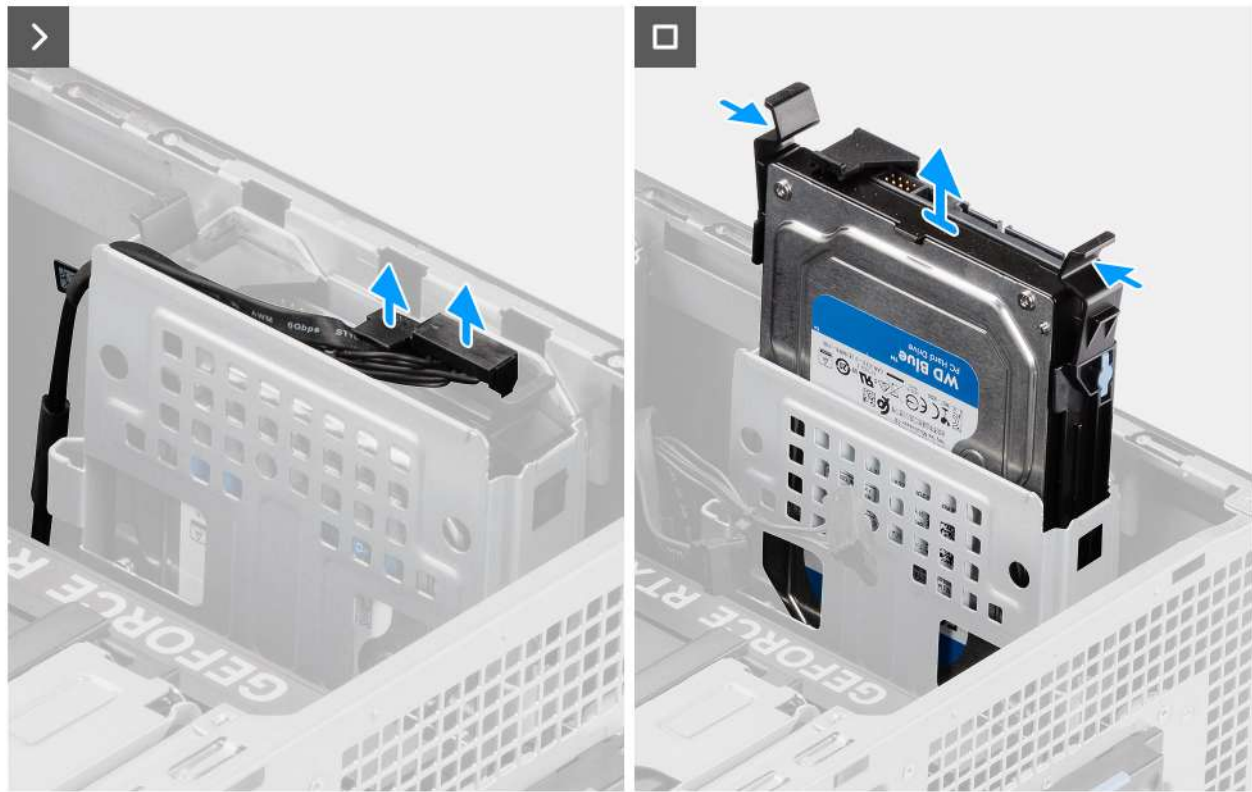
Afbeelding 26. De 3,5-inch harde-schijf eenheid verwijderen (bay-2)
