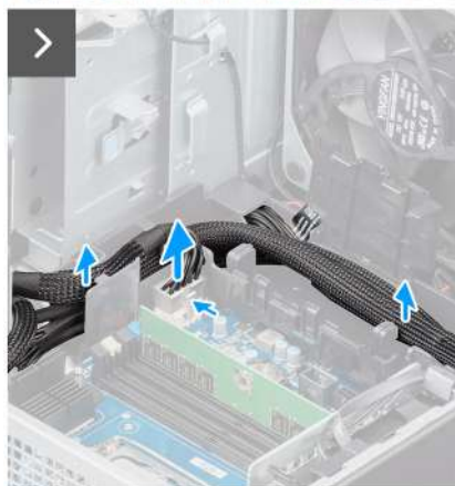
Afbeelding 53. De voedingseenheid van 1500 W verwijderen
