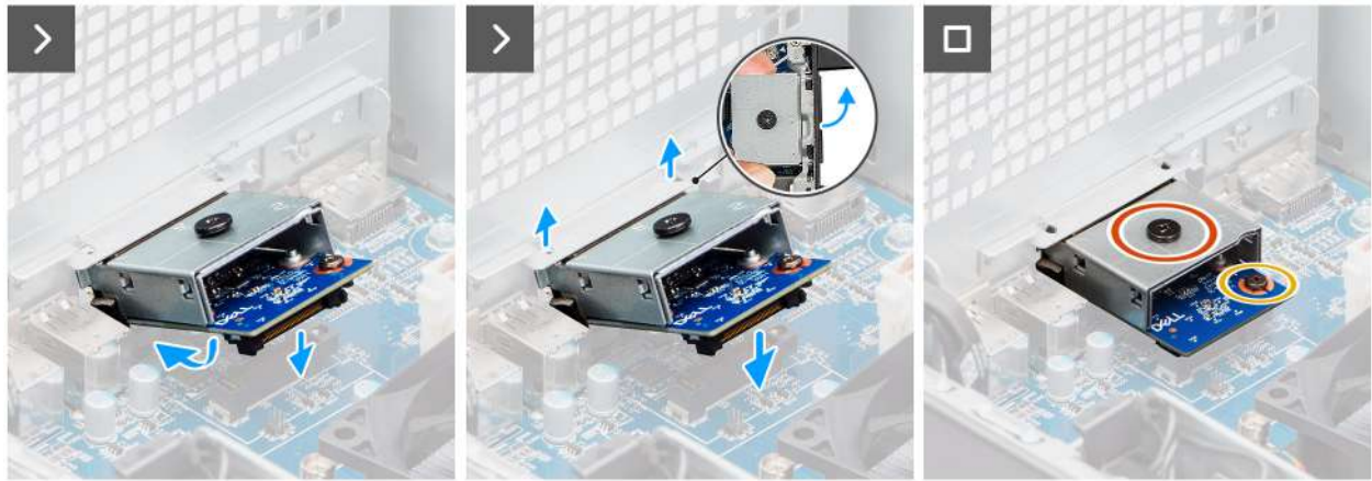
Afbeelding 87. De optionele VGA-module installeren.
