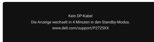
Abbildung 77. Warnmeldung: DP-Kabel getrennt
