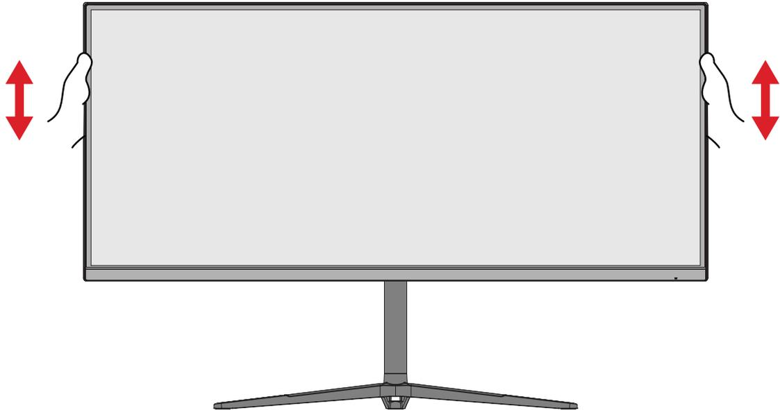
**Hinweis:** Bei der Anpassung fest entlang der Einstellschiene nach unten drücken, während Sie den Monitor mit beiden Händen an der Seite halten.
