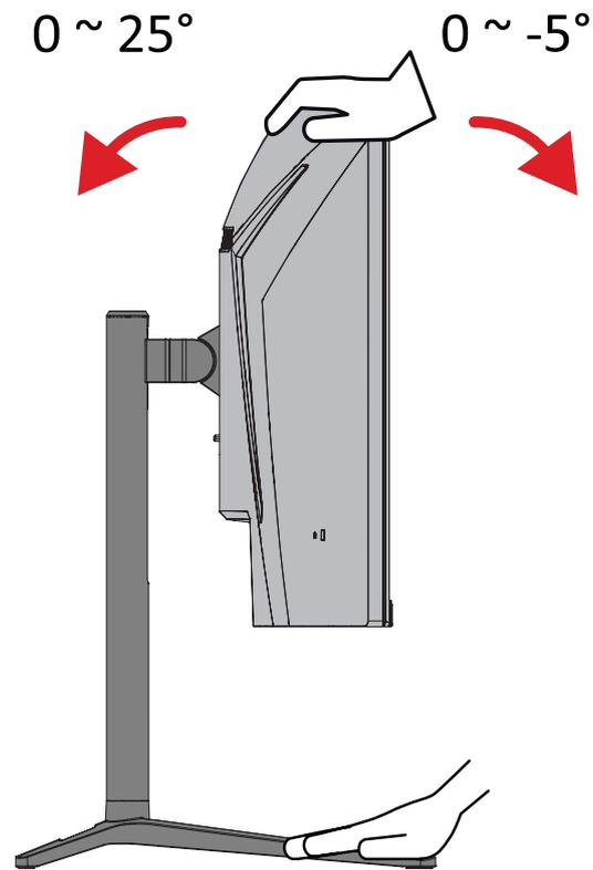
**Hinweis:** Stützen Sie den Ständer beim Anpassen sicher mit einer Hand, während Sie den Monitor mit der anderen Hand nach vorne oder hinten neigen.
