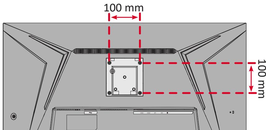
1. Bringen Sie die Montagehalterung an den VESA-Montagelöchern an der Rückseite des Gerätes an. Sichern Sie sie dann mit vier (4) Schrauben (M4 x 10 mm).
