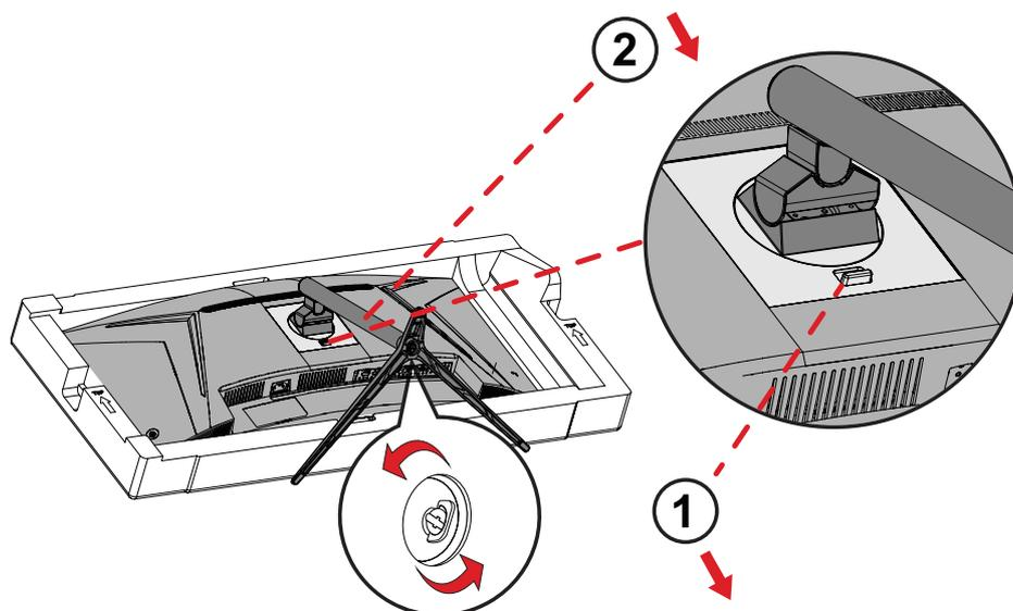
**WICHTIG:** Bevor Sie den Ständer entfernen, schalten Sie den Monitor aus, ziehen Sie alle Kabel ab und legen Sie den Monitor mit dem Bildschirm nach unten auf eine flache, stabile Oberfläche.
