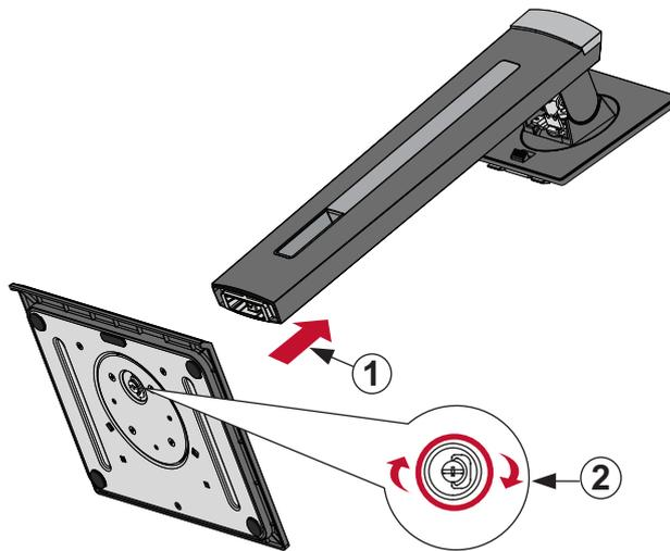
4. Richten Sie die oberen Haken des Monitorständers wie nachstehend gezeigt an den Ständermontageschlitzen aus und schieben Sie sie hinein:
