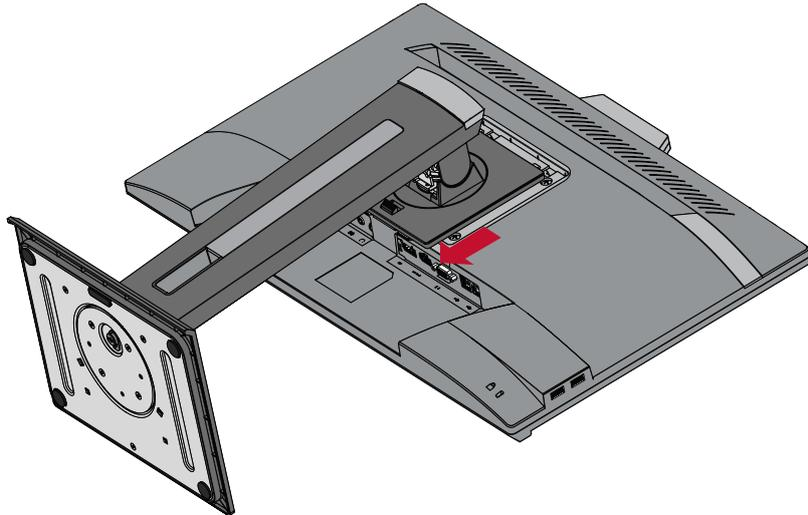
5. Bringen Sie die Montagehalterung an den VESA-Montagelöchern an der Rückseite des Gerätes an. Sichern Sie sie dann mit vier (4) Schrauben (M4 x 10 mm).
