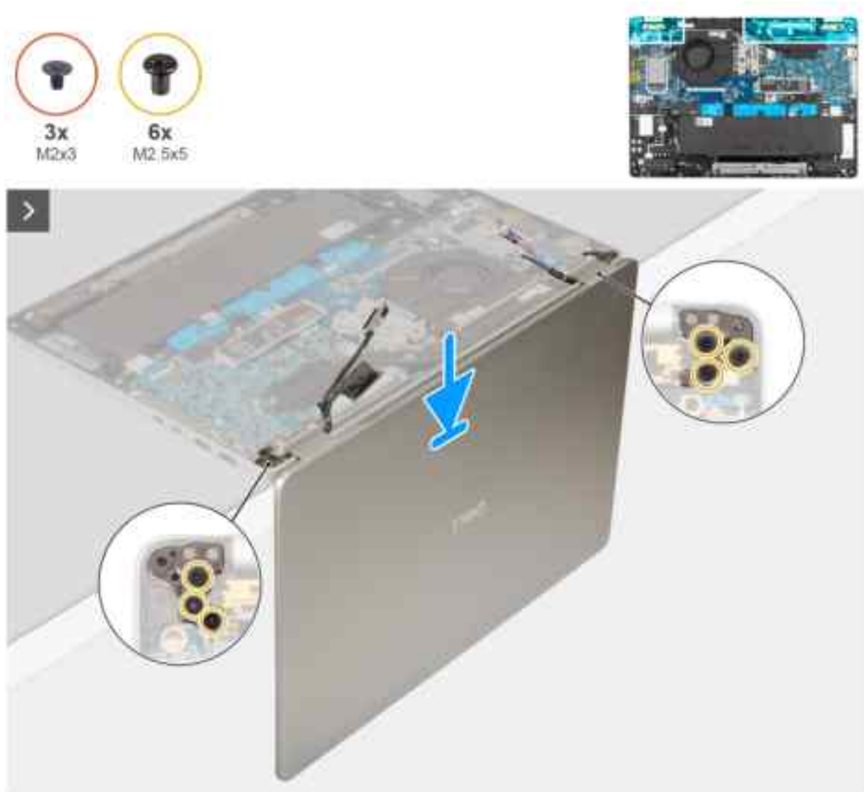
Abbildung 57. Einbauen der Bildschirmbaugruppe
