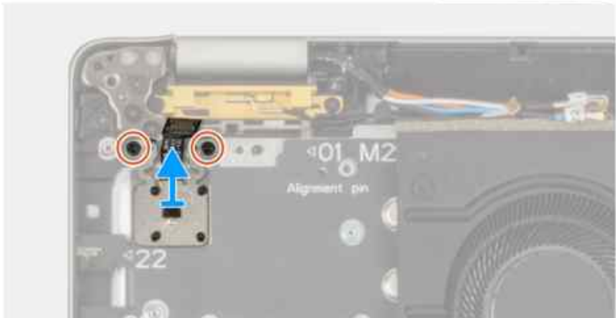
Abbildung 53. Installieren des Netzschalters mit optionalem Fingerabdruck-Lesegerät
