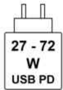
Abbildung 9. Piktogramm für die Anforderungen an die Stromversorgung
