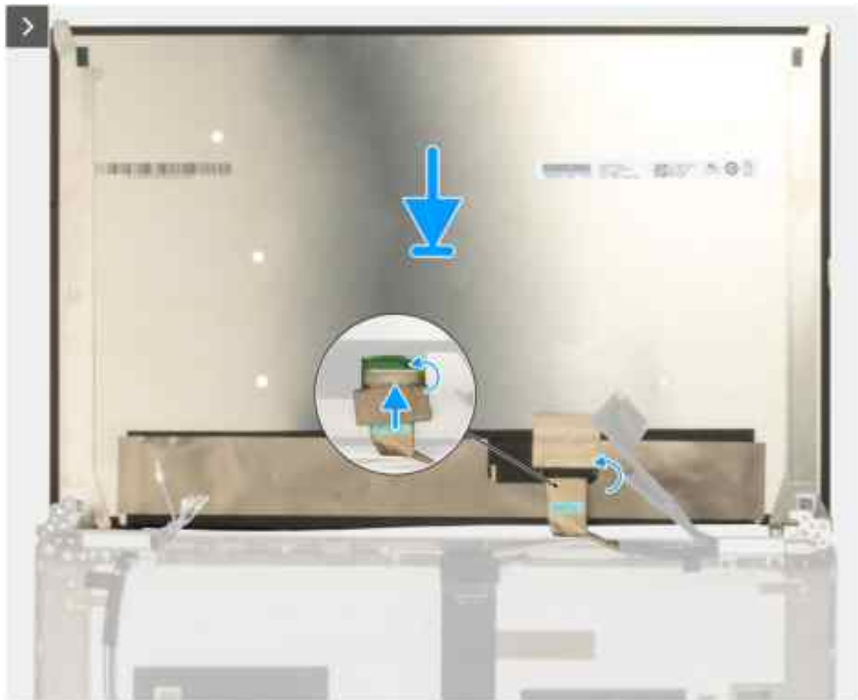
Abbildung 67. Einbauen des Bildschirms
