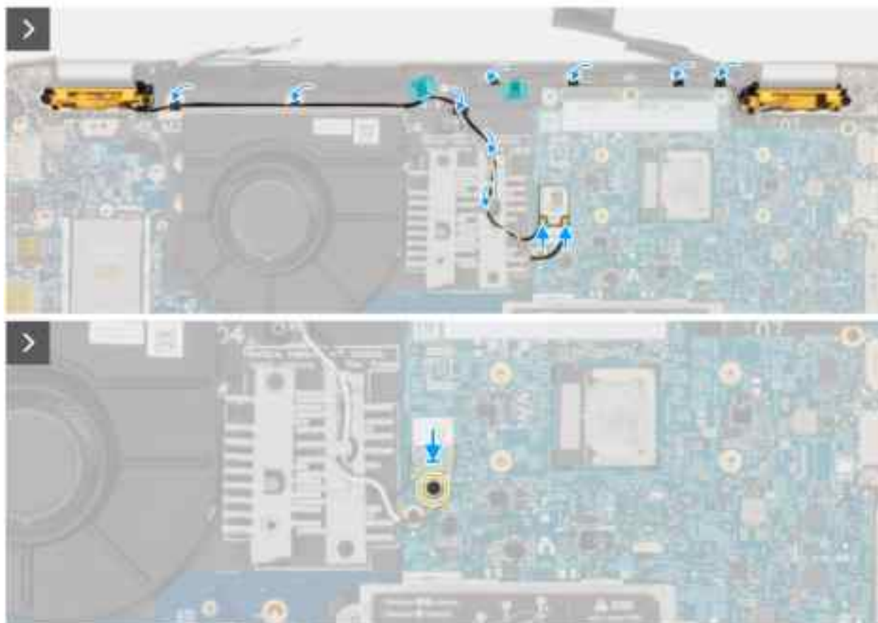
Abbildung 37. Installieren der WLAN-Antenne
