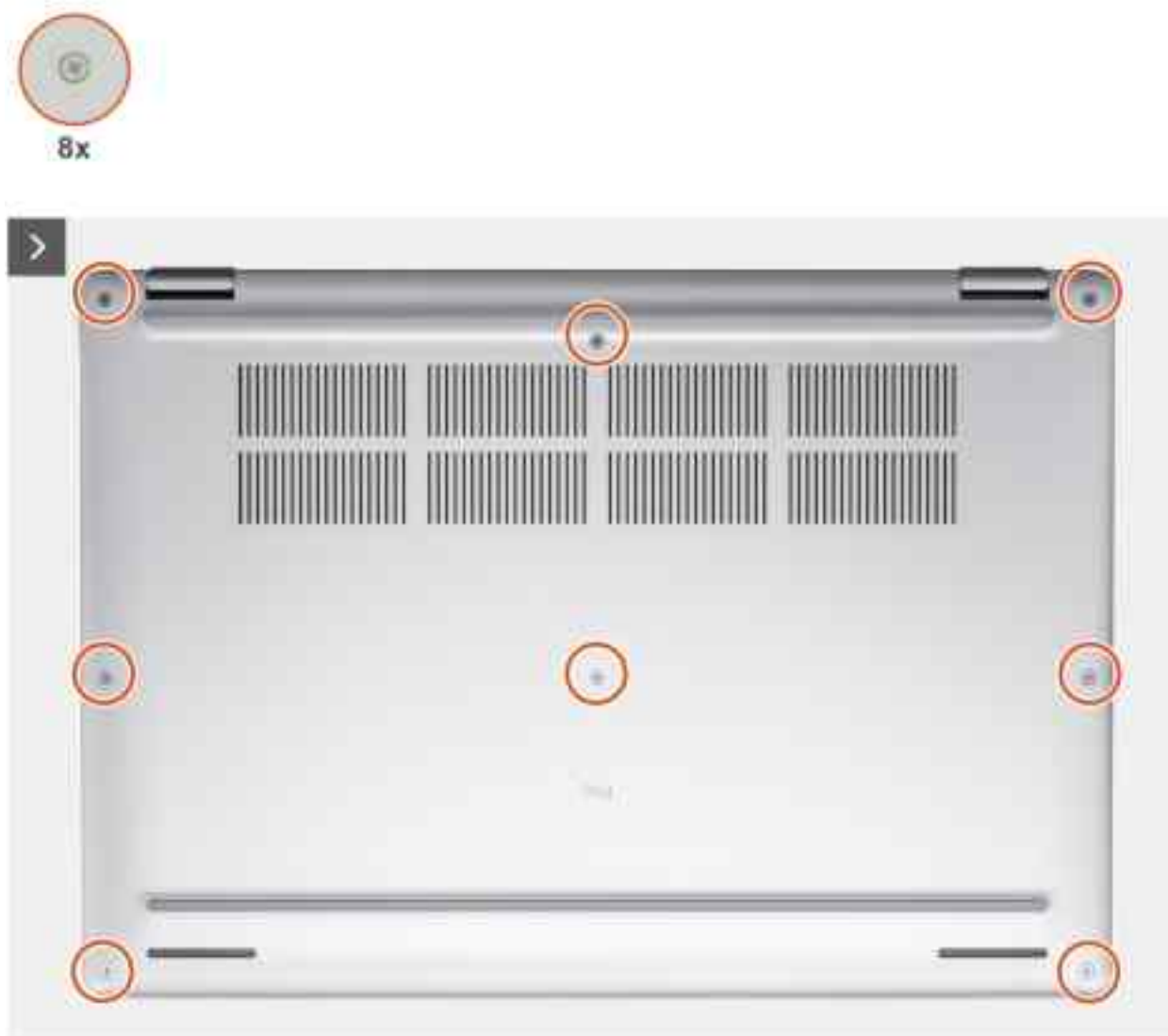
Abbildung 13. Entfernen der Bodenabdeckung
