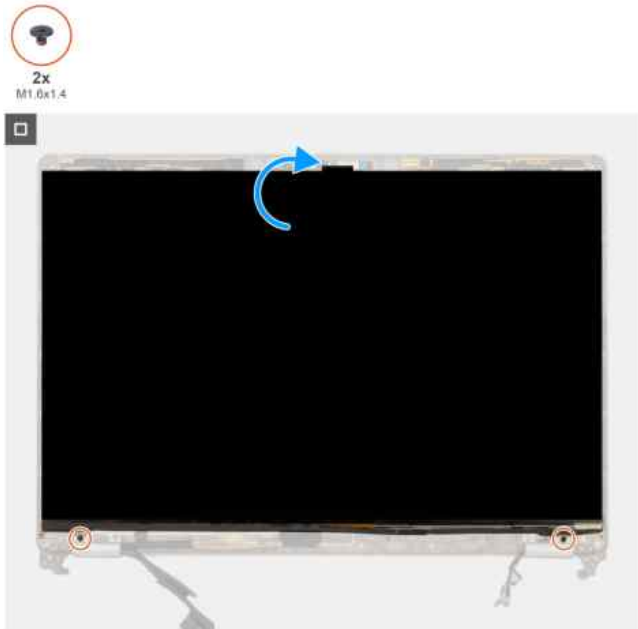
Abbildung 68. Einbauen des Bildschirms
