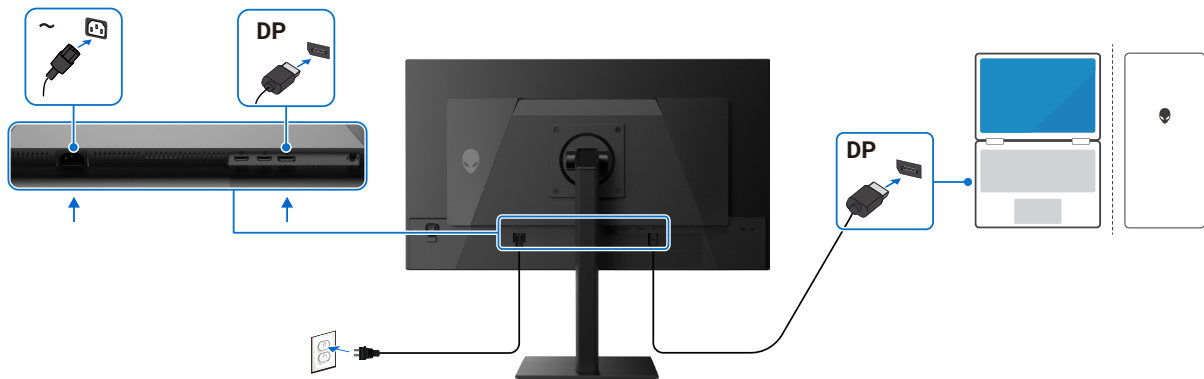
Abbildung 20. DisplayPort-Kabel (DP auf DP) anschließen
