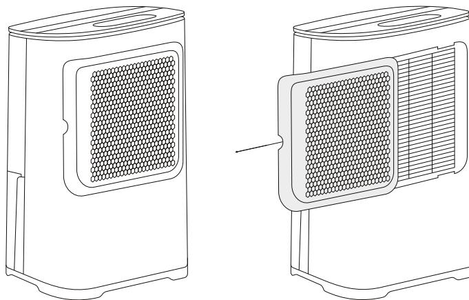
Der Staubfilter ist ein Filter mit langer Lebensdauer und sollte daher nicht ausgetauscht werden müssen (außer aus Verschleißgründen). Bei regelmäßigerem Gebrauch kann sich der Filter mit Staub und Schmutzpartikeln zusetzen. Der Filter muss mindestens alle zwei Wochen gereinigt werden (andernfalls kann die Garantie für das Gerät erlöschen). Bitte befolgen Sie die nachstehenden Schritte.
