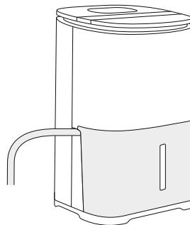
Setzen Sie den Wasserbehälter wieder in den Luftentfeuchter ein.
