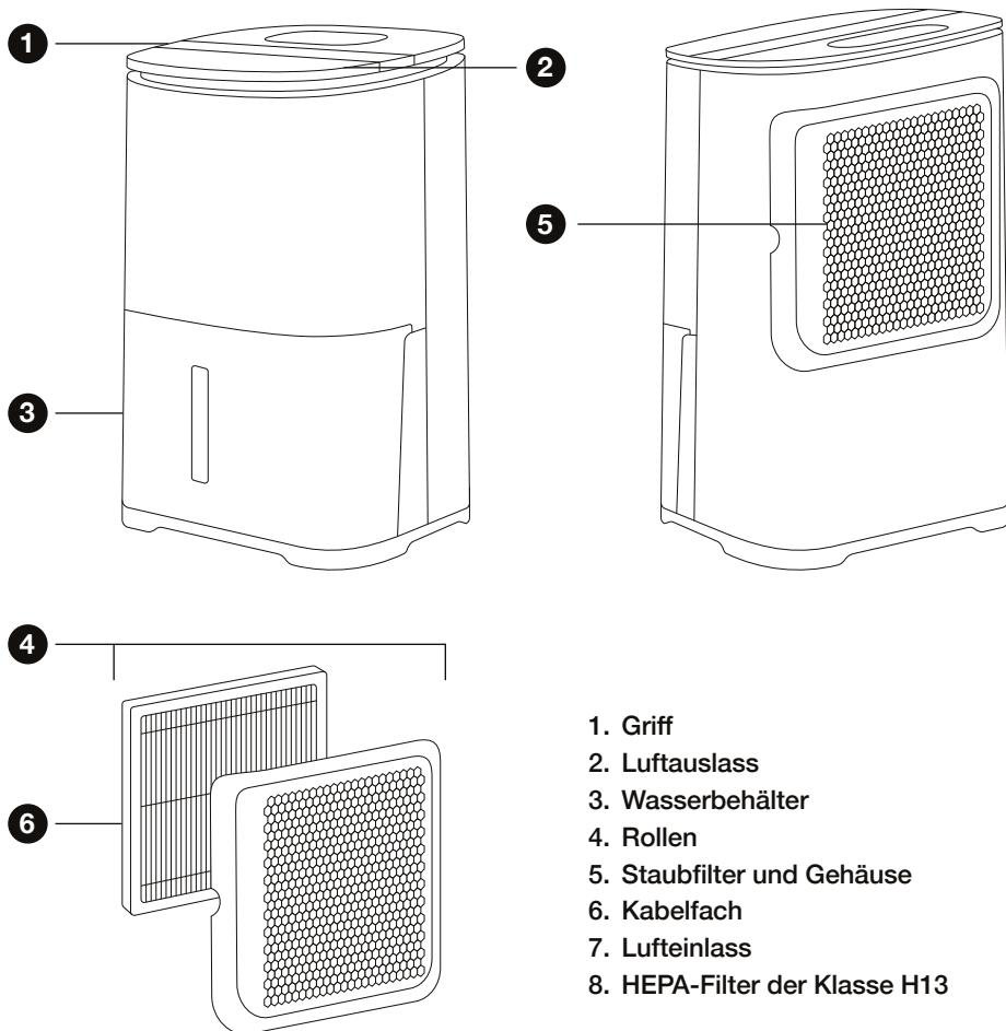
**Wichtig!** Entfernen Sie vor dem Gebrauch die Plastikverpackung des HEPA-H13-Filters.
