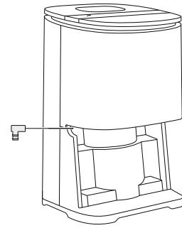
Nehmen Sie das rechtwinklige Verbindungsstück aus dem Deckel des Wasserbehälters und schieben Sie es auf den Ablauf. Der Ablauf ist die Stelle, an der das Wasser aus dem Luftentfeuchter tropft. Er befindet sich auf der linken Seite.
