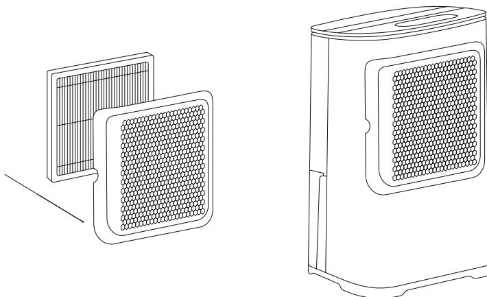
Der Luftentfeuchter wird mit einem kostenlosen HEPA-Filter der Klasse H13 geliefert. Dieser HEPA-Filter kann in den Luftentfeuchter eingesetzt werden, um eine Luftreinigung zu ermöglichen. Dies ist jedoch optional – der Luftentfeuchter kann auch ohne den HEPA-Filter verwendet werden, d. h. er entfeuchtet die Luft nur und reinigt sie nicht.
