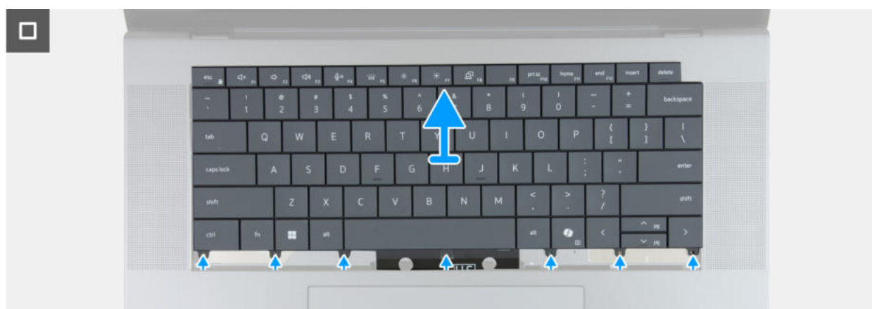
Abbildung 77. Entfernen der Tastatur
