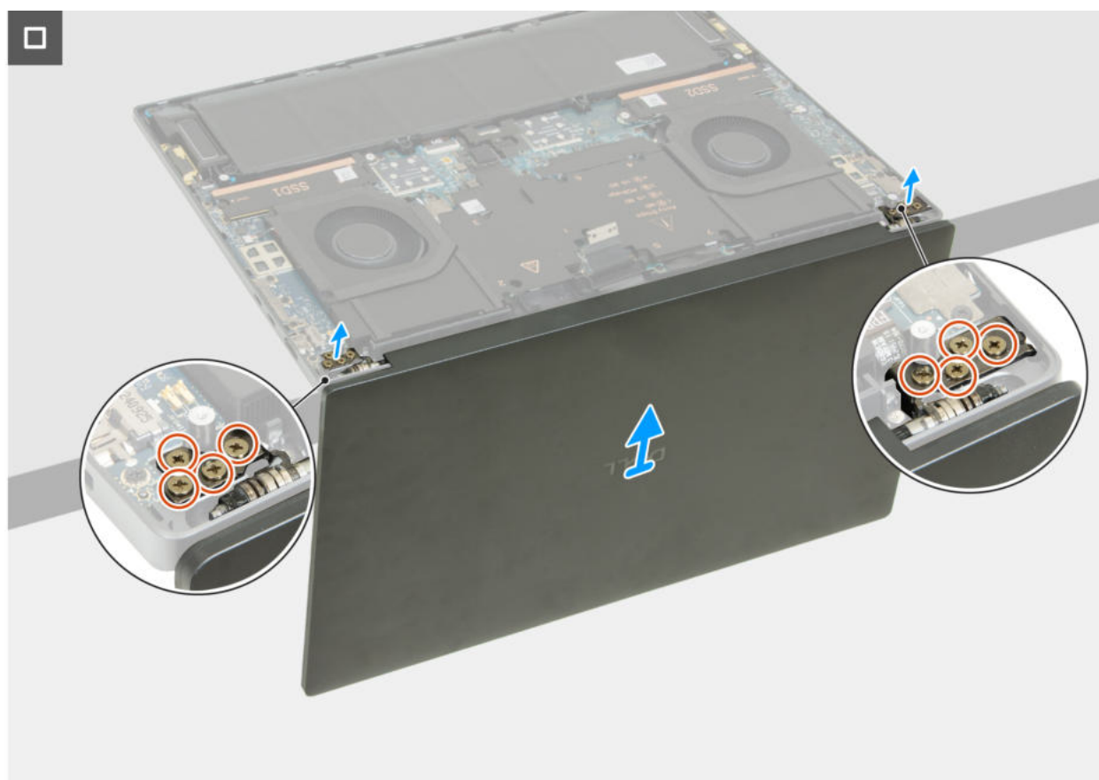
Abbildung 35. Entfernen der Bildschirmbaugruppe
