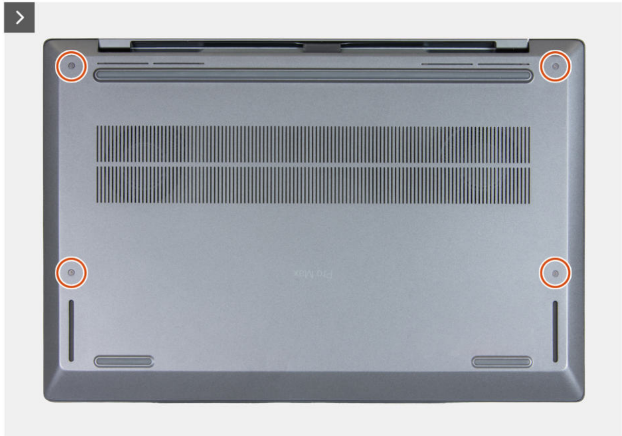
Abbildung 13. Entfernen der Bodenabdeckung
