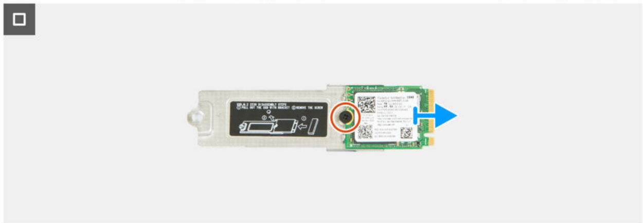
Abbildung 26. Entfernen des M.2 2230-Solid-State-Laufwerks (SSD1)
