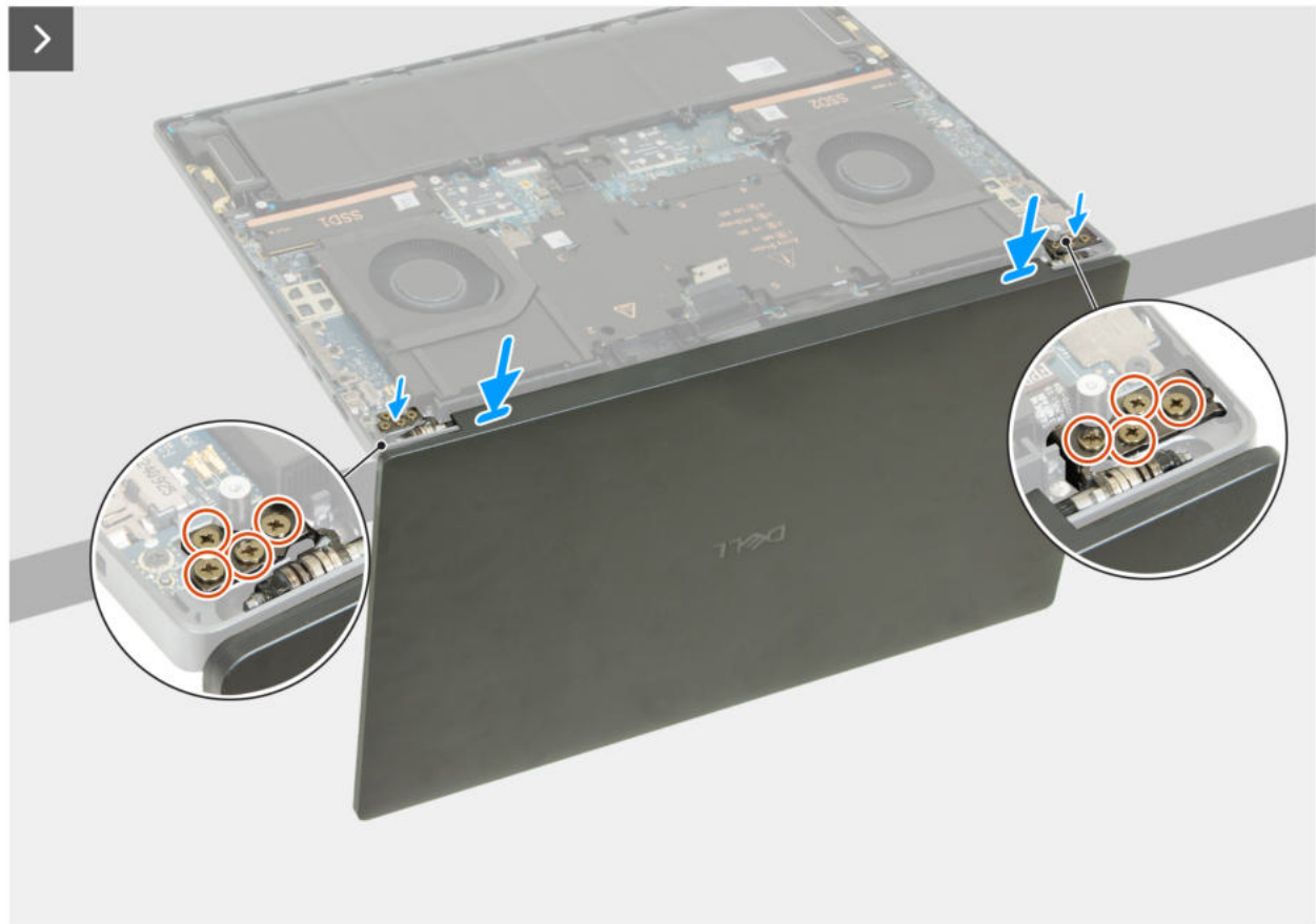
Abbildung 42. Einbauen der Bildschirmbaugruppe
