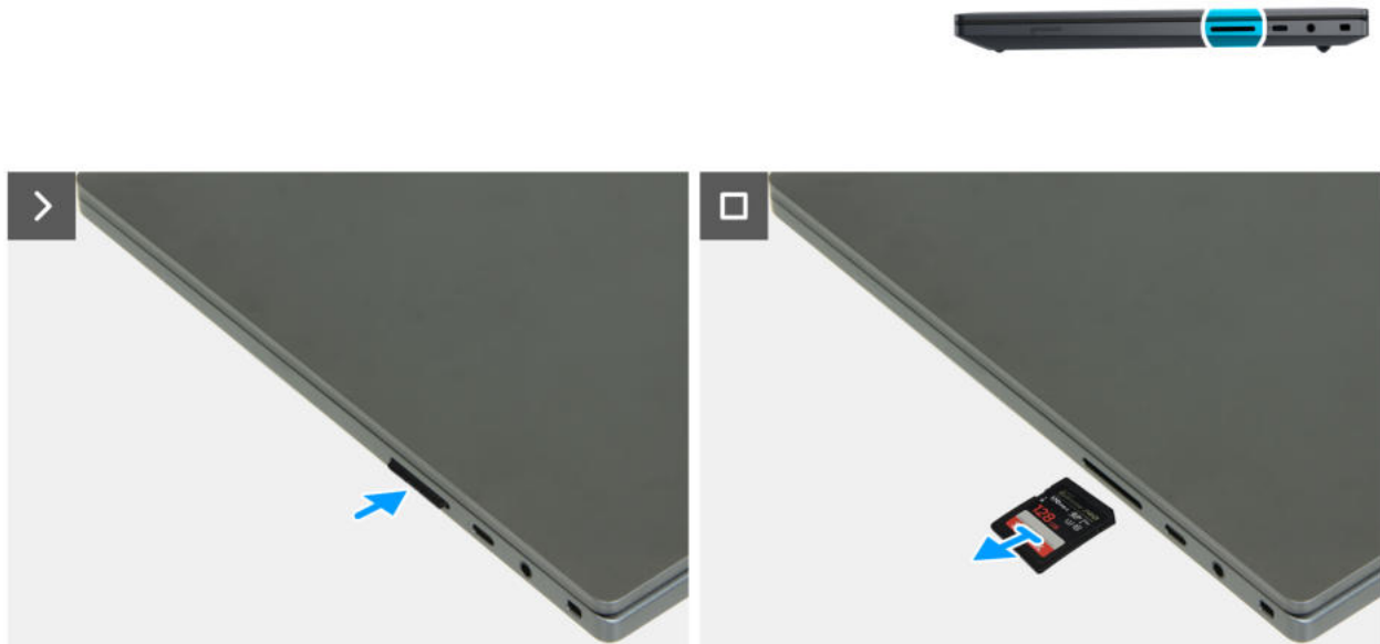
Abbildung 11. Entfernen der Speicherkarte
