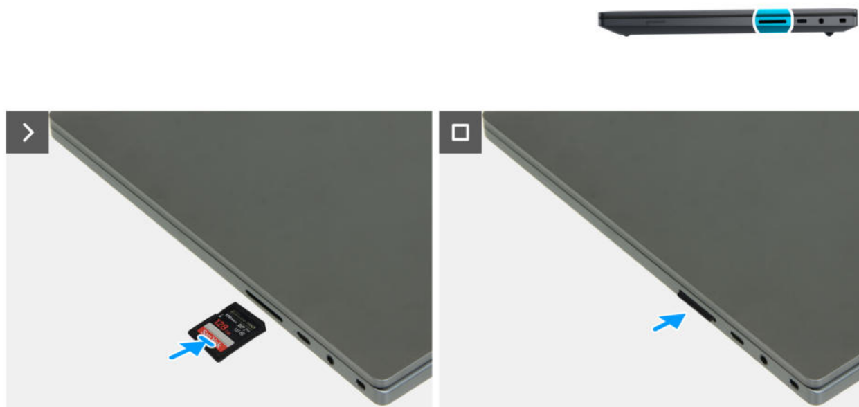
Abbildung 12. Einsetzen der Speicherkarte
