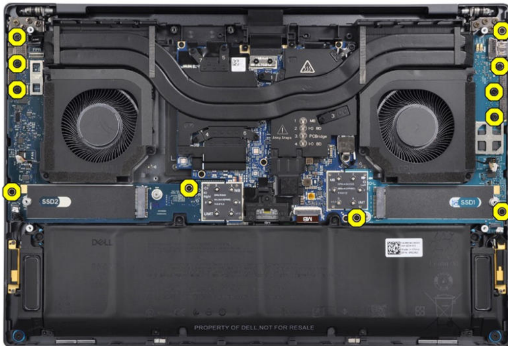
Abbildung 70. Schrauben der I/O-Platinen
