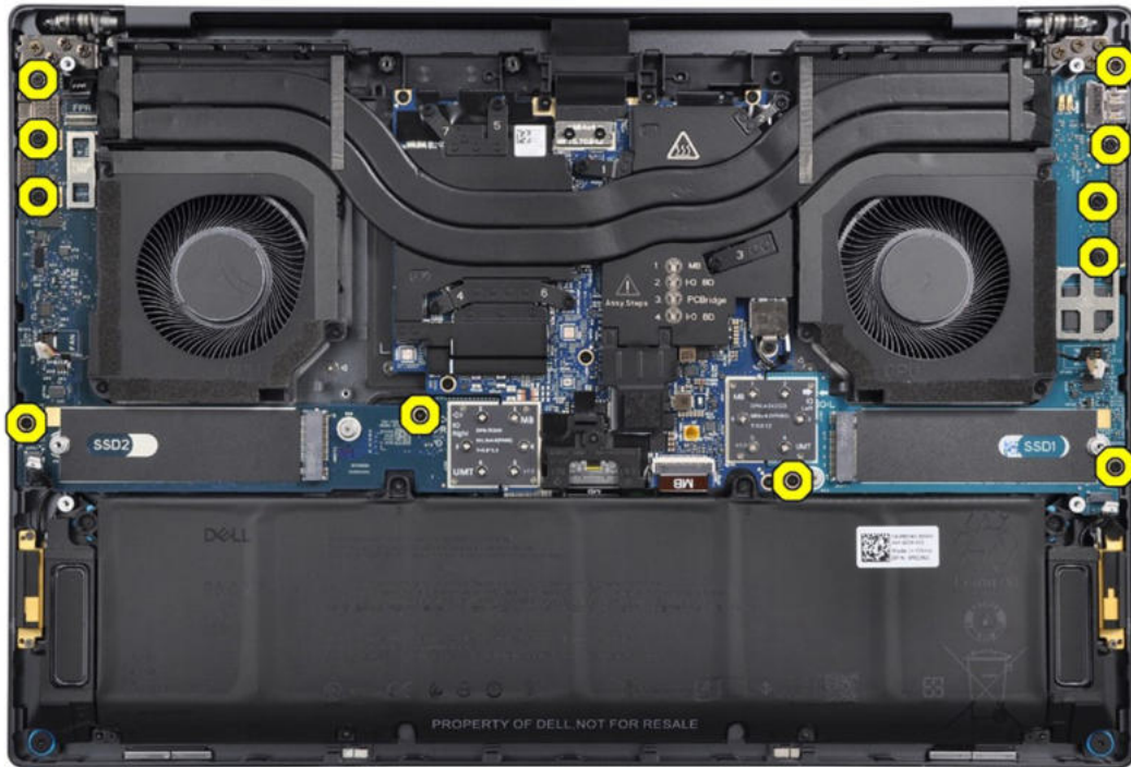
Abbildung 61. Schrauben der I/O-Platinen
