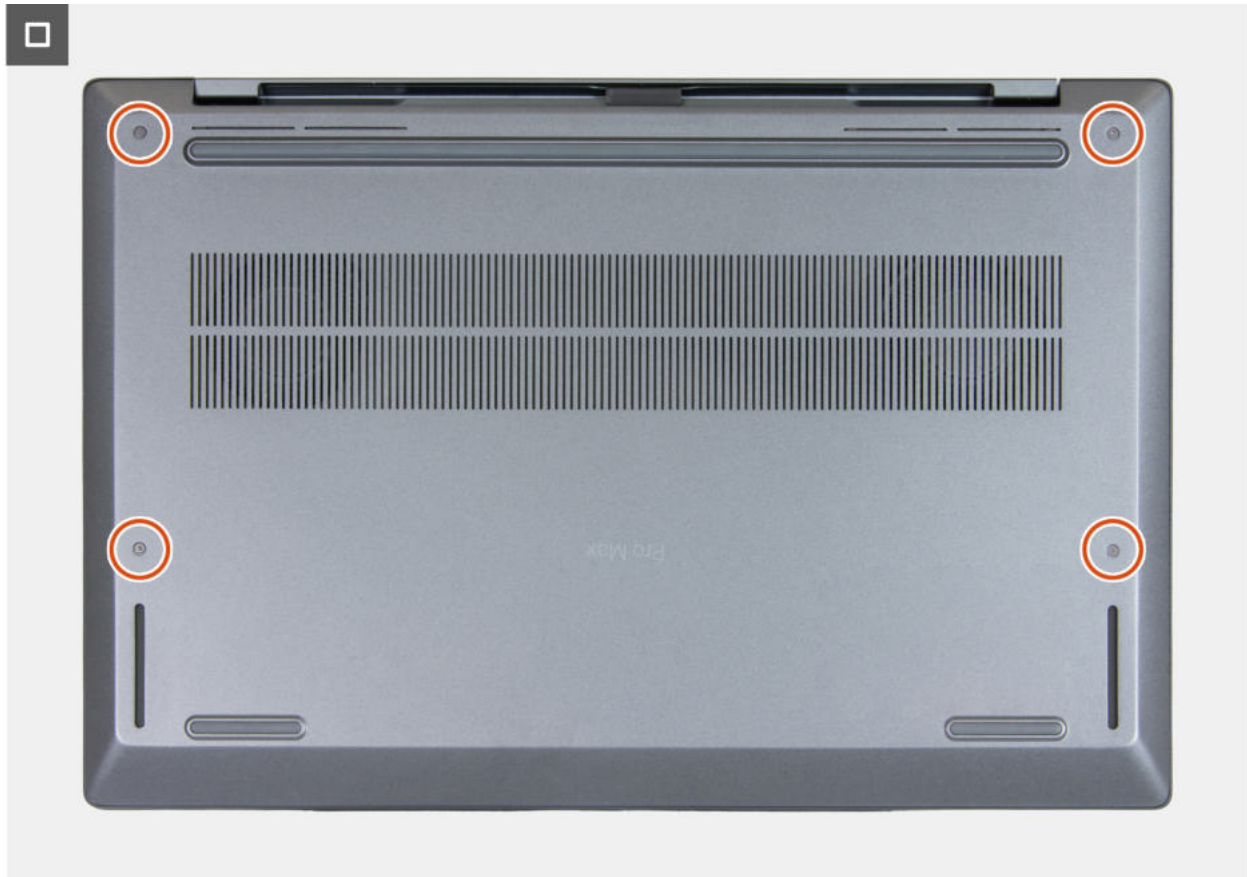
Abbildung 16. Anbringen der Bodenabdeckung
