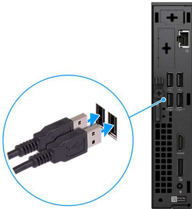
Afbeelding 4. Het toetsenbord en de muis aansluiten op uw Dell Pro Micro QCM1250
