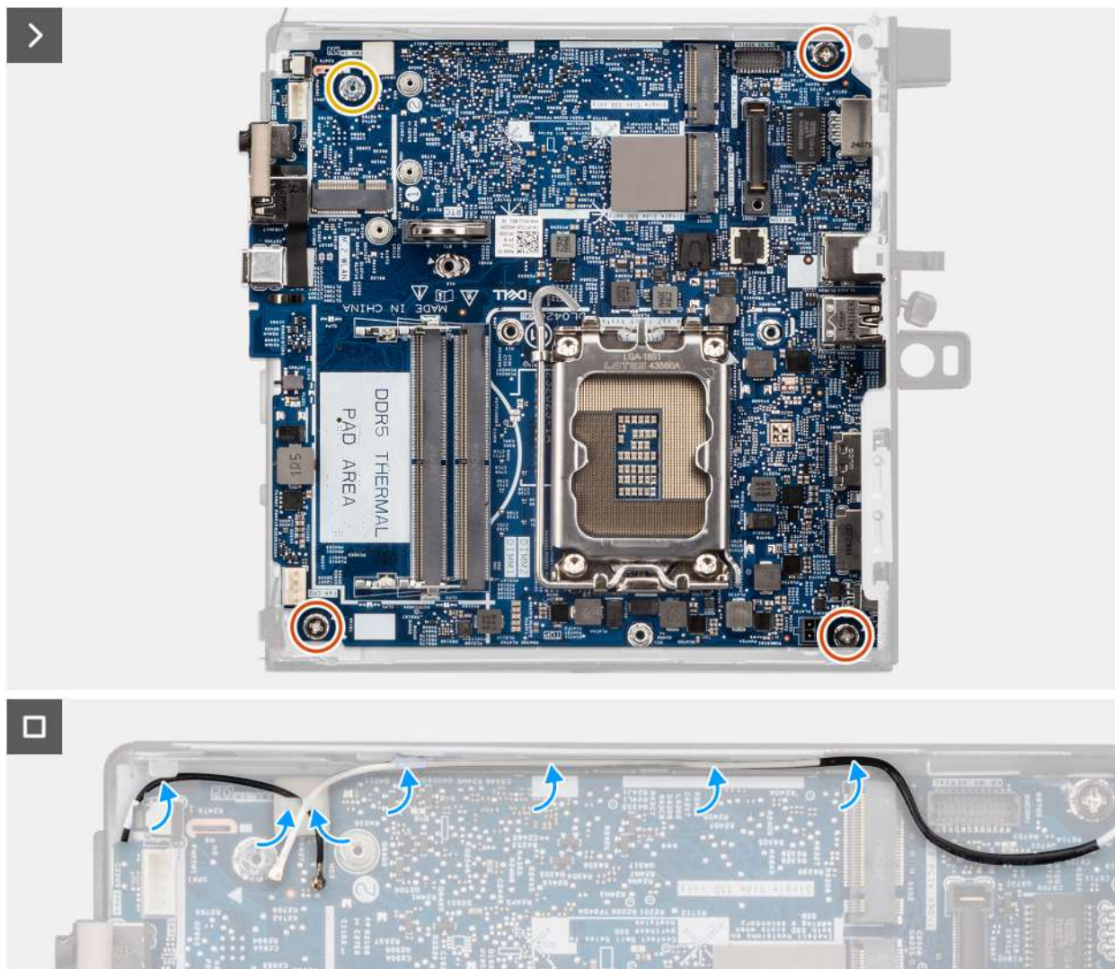
Afbeelding 79. De systeemkaart installeren
