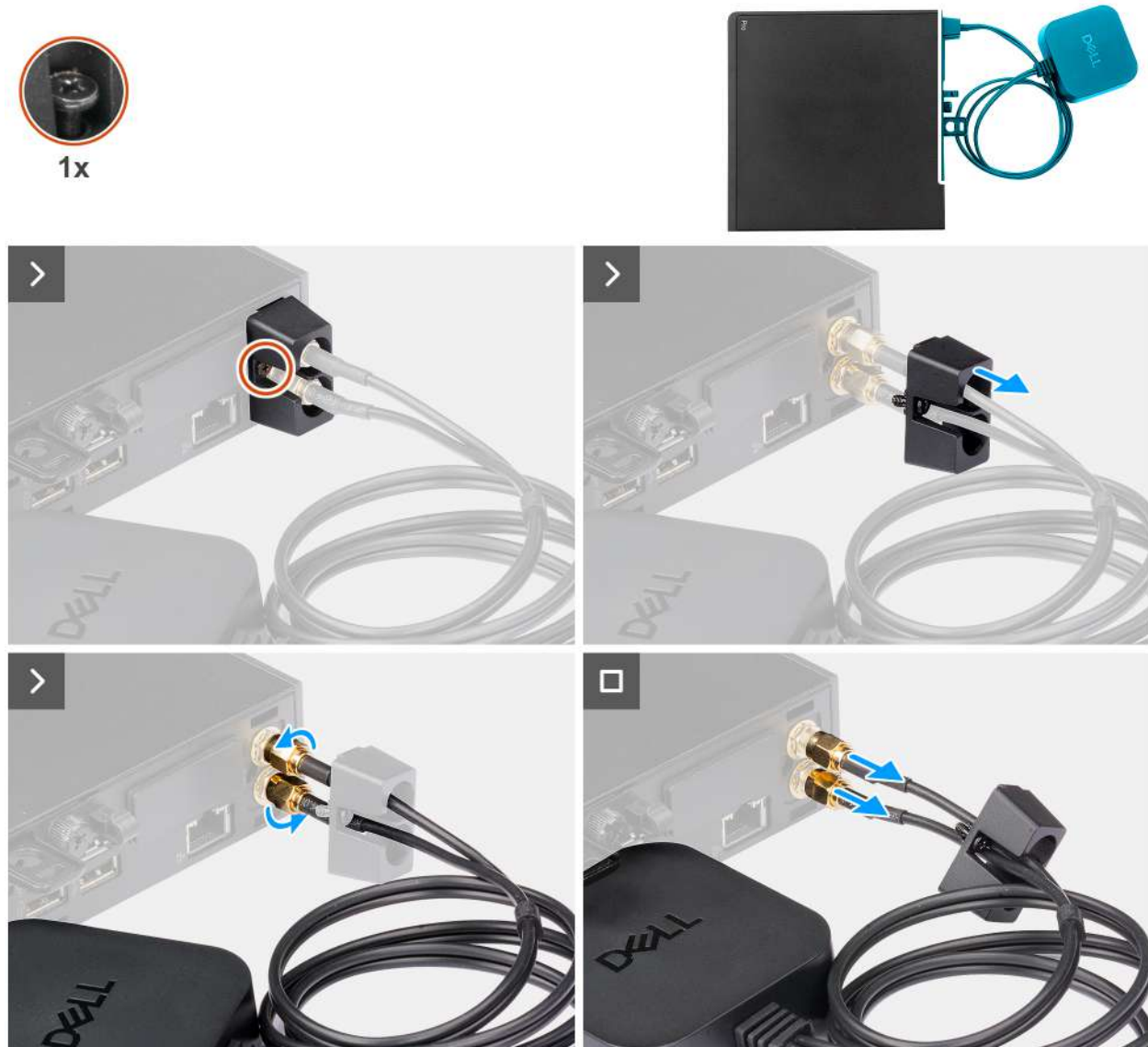
Afbeelding 34. De externe puckantenne verwijderen
