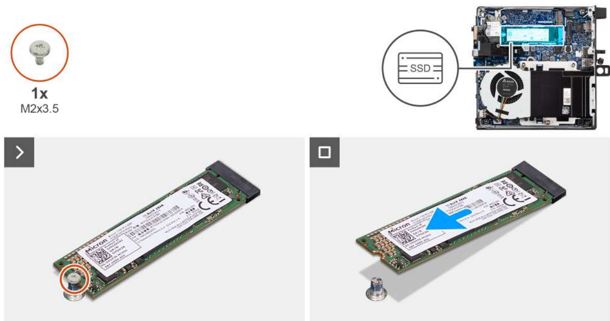
Afbeelding 19. De M.2 2280 SSD verwijderen
