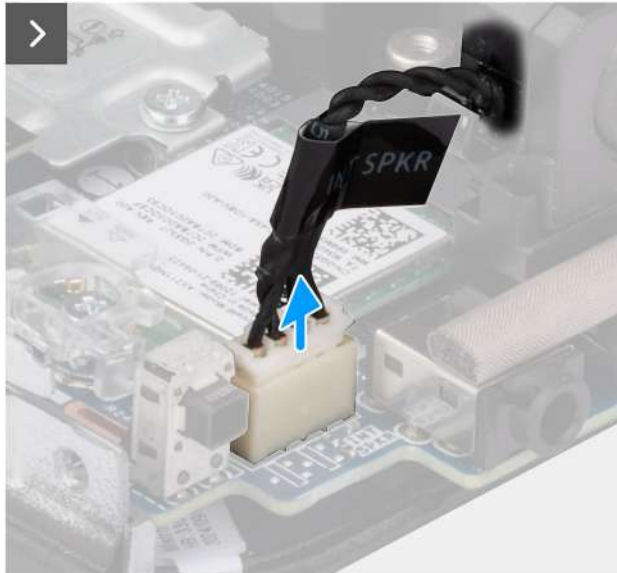
Afbeelding 14. De luidspreker verwijderen
