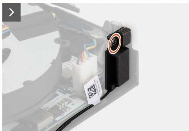
Afbeelding 64. De antennemodule (zwarte kabel) verwijderen
