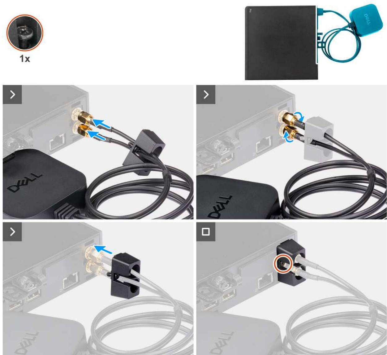
Afbeelding 35. De externe puckantenne installeren
