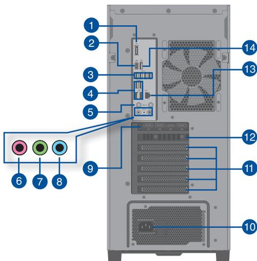
1. **DisplayPort-Anschluss.** Dieser Anschluss ist für DisplayPort-kompatible Geräte.
