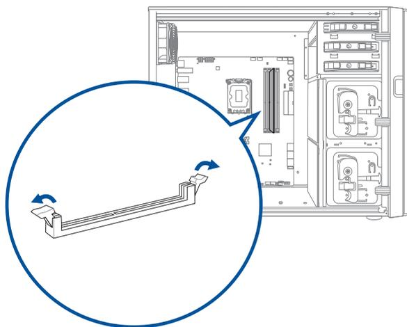
7. Richten Sie die Einkerbung am unteren Rand des DIMMs an der Nase im DIMM-Steckplatz aus, und stecken Sie dann das DIMM fest in den Steckplatz ein, bis der Auswerfer wieder einrastet.
