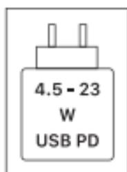
A3287 / A3293: Die vom Ladegerät bereitgestellte Leistung muss zwischen minimal 4,5 Watt für den Betrieb des drahtlosen Geräts und höchstens 23,0 Watt liegen, um die maximale Ladegeschwindigkeit zu erreichen.
