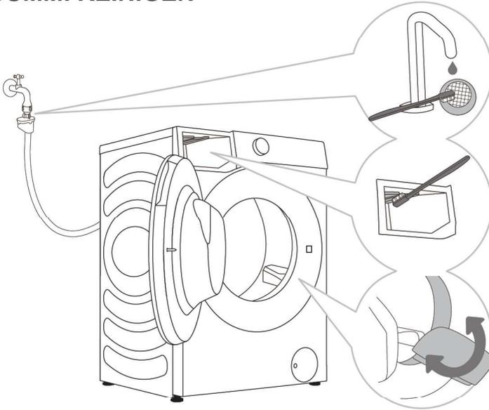
**1** Reinigen Sie den Netz-1-Filter häufig unter fließendem Wasser.
