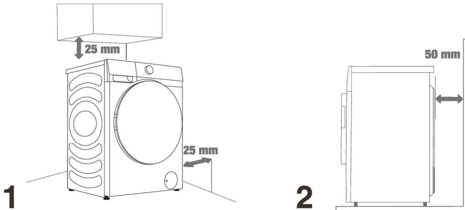
⚠ Das Gerät darf nicht mit einer Wand oder einem Möbelstück in Berührung kommen. Um einen optimalen Betrieb zu gewährleisten, lassen Sie um den Waschtrockner herum etwas Platz, wie in der Abbildung angegeben.
