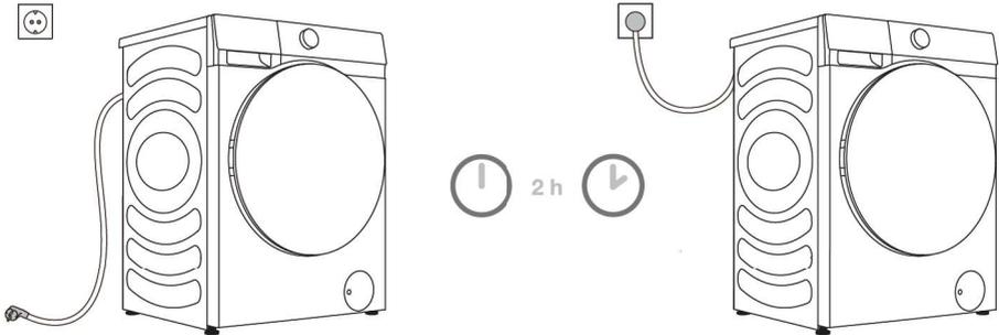
**⚠** Bevor Sie den Wäschetrockner am Stromnetz anschließen, warten Sie mindestens 2 Stunden, bis sie Raumtemperatur erreicht hat.
