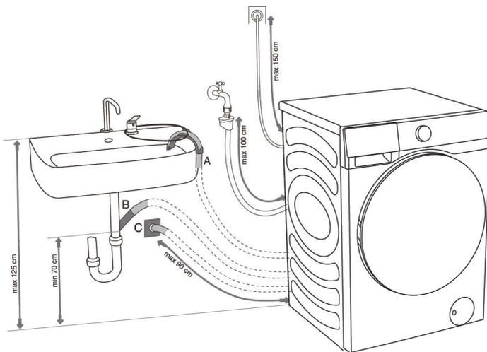
**A** Das Ende des Ablaufschlauchs kann über ein Waschbecken oder eine Badewanne gelegt werden. Verwenden Sie einen Spangurt, um den Schlauch durch den Ellbogen zu sichern, damit er nicht verrutscht.
