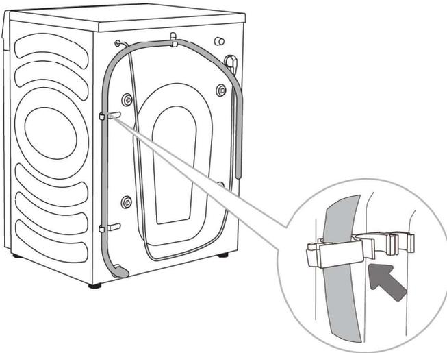
**D** Der Abflussschlauch muss am Haken auf der Rückseite des Waschtrockners befestigt werden, wie in der Abbildung gezeigt.
