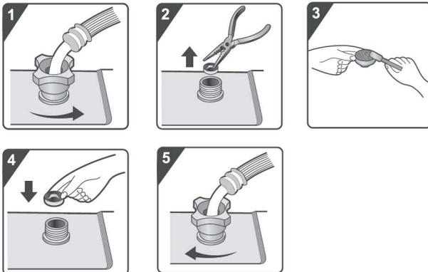
**1** Schließen Sie den Wasserhahn und schrauben Sie den Zulaufschlauch auf der Rückseite des Geräts ab.
