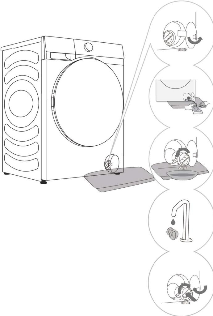
**1** Öffnen Sie den Deckel des Pumpenfilters.
