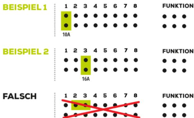
Abbildung 9. Beispiele Steckbrückenposition
