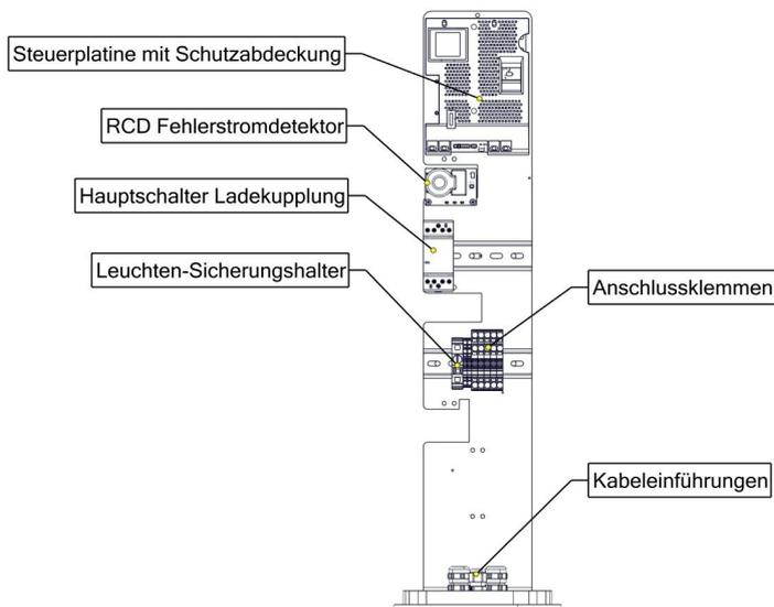
Abbildung 1. Vorderseite des Geräteträgerblech
