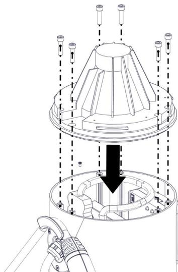
Abbildung 19. Montage Leuchtaufnahme
