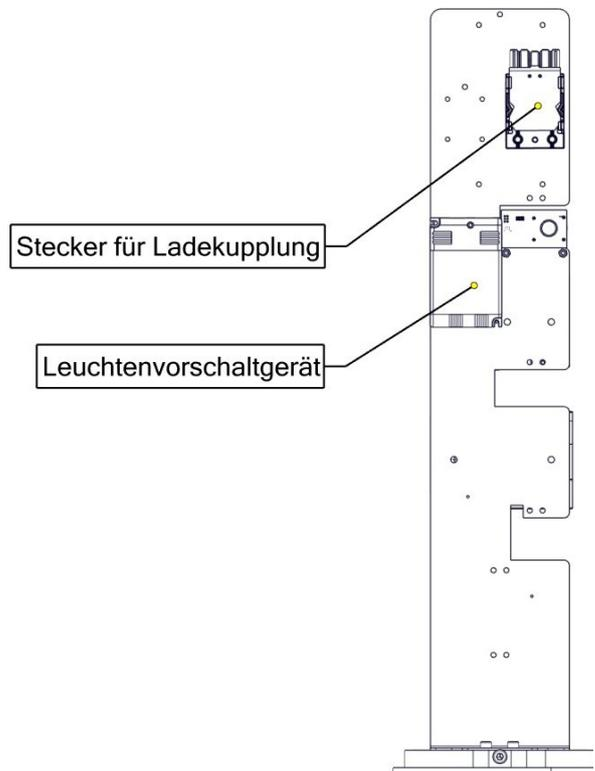
Abbildung 2. Rückseite des Geräteträgerblech
