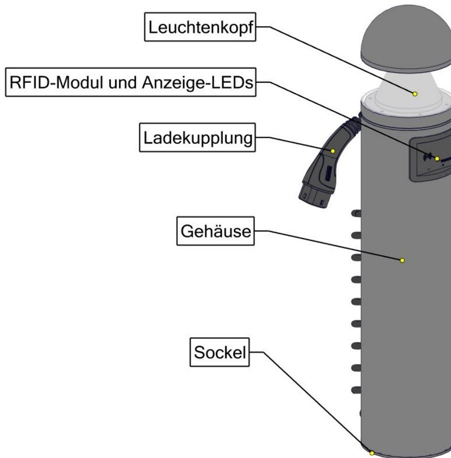
Abbildung 3. Komponenten der GAMMA
