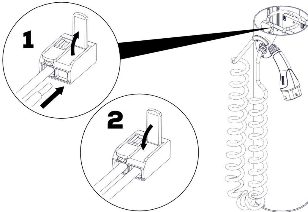
Abbildung 15. Anschluss der CP-Leitung
