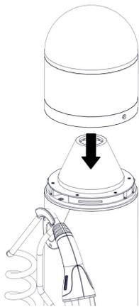
Abbildung 22. Montage Leuchtenabdeckung
