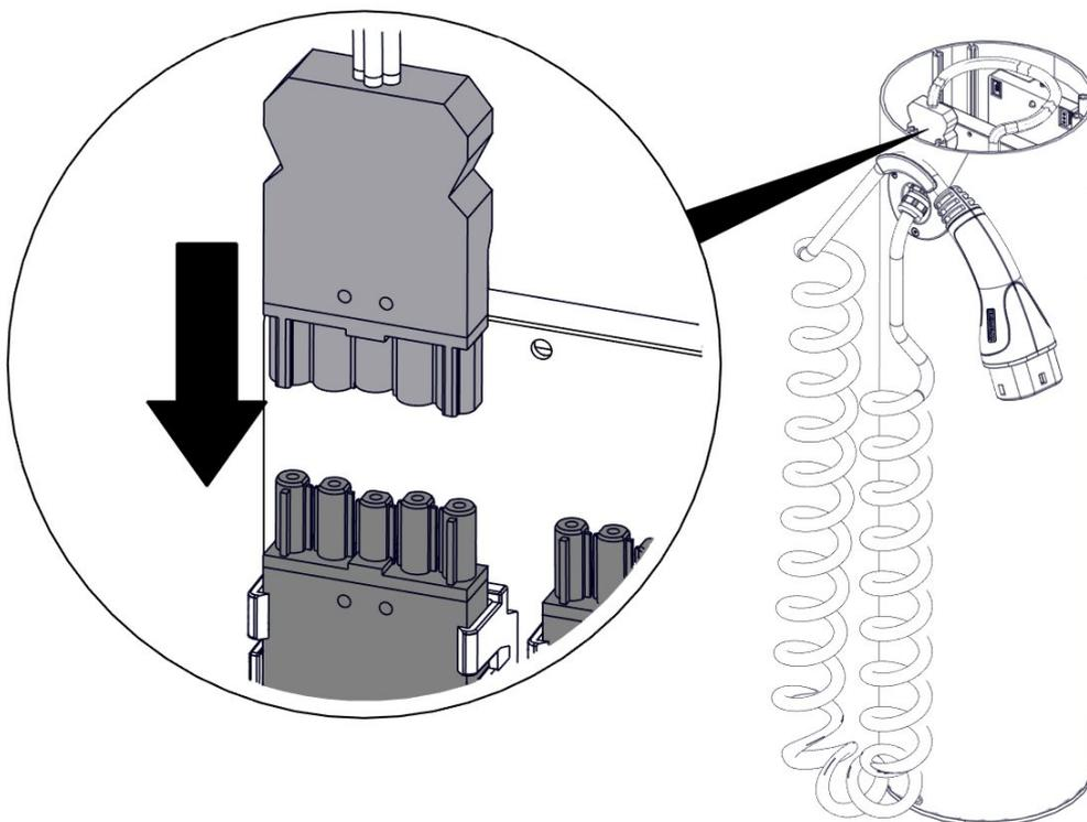
Abbildung 16. Anschluss der Ladeleitungen
