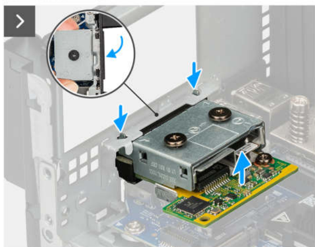
Abbildung 33. Entfernen des optischen 5G-Glasfaseranschlusses
