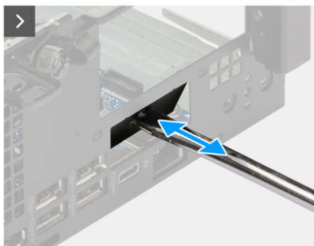
Abbildung 40. Einbauen des Thunderbolt-Anschlusses
