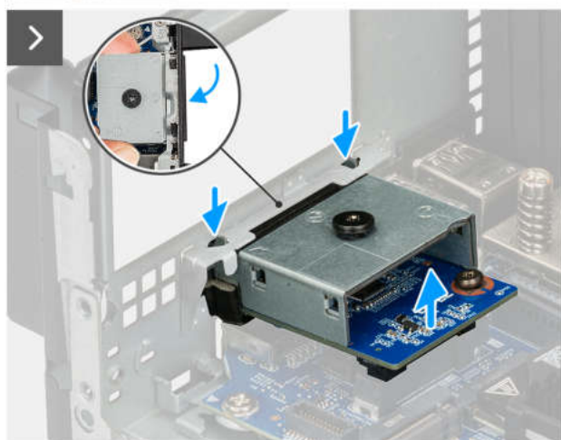
Abbildung 45. Entfernen des HDMI-Anschlusses
