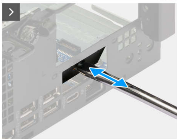
Abbildung 43. Einbauen des HDMI-Ports
