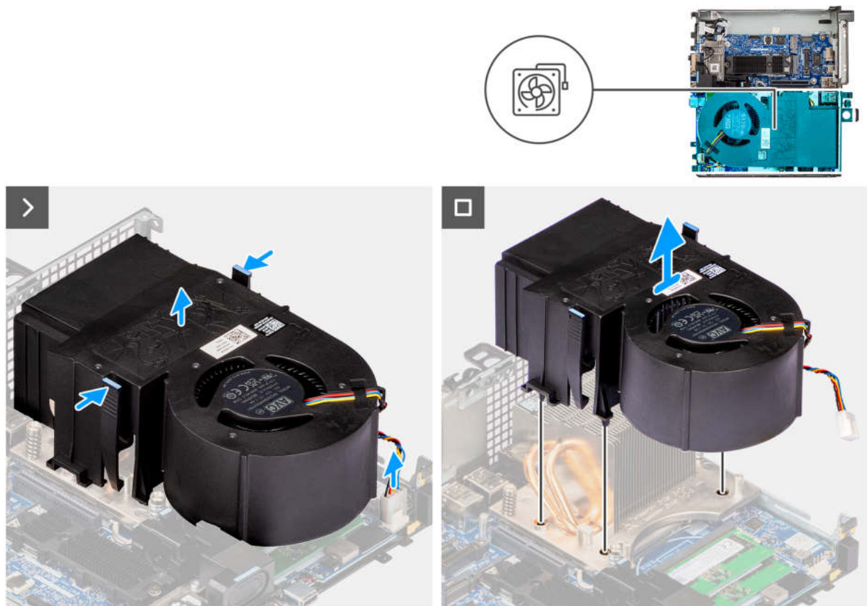
Abbildung 15. Entfernen des Systemlüfters
