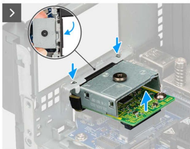
Abbildung 39. Entfernen des DisplayPorts
