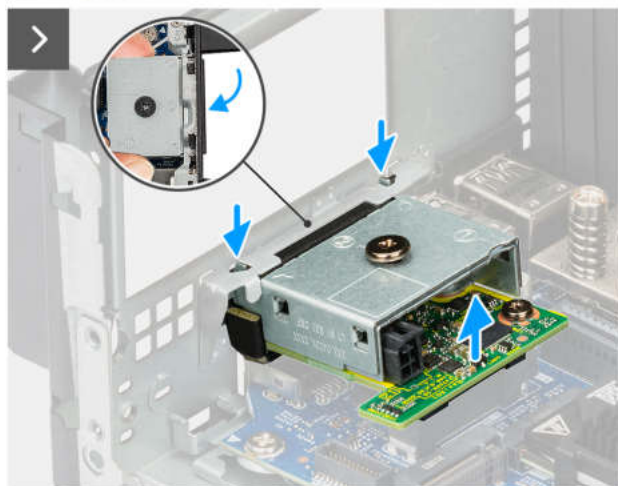
Abbildung 42. Entfernen des Thunderbolt-Anschlusses
