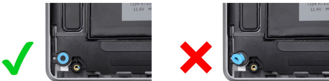
Abbildung 24. Installation der Gummidichtungen
