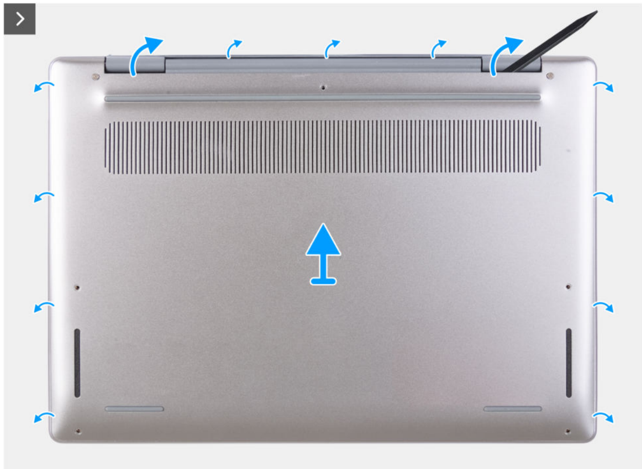
Abbildung 11. Entfernen der Bodenabdeckung
