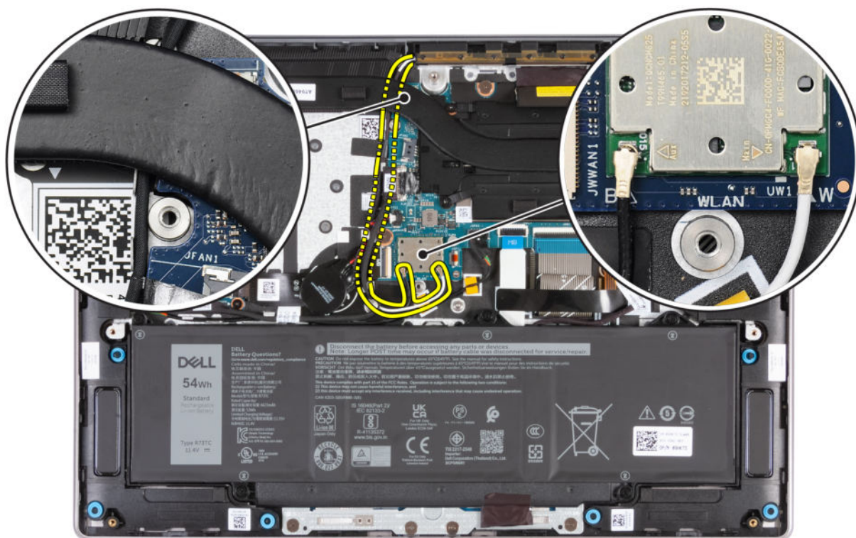
Abbildung 44. Installieren der WLAN-Antennenkabel
