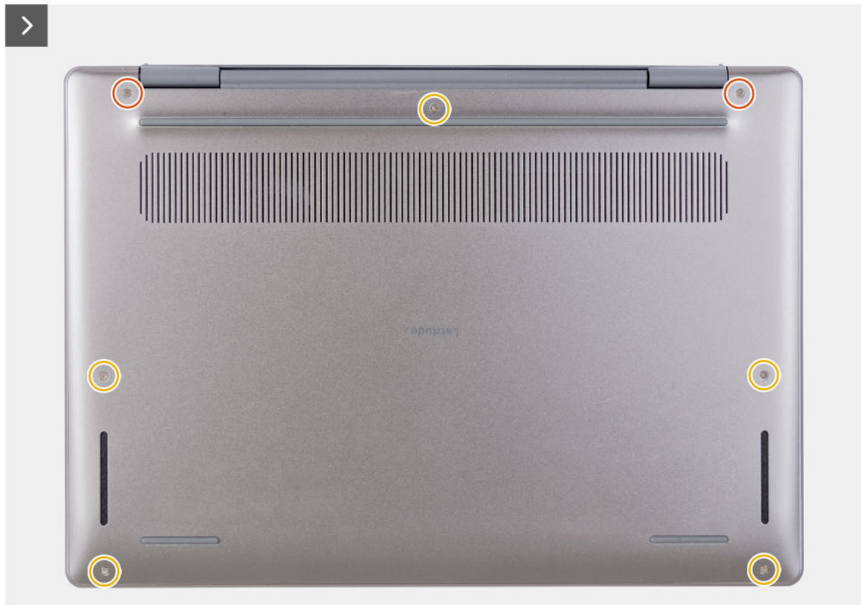
Abbildung 10. Entfernen der Bodenabdeckung
