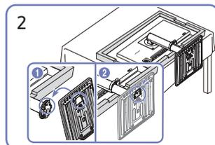
Setzen Sie den Standfuß in die Halterung für den Standfuß in der in der Abbildung gezeigten Richtung ein.
