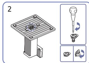
Drehen Sie die Befestigungsschraube unten am Standfuß bis zum Anschlag, damit er sicher befestigt ist.
