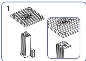
Stellen Sie den Standfuß in der in der Abbildung gezeigten Richtung auf den Standfußanschluss. Vergewissern Sie sich, dass der Standfußanschluss fest verbunden ist.
