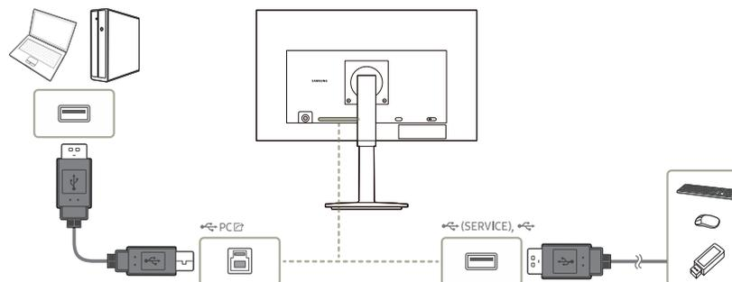
— Um ein USB-Gerät schneller erkennen und starten zu können, schließen Sie das USB-Gerät an den -Anschluss des Geräts an. Die Lese/ Schreibgeschwindigkeit wird von Ihrem USB-Gerät und Computer beeinflusst.
