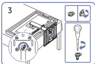
Drehen Sie die Befestigungsschraube unten am Standfuß bis zum Anschlag, damit er sicher befestigt ist.
