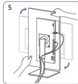
Drehen Sie das Gerät in die horizontale Position.
