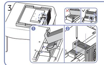
Legen Sie zuerst als Schutz ein weiches Tuch auf den Tisch und dann das Gerät mit der Vorderseite nach unten darauf. Schieben Sie den montierten Standfuß in Pfeilrichtung (siehe Abbildung) in das Gerätegehäuse hinein. Drehen Sie die Befestigungsschraube in der Mitte des Standfußanschlusses fest, damit er sicher befestigt ist.
