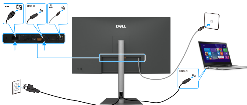
Afbeelding 34. De monitor aansluiten voor RJ45-kabel
