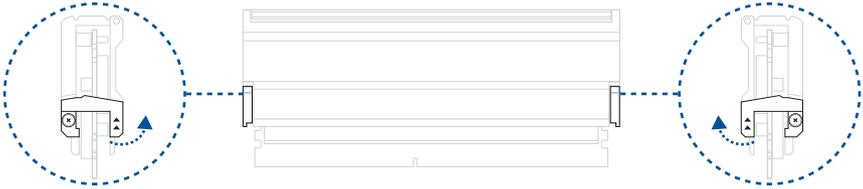
2. Klappen Sie die Abdeckung der ROG Q-DIMM.2-Karte nach oben.
