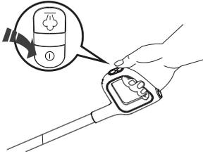
Drücken Sie ①, das Gerät startet standardmäßig im AUTO-Modus. Drücken Sie dann ②, um in den DAMPF-Modus, den DAMPFSTOß-Modus oder den AUTO-Modus zu wechseln. Drücken Sie erneut ①, um das Gerät nach Abschluss der Reinigung auszuschalten.
