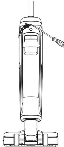
Falls der Griff gelöst werden muss, drücken Sie die Feder mit einem Werkzeug (z. B. einem Schraubendreher) und nehmen Sie den gelösten Griff vom Gerät ab.
