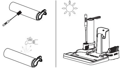
Verwenden Sie das Reinigungswerkzeug, um Haare und Verschmutzungen zu entfernen, die sich um die Bürstenrolle gewickelt haben, und spülen Sie sie mit Wasser ab. Setzen Sie die Bürstenrolle wieder in den Zubehöralter ein, nachdem sie vollständig getrocknet ist.
