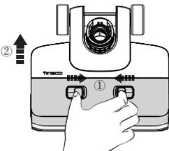
Drücken Sie die Verriegelung der Abdeckung zusammen und ziehen Sie die Abdeckung zum Entfernen nach oben.
