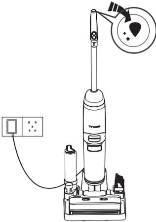
1. Stellen Sie das Gerät nach Gebrauch auf die Ladestation. Der Sensor erkennt automatisch den Verschmutzungsgrad.
