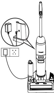
Um das Gerät aufzuladen, stellen Sie es auf die Ladestation und schließen Sie das Steckernetzteil an einer Steckdose an.
