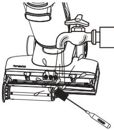
Waschen Sie das Bürstenrollenfach mit Wasser und dem Reinigungswerkzeug aus und entfernen Sie Haare und Verschmutzungen.
