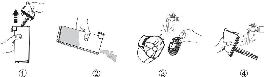
Wenn der Deckel des Schmutzwasserbehälters und der Filter verstopft sind, nehmen Sie Tankdeckel und Filter ab und spülen Sie beides mit Wasser aus.
