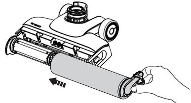
Setzen Sie die Bürstenrolle wieder ein, indem Sie ihr Ende in die linke Seite des Halters einführen und dann die Nase der Bürstenrolle am Magnetverschluss auf der rechten Seite befestigen, um sie einzurasten.
