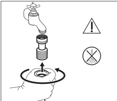
**Zum Schutz des Trinkwassers muss das beiliegende Rückschlagventil zwischen dem Wasserhahn und dem Wasserversorgungsschlauch installiert werden.** Dieses Ventil darf nicht am Gerät montiert werden. Stellen Sie den Schlauch richtig ein.
