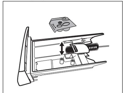
3. Stellen Sie sicher, dass alle Waschmittelreste an der Ober- und Unterseite der Aufnahme entfernt wurden. Reinigen Sie die Schubladenaufnahme mit einer kleinen Bürste.
