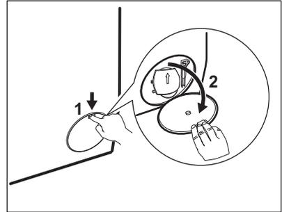
2. Stellen Sie einen geeigneten Behälter unter die Öffnung der Ablaufpumpe, um das abfließende Wasser aufzufangen.
