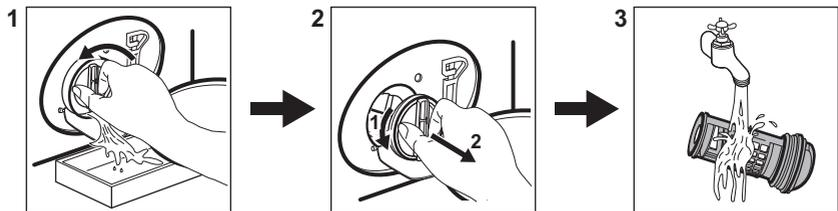
Reinigen Sie das Sieb regelmäßig und insbesondere, wenn der Fehlercode **E20** im Display angezeigt wird.
