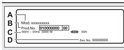
Das **Typenschild** gibt den Modellnamen (**A**), die Produktnummer (**B**), die elektrischen Nennwerte (**C**) und die Seriennummer (**D**) an.
