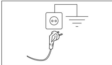
Nach der Installation des Geräts muss das Netzkabel leicht zugänglich sein.
