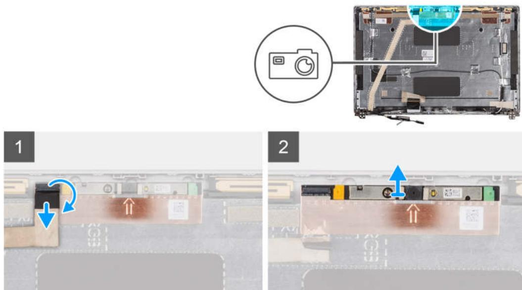
Abbildung 1. Entfernen des Kameramoduls
