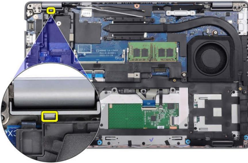
2. Bringen Sie die zehn Schrauben (M2x3) zur Befestigung des inneren Montagerahmens an der Hauptplatine und der Handauflagenbaugruppe wieder an.
