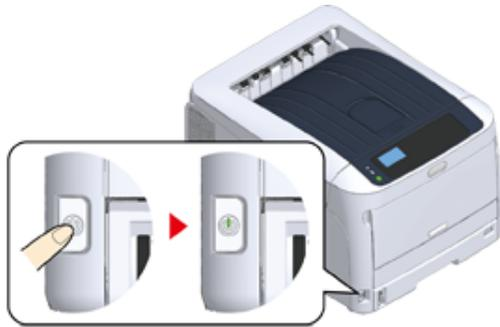
Die LED-Anzeige des Netzschalters leuchtet, wenn der Drucker eingeschaltet ist. Die Meldung "Bereit zum Drucken" wird im Bedienfeld angezeigt, sobald der Drucker druckbereit ist.
