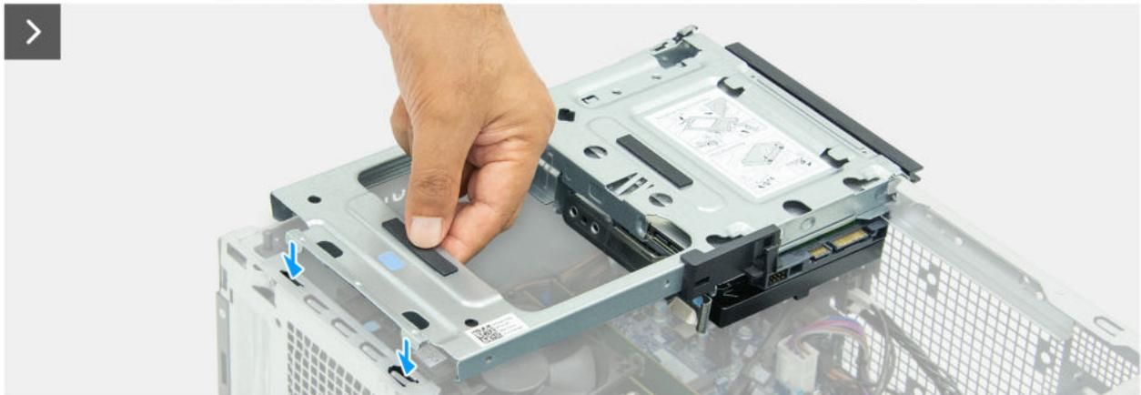
Abbildung 59. Installieren des Laufwerksschachts
