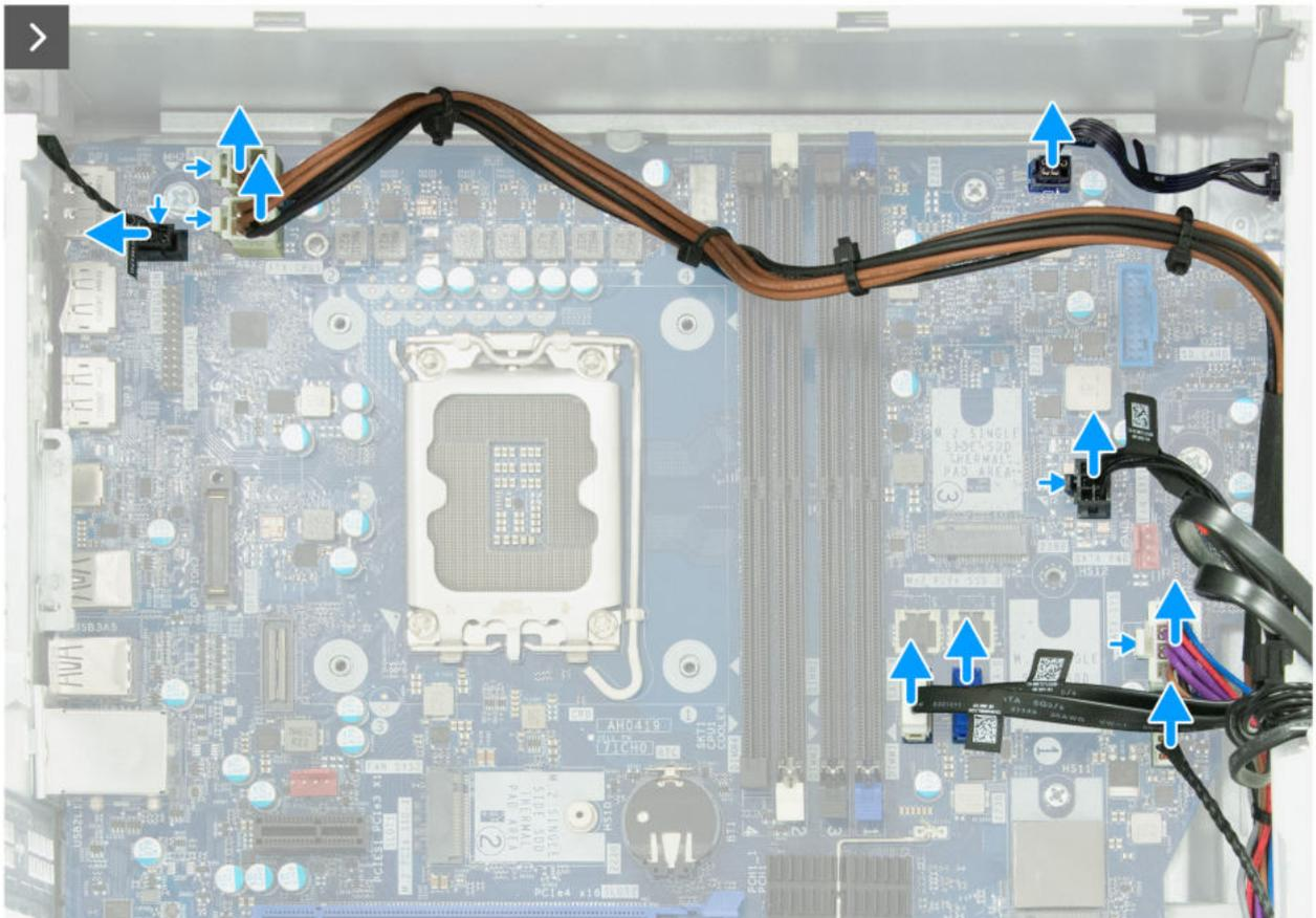
Abbildung 96. Entfernen der Systemplatine
