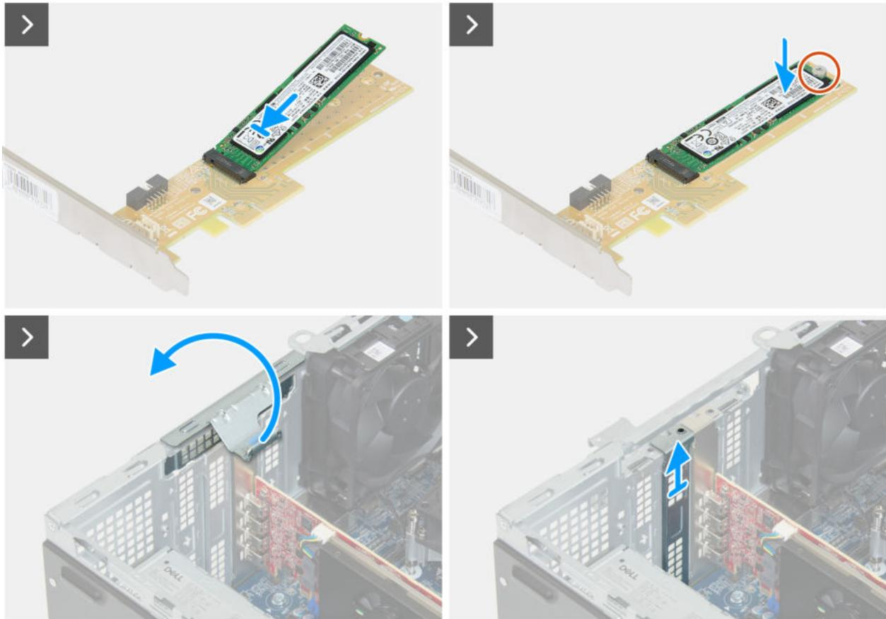
Abbildung 47. Installieren der Halterung der Solid-State-Laufwerk-Erweiterungskarte
