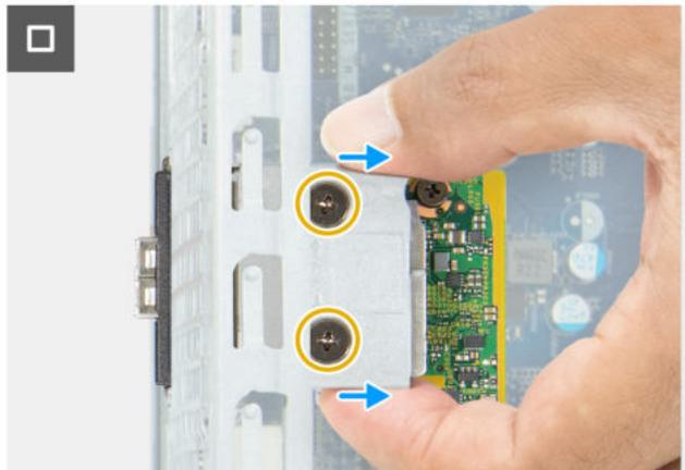
Abbildung 78. Installieren des Glasfaser-Anschlussmoduls
