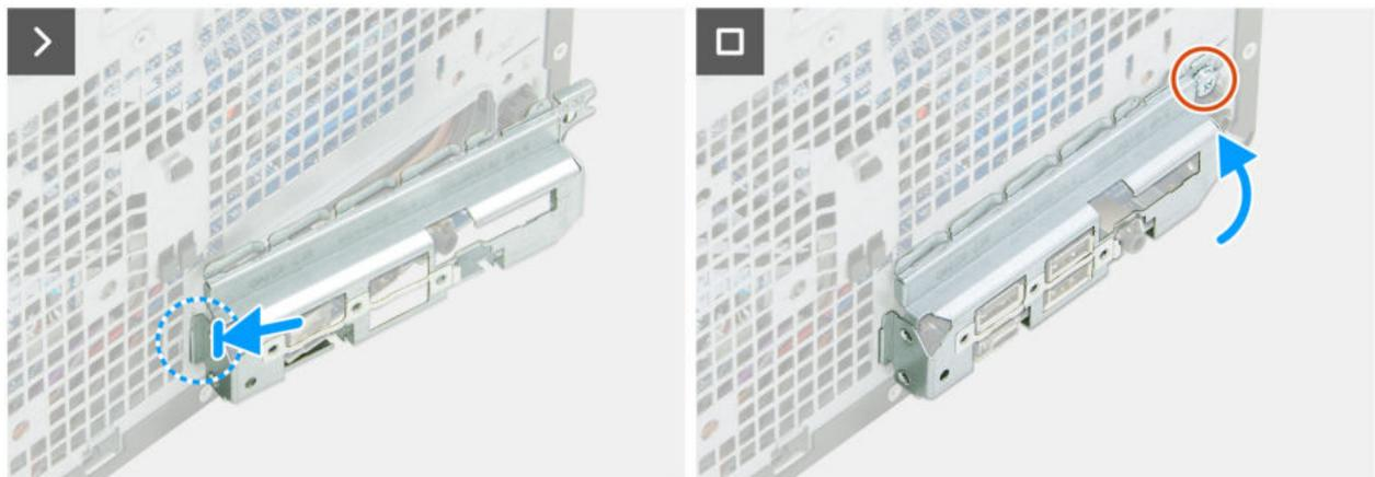
Abbildung 103. Einbauen der Systemplatine
