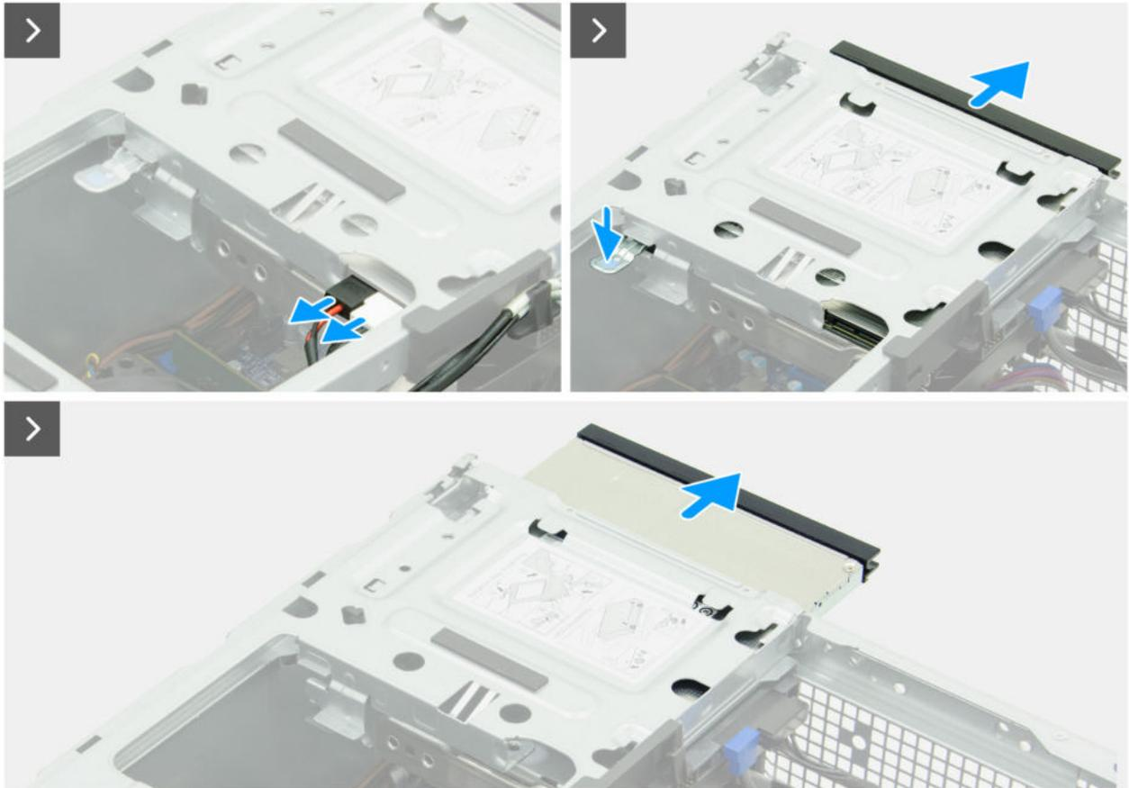
Abbildung 53. Entfernen des optischen Laufwerks
