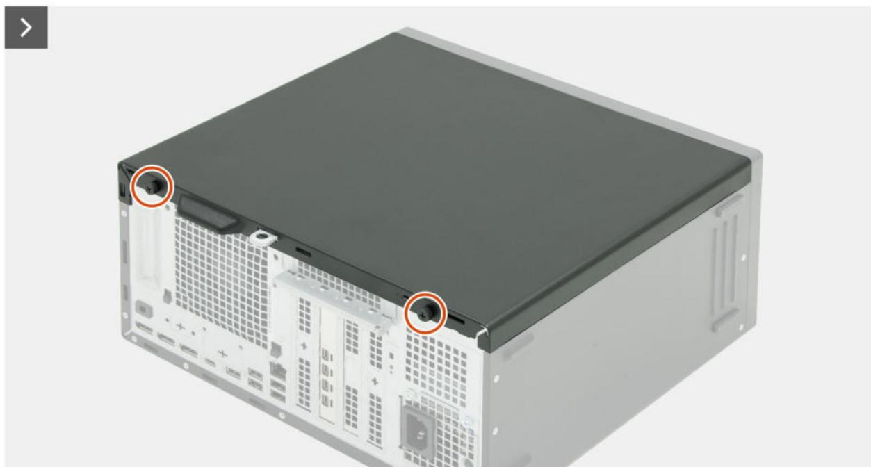
Abbildung 12. Entfernen der linken Abdeckung
