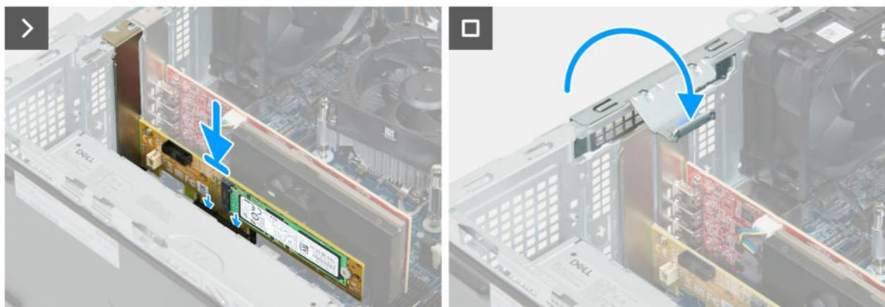
Abbildung 48. Installieren der Halterung der Solid-State-Laufwerk-Erweiterungskarte
