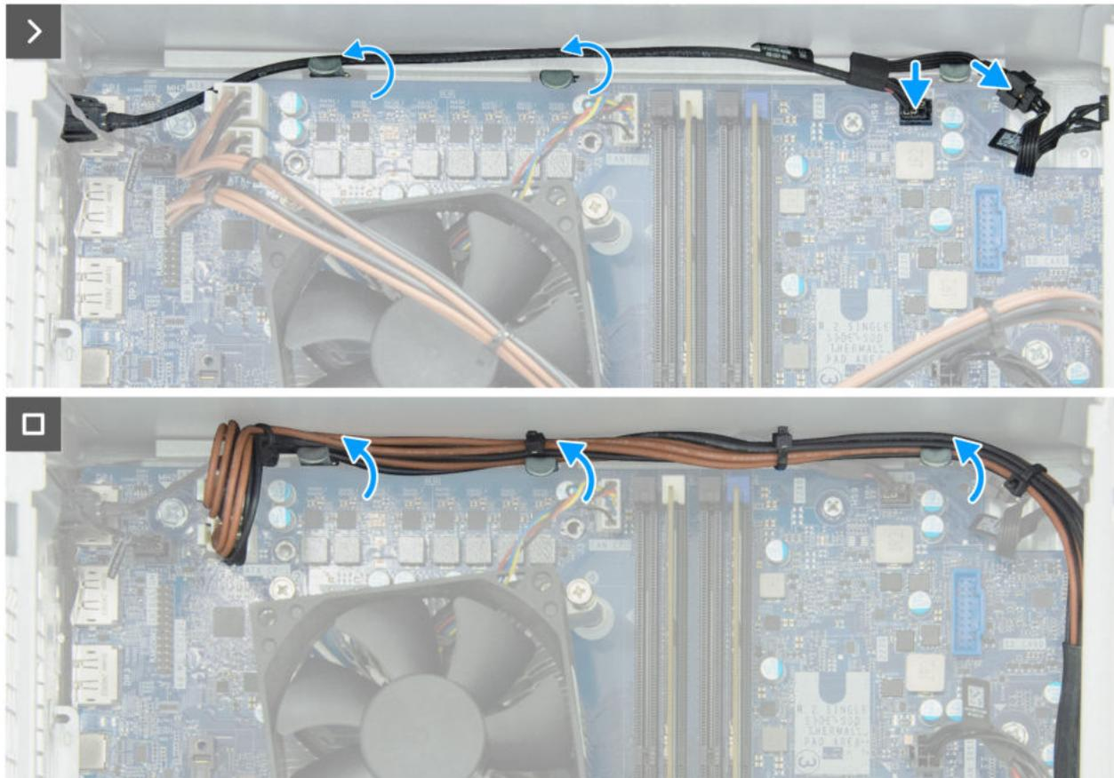
**Abbildung 70. Installieren des Remote-Netzschalterkabels**
