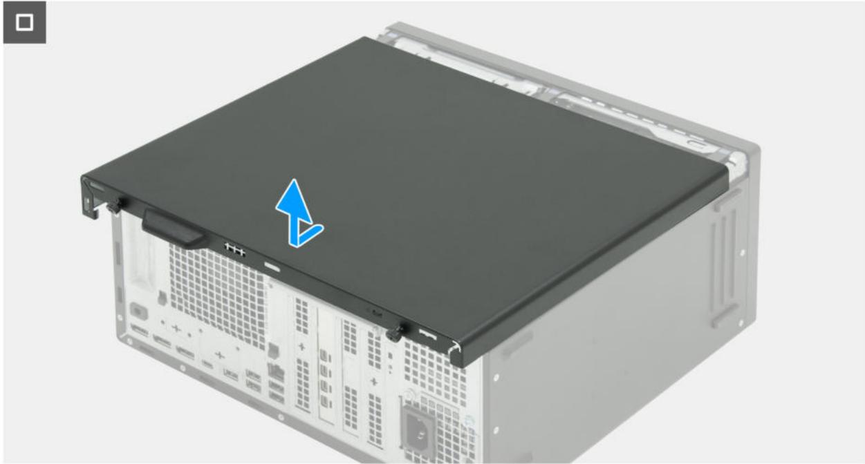
**Abbildung 13. Entfernen der linken Abdeckung**
