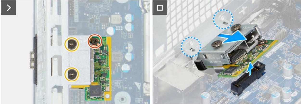
Abbildung 76. Entfernen des Glasfaser-Anschlussmoduls
