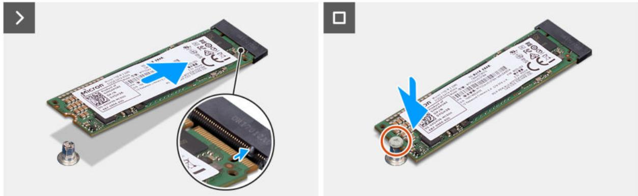
Abbildung 38. Installieren des M.2 2280-Solid-State-Laufwerks in Steckplatz 2
