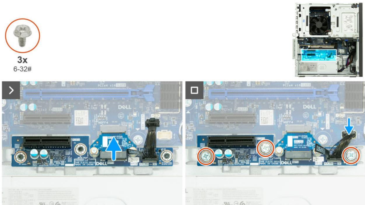
Abbildung 44. Einbauen der PCIe-Erweiterungsplatine
