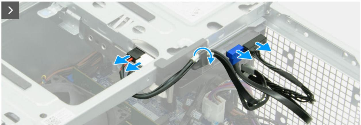
Abbildung 57. Entfernen des Laufwerksschachts
