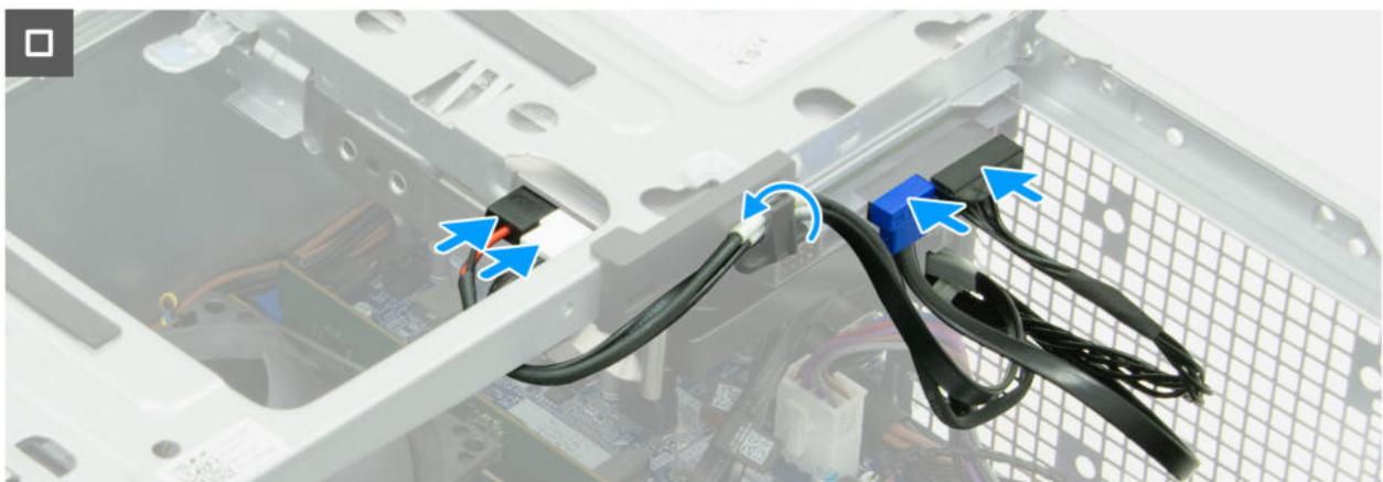
Abbildung 60. Installieren des Laufwerksschachts
