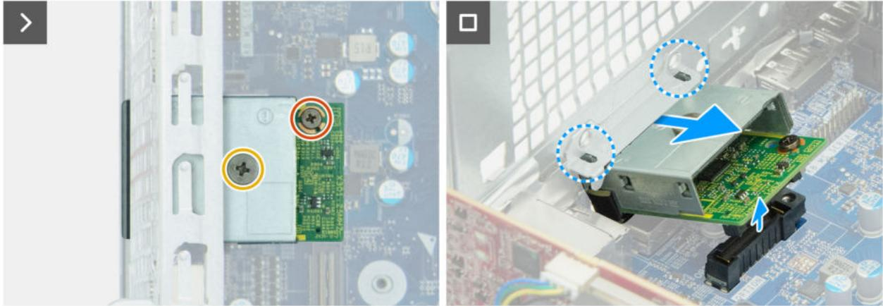
Abbildung 73. Entfernen des optionalen Anschlussmoduls
