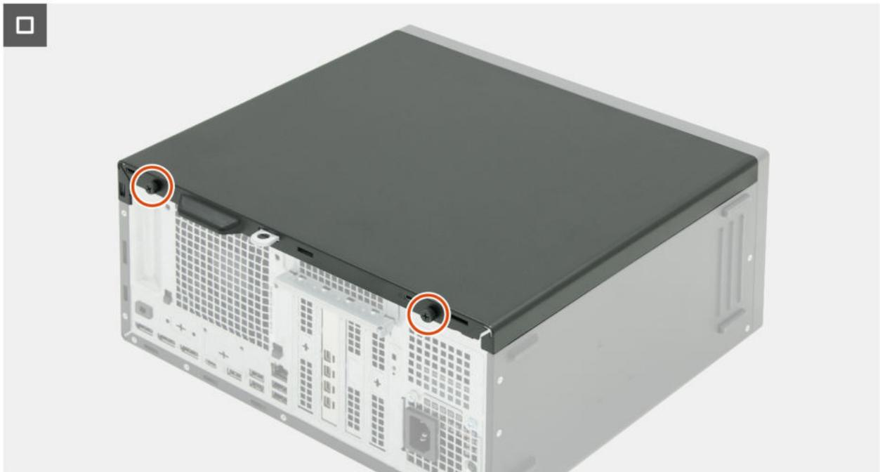
Abbildung 15. Installieren der linken Abdeckung
