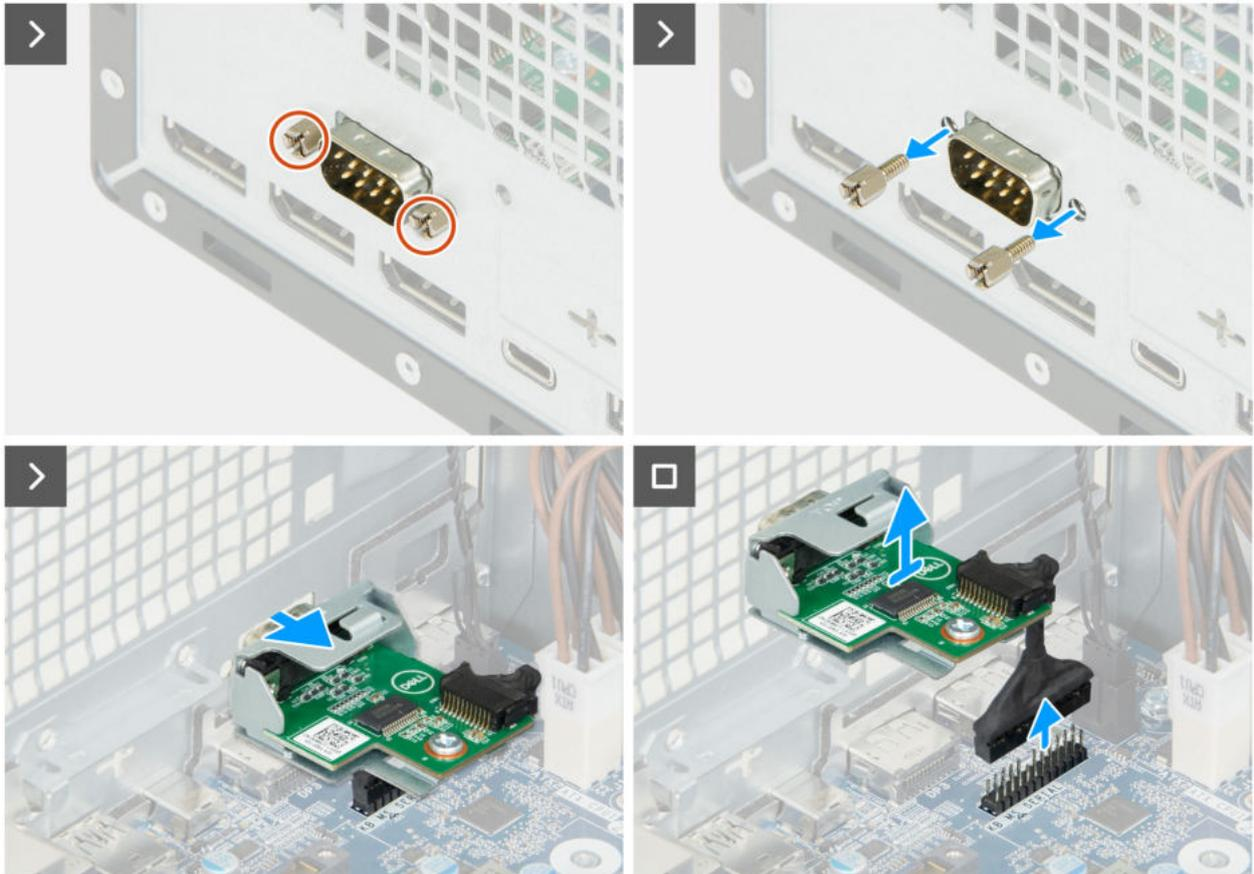
Abbildung 79. Entfernen des Moduls für den seriellen Anschluss
