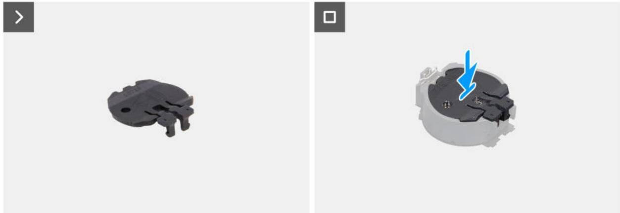
Abbildung 17. Anbringen der Abdeckung der Knopfzellenbatterie
