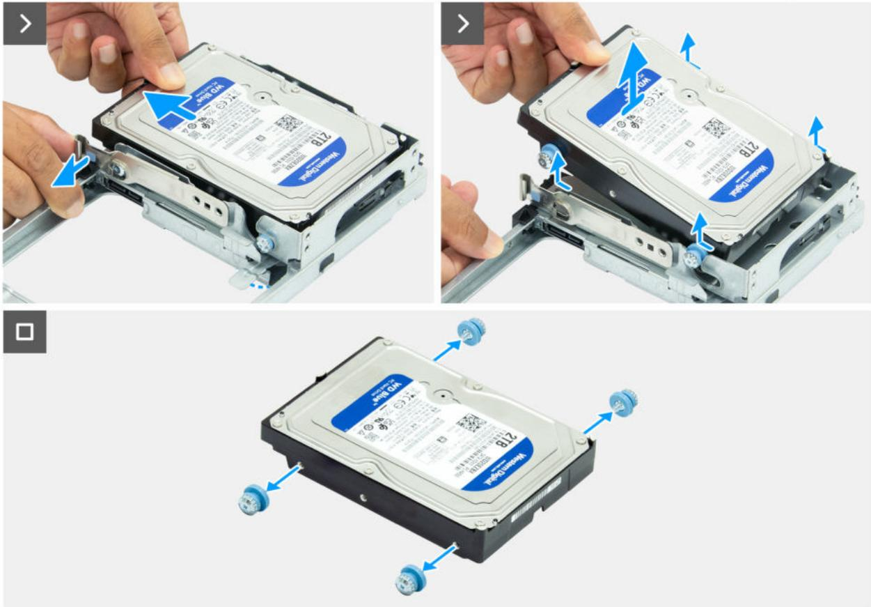
Abbildung 61. Entfernen der Festplatte
