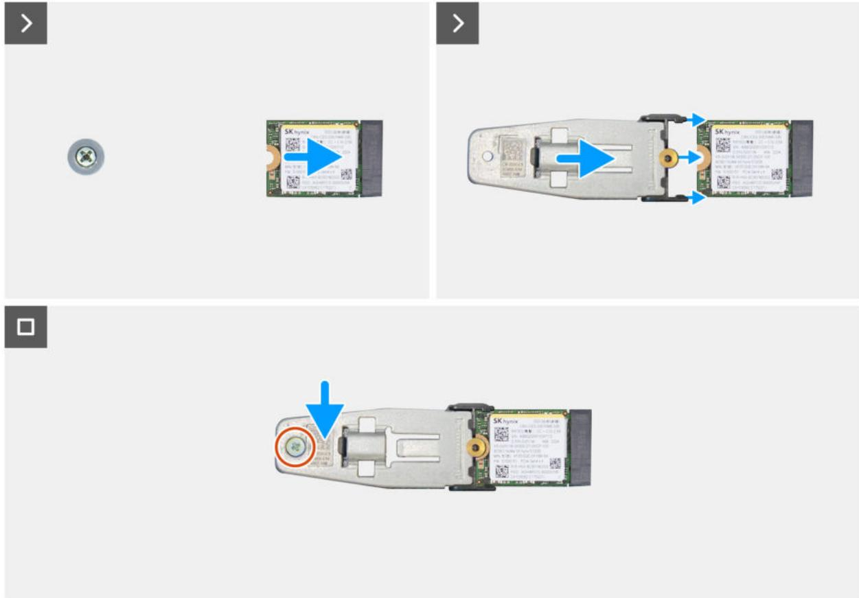
Abbildung 36. Installieren des M.2 2230-Solid-State-Laufwerks in Steckplatz 2
