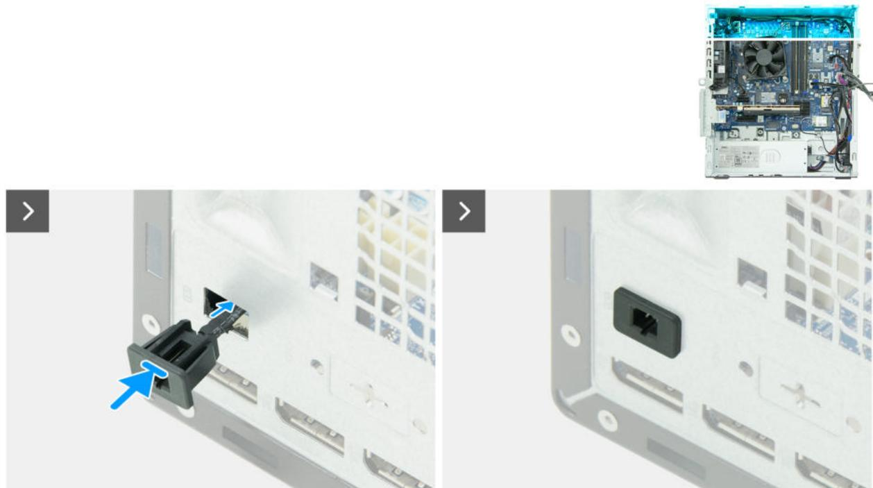
Abbildung 69. Installieren des Remote-Netzschalterkabels
