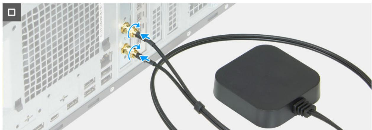
Abbildung 52. Installieren der Puck-Antennen-Erweiterungskarte
