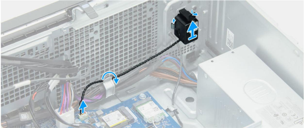
**Abbildung 24. Entfernen des internen Lautsprechers**
