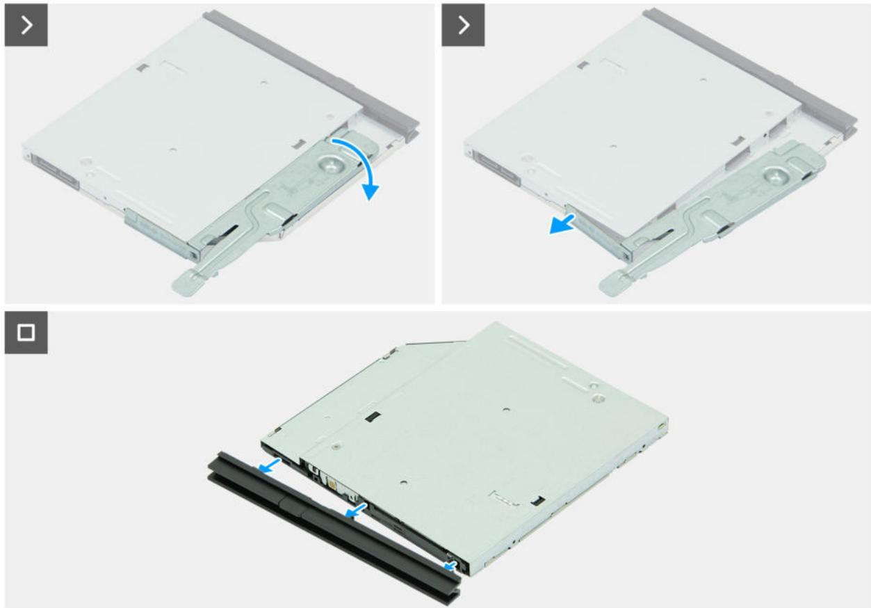
**Abbildung 54. Entfernen des optischen Laufwerks**
