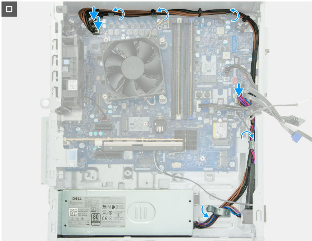
**Abbildung 89. Installieren der Stromversorgungseinheit**
