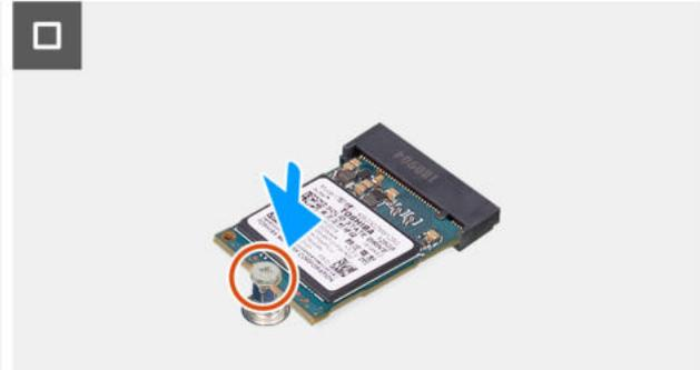
Abbildung 29. Installieren des M.2 2230-Solid-State-Laufwerks in Steckplatz 0
