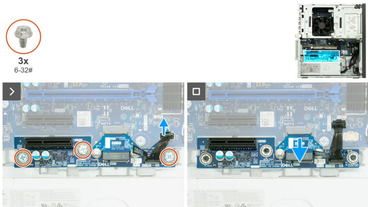
**Abbildung 43. Entfernen der PCIe-Erweiterungsplatine**
