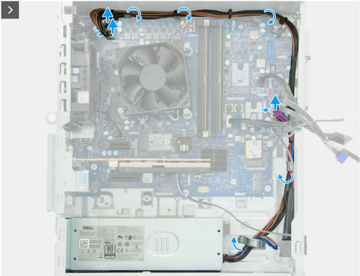
Abbildung 86. Entfernen der Stromversorgungseinheit
