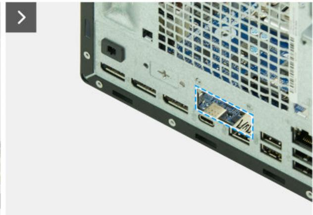
Abbildung 74. Installieren des optionalen Anschlussmoduls
