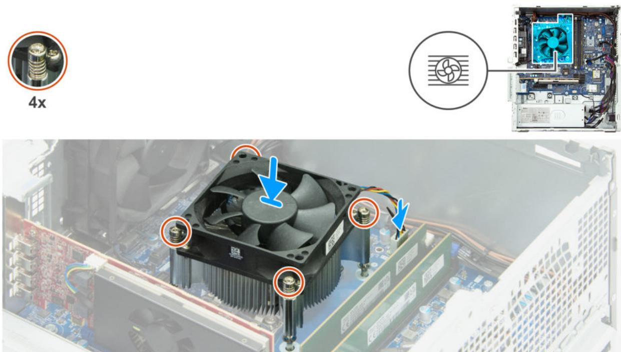
**Abbildung 91. Installieren des Prozessorlüfters und der Kühlkörperbaugruppe**
