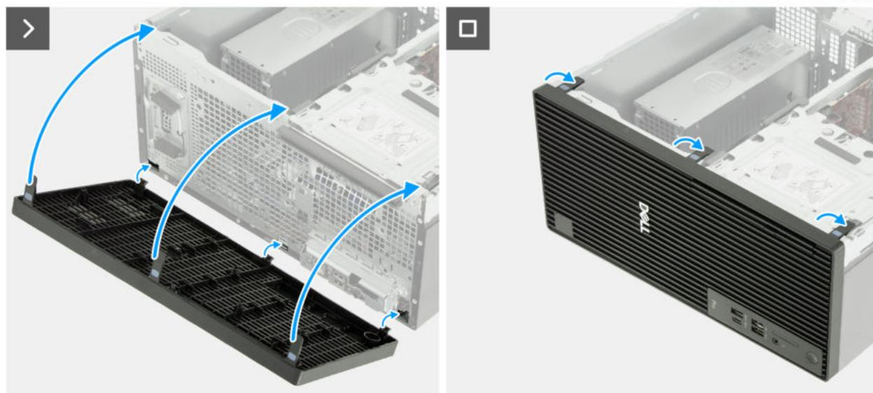
Abbildung 23. Installieren der vorderen Abdeckung
