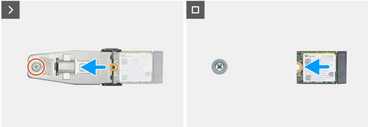
Abbildung 35. Entfernen des M.2-2230-SSD-Laufwerks aus Steckplatz 2
