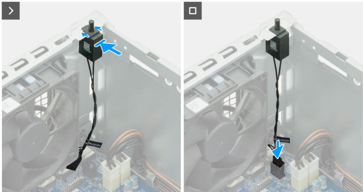
Abbildung 64. Installieren des Eingriffsschalters
