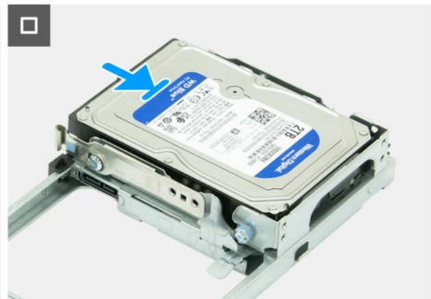
Abbildung 62. Einsetzen des Festplattenlaufwerks
