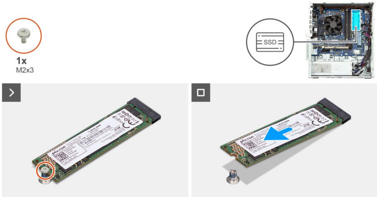
Abbildung 37. Entfernen des M.2-2280-SSD-Laufwerks aus Steckplatz 2
