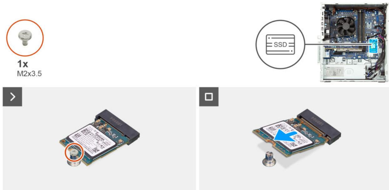
Abbildung 28. Entfernen des M.2-2230-SSD-Laufwerks aus Steckplatz 0
