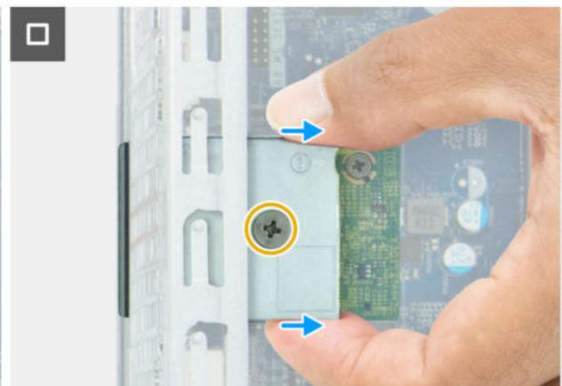
Abbildung 75. Installieren des optionalen Anschlussmoduls
