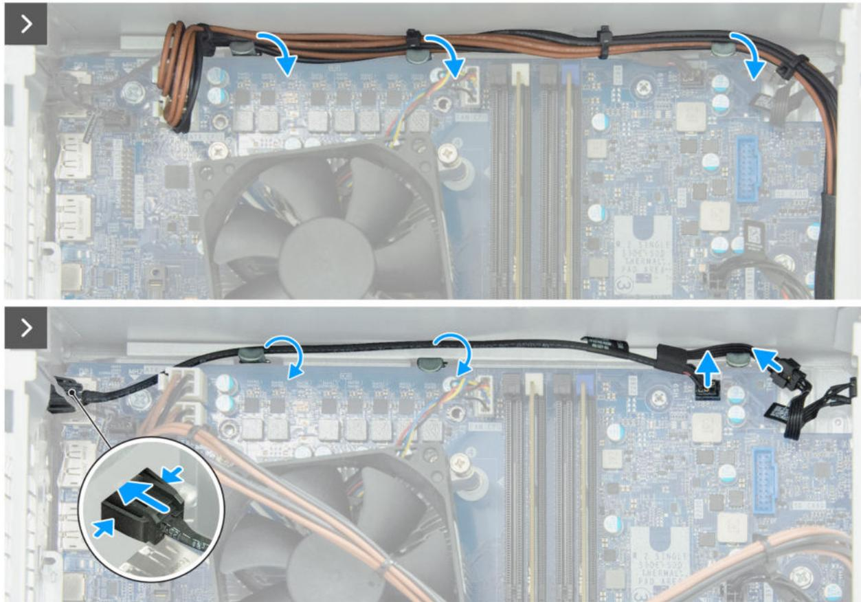
Abbildung 67. Entfernen des Remote-Netzschalterkabels
