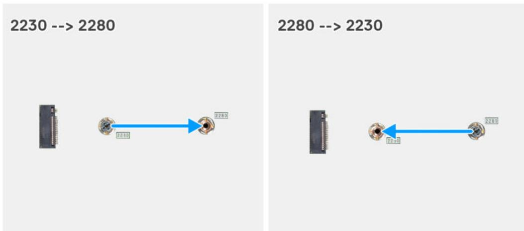
Abbildung 32. Verschieben der Solid-State-Schraubenhalterung auf M.2-Steckplatz 0
