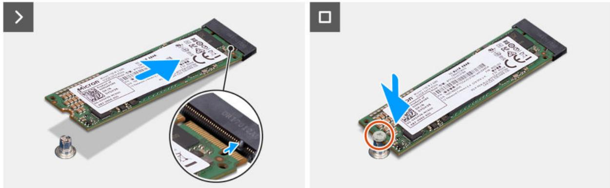
Abbildung 31. Installieren des M.2 2280-Solid-State-Laufwerks in Steckplatz 0
