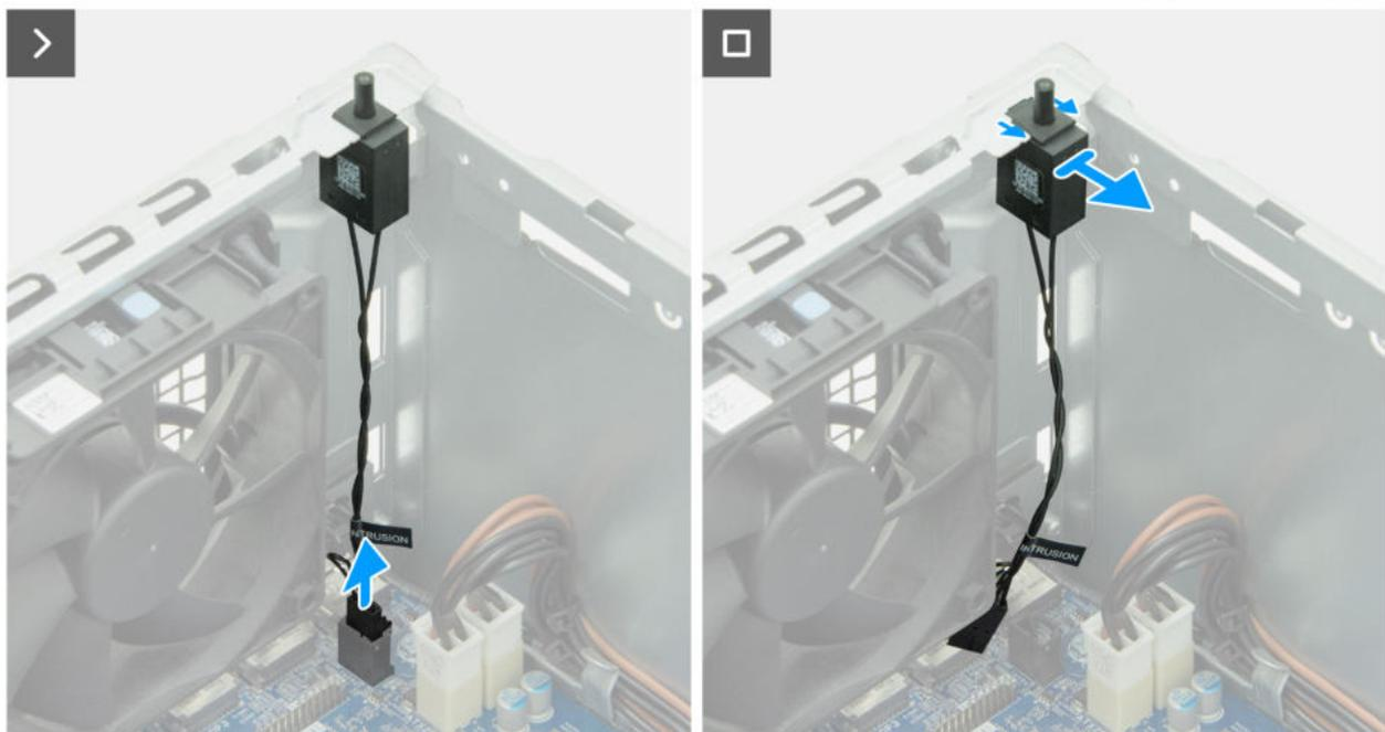
Abbildung 63. Entfernen des Eingriffsschalters
