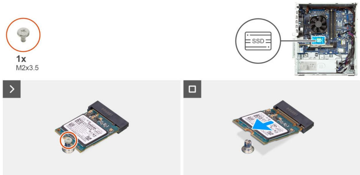
Abbildung 33. Entfernen des M.2-2230-SSD-Laufwerks aus Steckplatz 1
