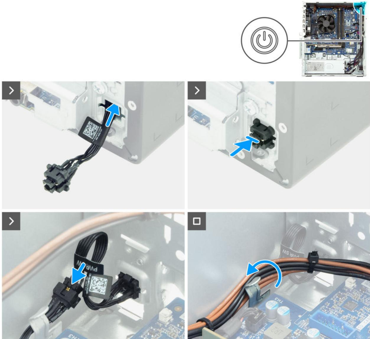
Abbildung 72. Installieren des Netzschalters
