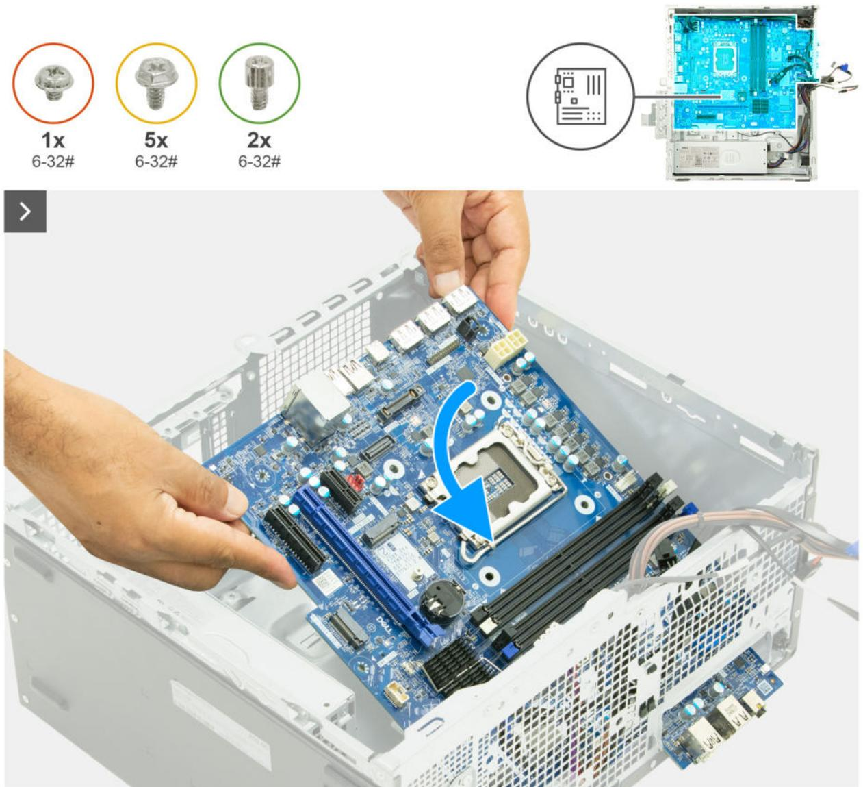
Abbildung 100. Einbauen der Systemplatine
