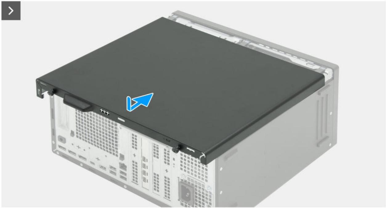
Abbildung 14. Installieren der linken Abdeckung
