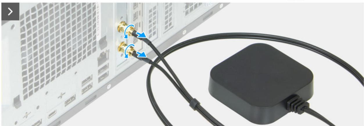
Abbildung 49. Entfernen der Puck-Antennen-Erweiterungskarte
