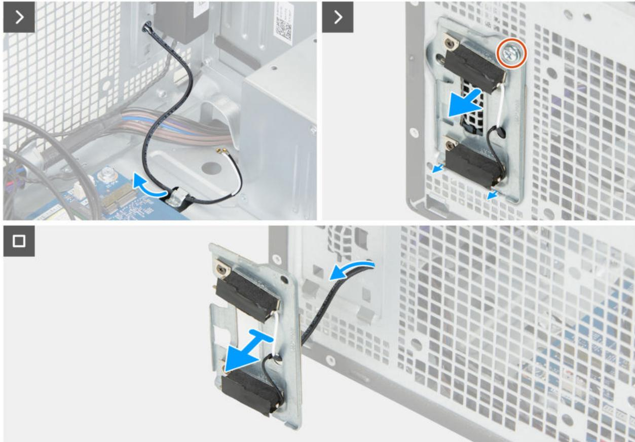
Abbildung 84. Entfernen der Antennenmodule
