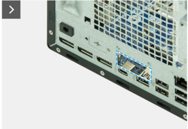
Abbildung 77. Installieren des Glasfaser-Anschlussmoduls
