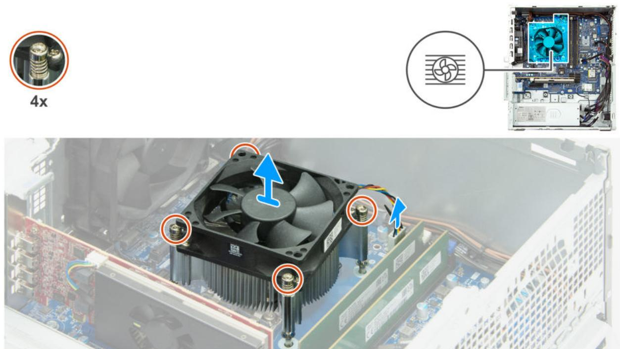
Abbildung 90. Entfernen des Prozessorlüfters und der Kühlkörperbaugruppe
