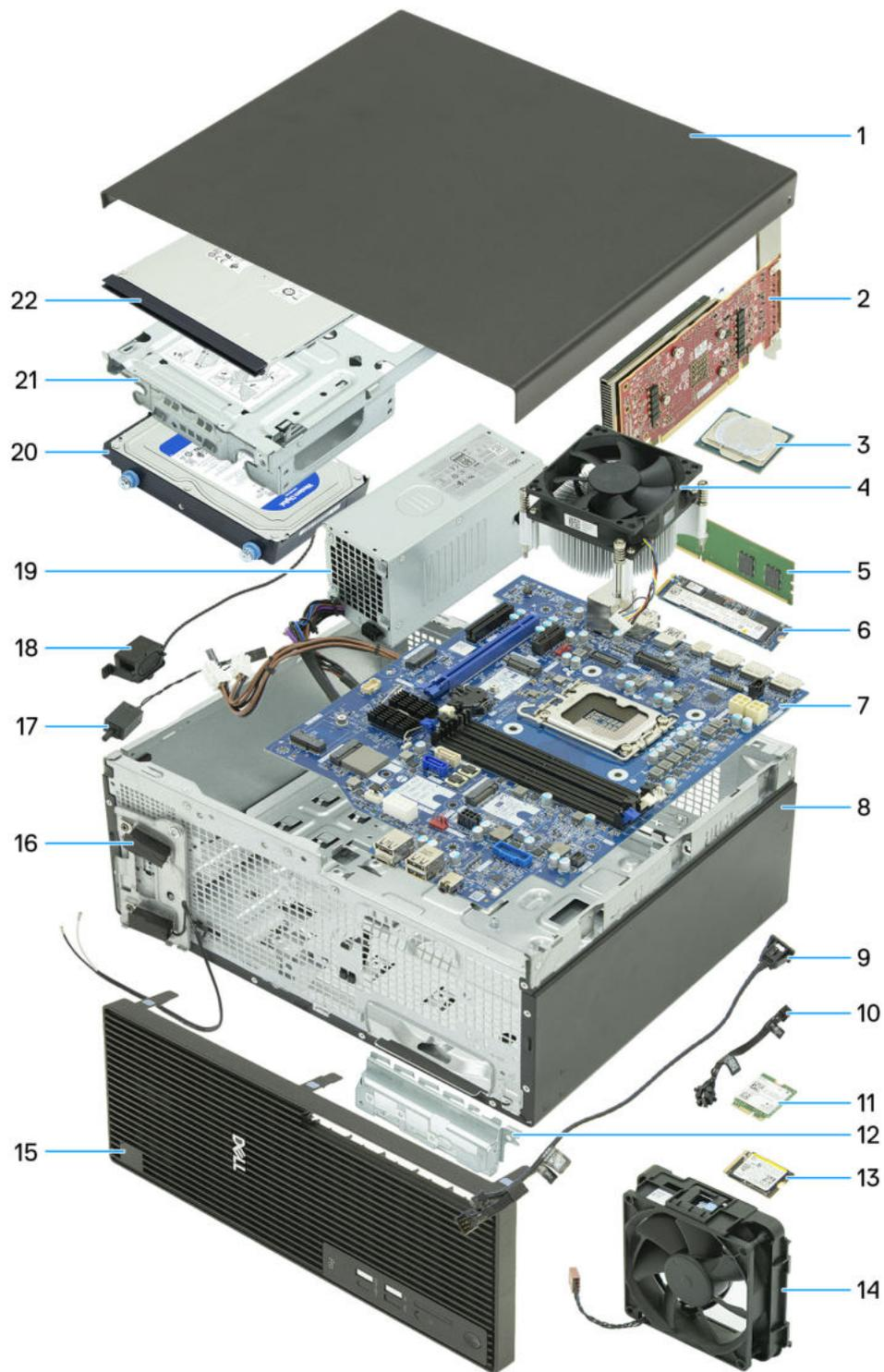
**Abbildung 9. Hauptkomponenten des Dell Pro Tower Plus GBT1250**
