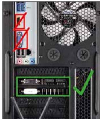
Bei verbauter Grafikkarte müssen deren Anschlüsse verwendet werden
