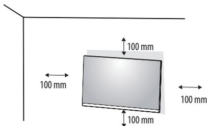
Um den Monitor an der Wand zu montieren, befestigen Sie die Wandhalterung (optional) an der Rückseite des Monitors.
