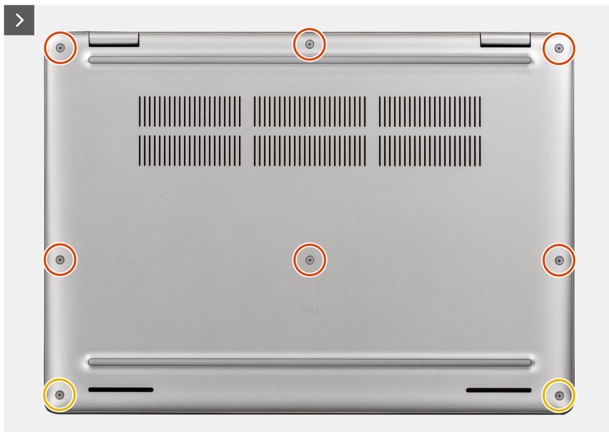
Abbildung 22. Entfernen der Bodenabdeckung
