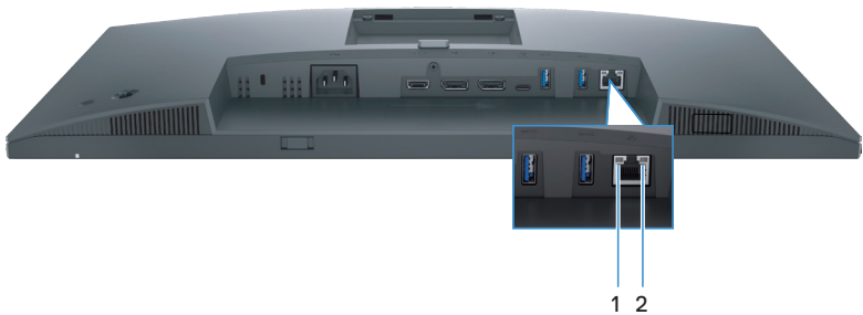
Afbeelding 10. RJ45 connector LED status
