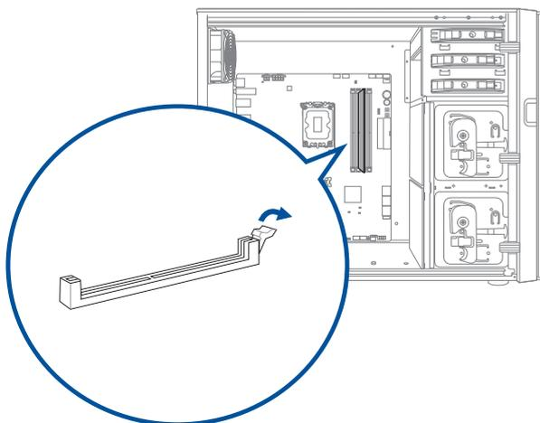
7. Richten Sie die Einkerbung am unteren Rand des DIMMs an der Nase im DIMM-Steckplatz aus, und stecken Sie dann das DIMM fest in den Steckplatz ein, bis der Auswerfer wieder einrastet.
