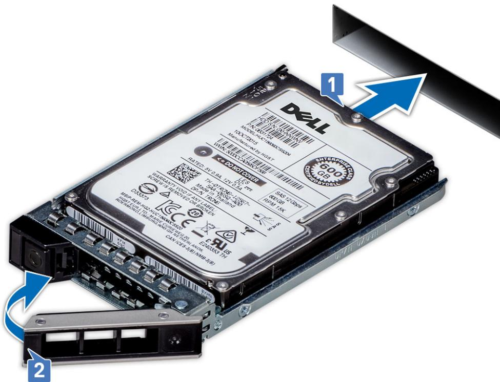
**ANMERKUNG:** Stellen Sie sicher, dass sich die Sperrklinke [2] in der geöffneten Position befindet, wenn Sie die Festplatte wieder im Steckplatz einsetzen.
