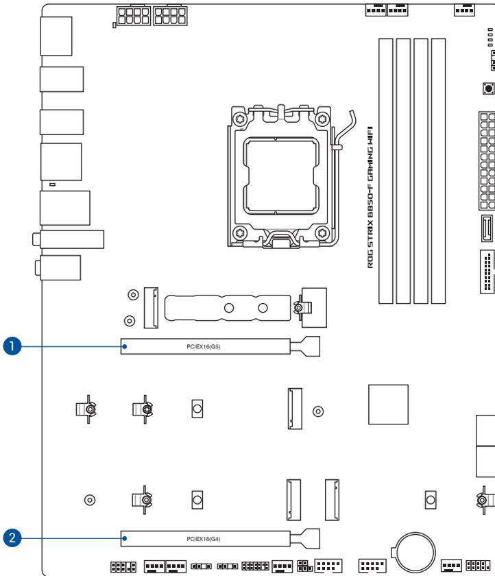
**REMARQUE :** le slot M.2\_3 partage la bande passante avec PCIe16(G4). Lorsque le slot PCIe16(G4) est occupé, M.2\_3 est désactivé.
