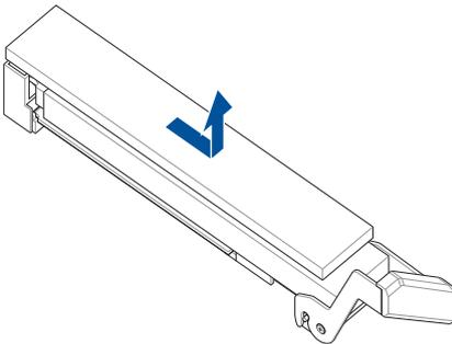
3. Desserrez les vis des autres dissipateurs thermiques M.2.
