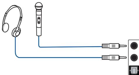
**REMARQUE :** Le port de sortie audio du panneau arrière ne prend pas en charge l'audio spatialisé. Si vous souhaitez utiliser l'audio spatialisé, connectez votre périphérique de sortie audio à la prise audio sur le panneau avant de votre châssis ou à un périphérique audio USB.
