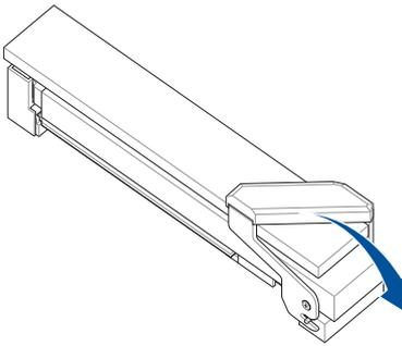
2. Tirez légèrement le dissipateur thermique vers l'extérieur, puis soulevez et retirez le dissipateur.
