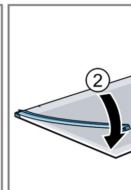
3. Die Zwischenscheibe mit Abstandshalter und Dichtungen in Pfeilrichtung einsetzen ①.
