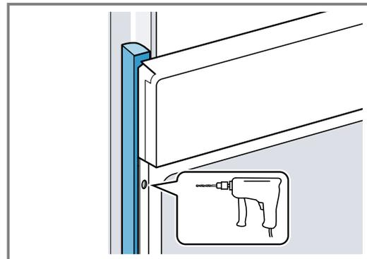
4. Das Gerät mit adäquater Schraube befestigen.
