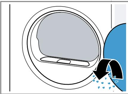
3. Das zweiteilige Flusensieb entfernen.
