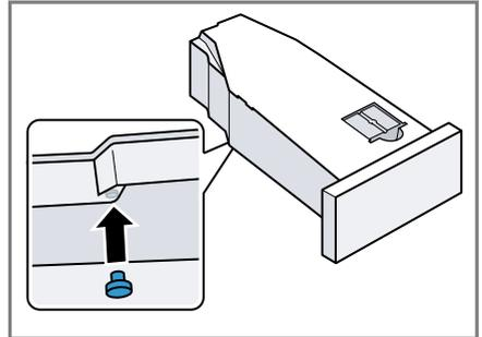
3. Den Filter im Kondenswasserbehälter reinigen.
