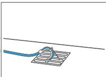
Den Wasserablaufschlauch komplett durch den Krümmer → Seite 12 schieben und mit dem Befestigungsmaterial fixieren. Den Krümmer am Gully befestigen.
