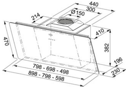
Technisch klares Design und das große, aufklappbare Glaspaneel in schwarz oder weiß zeichnen die Optik der Schräghaube Smart aus. Mit 3 Stufen + Intensivstufe hat die design- und leistungsstarke Schräghaube eine Lüfterleistung von 712 m<sup>3</sup>/h.
